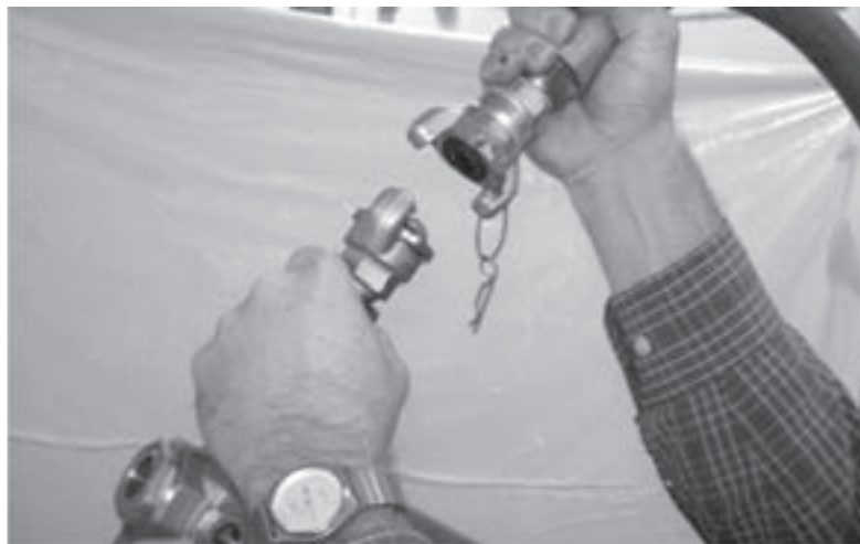
Abbildungen 2-4. Trennen Sie die pneumatische Energie, indem Sie die Druckluftleitung vom Druckluftantrieb entfernen.
