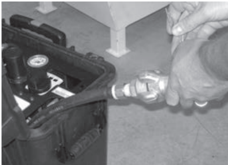
Abbildungen 5-40. Schließen Sie die Leitung von der Druckluftversorgung an dem Eingangsanschluss des ACM an.
