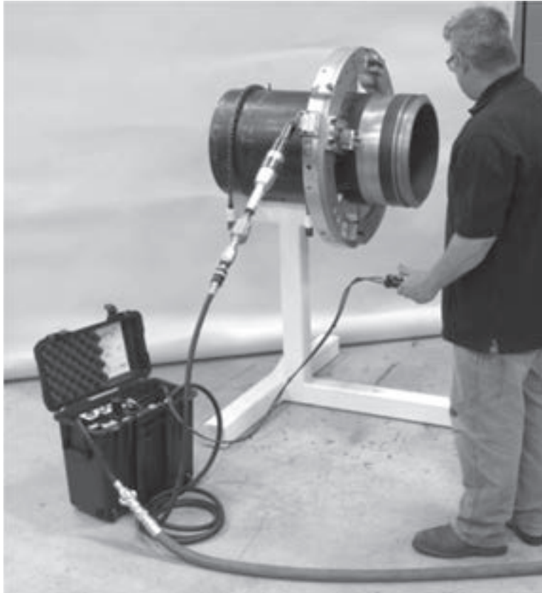
Abbildungen 5-38. Stellen Sie das ACM in einem geeigneten Abstand von der Split Frame Maschine auf.
