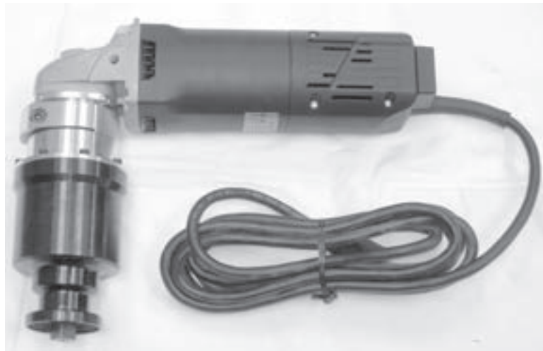
Abbildungen 3-13. Der Elektromotor (110 V: 80-4005-01; 220 V: 80-4006-01) kann zum Antrieb jedes SDSF-Modells eingesetzt werden.
