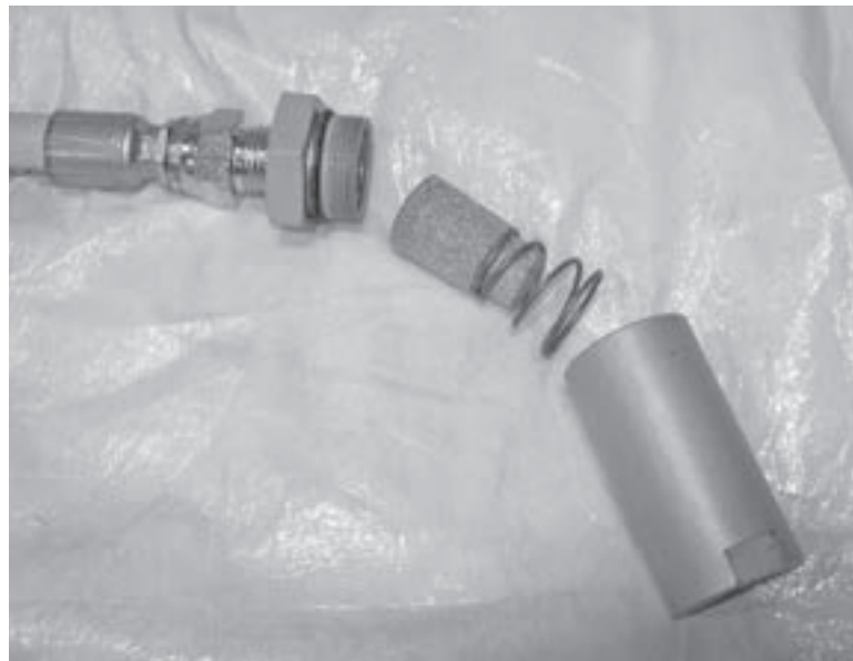
Abbildungen 6-4. Prüfen Sie den Luftfilter wöchentlich. Tauschen Sie diesen wie erforderlich aus.
