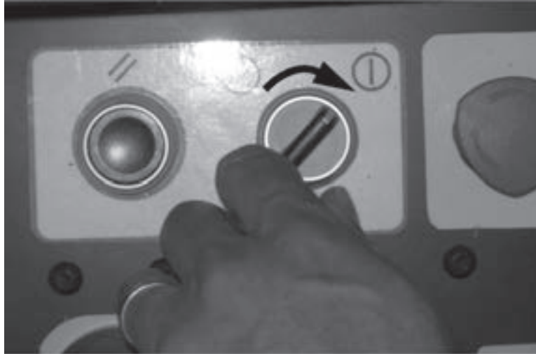
Abbildungen 5-46. Schalten Sie den fernbedienten Aktivierungsschalter ein, um den Betrieb mit der Handsteuerung zu ermöglichen.
