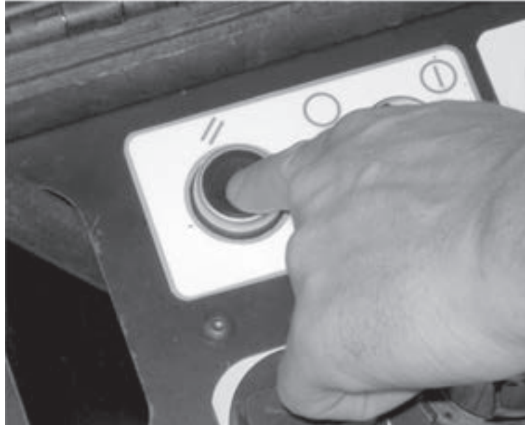
Abbildungen 5-45. Die Reset-Taste setzt das ACM nach einem Druckverlust oder einer Notausschaltung wieder zurück.
