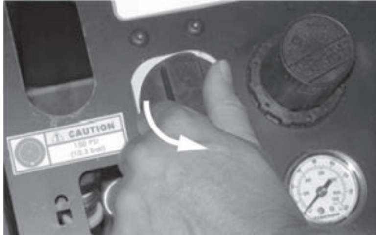
Abbildungen 5-44. Drehen Sie das EIN-/AUS-Ventil gegen den Uhrzeigersinn auf die Position EIN (dargestellt auf der Position AUS).
