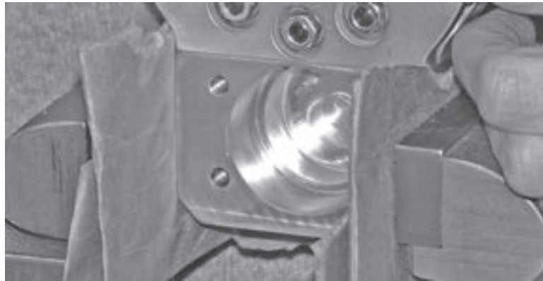
Abbildungen 6-6. Die Verwendung eines Schraubstocks mit weichen Backen verhindert eine Beschädigung des Ritzelgehäuses der SDSF.
