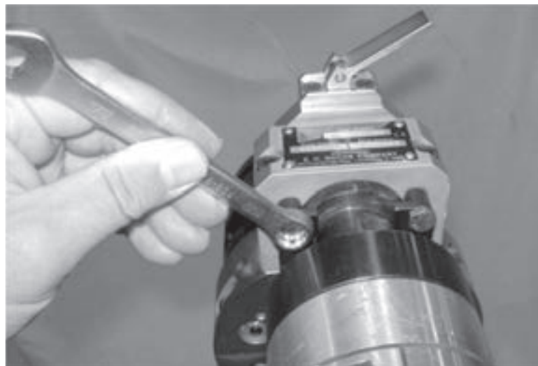
Abbildungen 5-25. Drehen Sie die Spanner zurück in ihre Position über dem Flansch und ziehen Sie die Spannschrauben mit einem 7/16-Zoll-Ringmaulschlüssel an.
