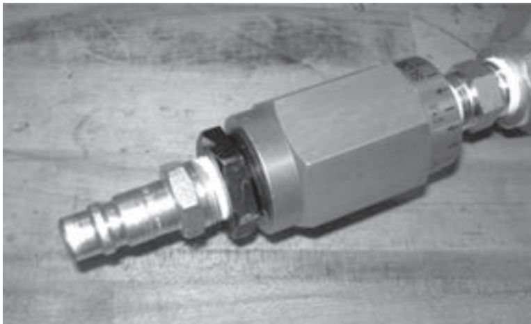
Abbildungen 5-53. Montieren Sie den mitgelieferten Nippel am Druckluftmotor zur Verwendung mit dem ACM.
