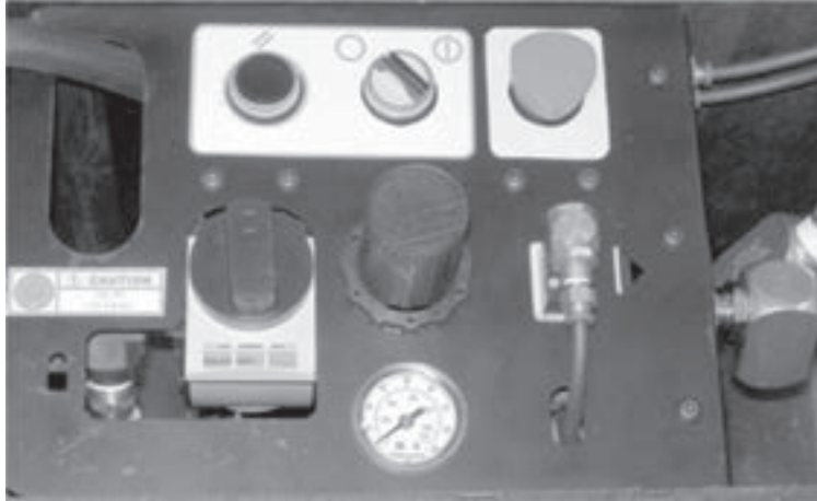
Abbildungen 5-39. dargestellt wird. Die ACM-Steuerungen sollten sich wie dargestellt in dem Zustand vor Betrieb befinden, bevor die Druckluftleitungen angeschlossen werden.
