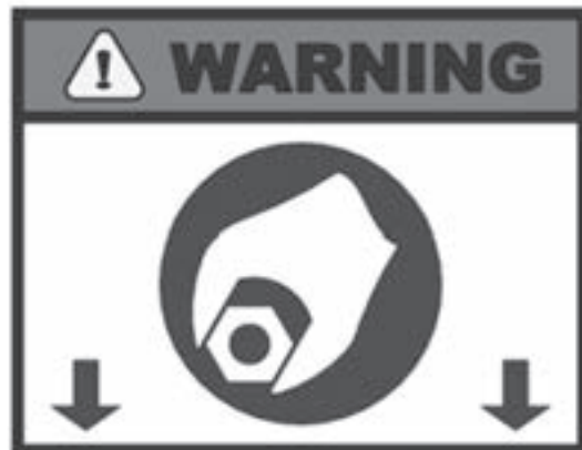
Abbildungen 2-5. Dieser Aufkleber befindet sich auf dem Antriebsgehäuse. Die Motorspanner müssen gesichert sein, um die SDSF sicher betreiben zu können.
