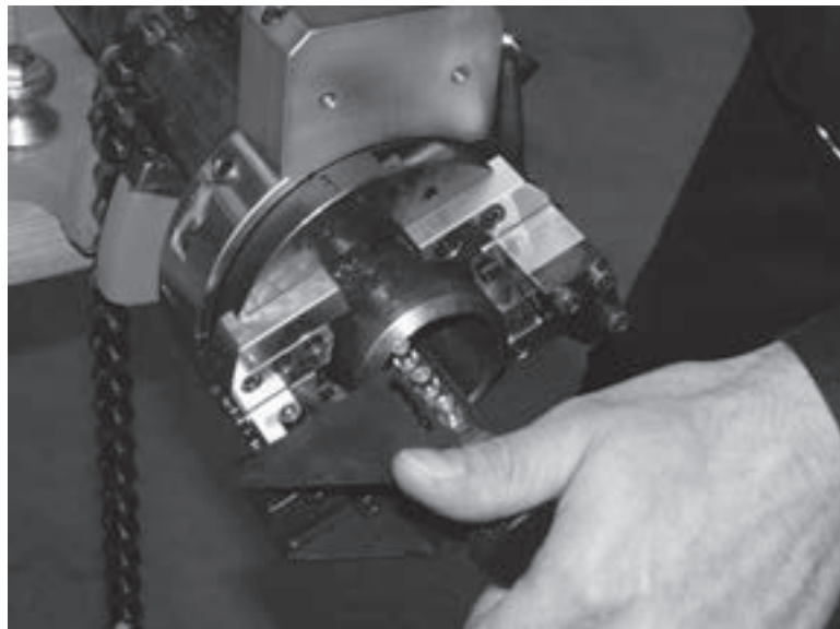
Abbildungen 5-30. Lassen Sie die Maschine laufen, bis die gewünschte Innenbearbeitung erreicht ist.
