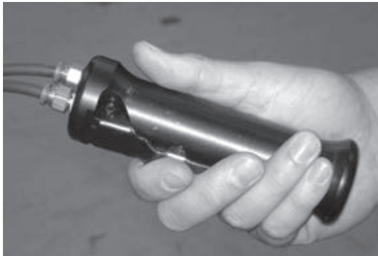
Abbildungen 5-47. Drücken Sie den Bügel an der Handsteuerung, um die Maschine zu betreiben.
