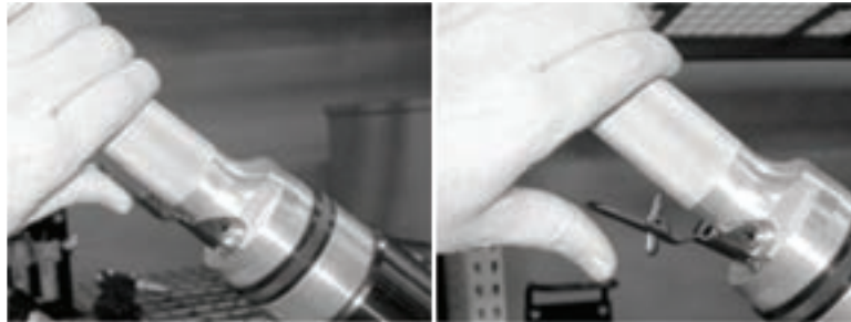
Abbildungen 2-2. Halten Sie den Druckluftmotorauslöser, um die SDSF (links) zu betreiben. Bei Loslassen des Auslösers (rechts) schaltet sich der Druckluftmotor aus.
