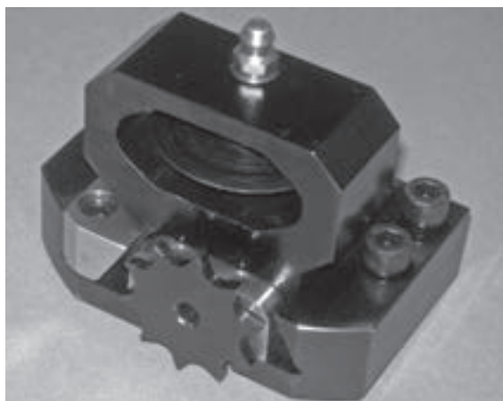
Abbildungen 3-11. Dieses Foto zeigt den für die SDSF verfügbaren FME-Schlitten (Foreign Material Exclusion). Der FME-Schlitten wird zum spanlosen Trennschneiden bei dünnwandigen und hochreinen Anwendungen verwendet.
