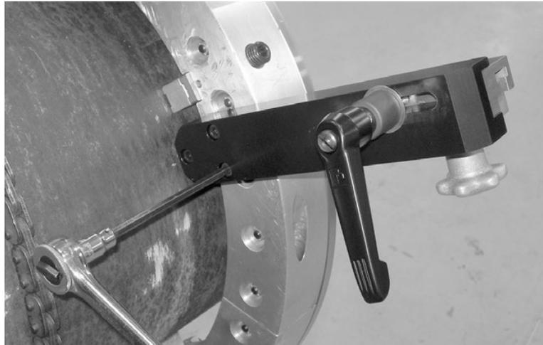
*Figura 3-6. Montare l'innesco sull'LCSF con le 3 viti fornite.*
