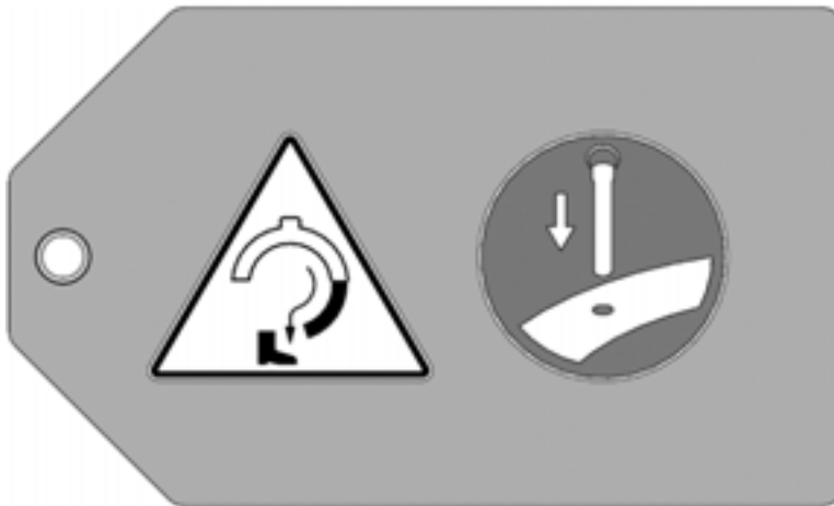
Abb. 2-15. Der Anhänger mit dem Ausrichtungsstift ist am Ring des Ausrichtungsringes befestigt. Stellen Sie sicher, die Stifte vor dem Trennen der Maschine einzuführen. (Artikelnummer 60-1274-00.)
