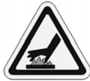
Abb. 2-12. Der Aufkleber „Heiße Oberfläche“ ist am Antriebsmotor (pneumatisch oder hydraulisch) der DynaPrep MDSF befestigt. Antriebskomponenten können heiß genug werden, um Verbrennungen zu verursachen. Stellen Sie sicher, dass diese nicht heiß sind, bevor Sie sie berühren. (Artikelnummer 90-403-00.)
