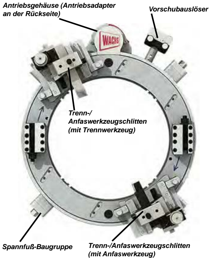
Abb. 3-1. Die Abbildung stellt die Standardkomponenten der DynaPrep MDSF dar. (Dargestellt ist Modell 612.)
