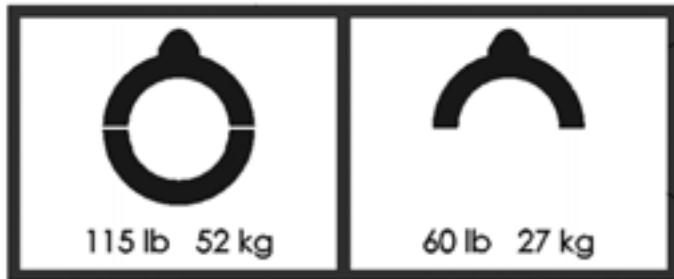
Abb. 2-13. Die Gewichtsaufkleber der DynaPrep MDSF sind am Ritzelgehäuse befestigt. Die Gewichte und Artikel-Nr. variieren je nach Modell. (Artikelnummer 69-0134-XX.)
