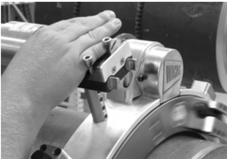
Abb. 5-5. Drücken Sie den Auslösestift nach vorn, um die Auslöser zu aktivieren.
