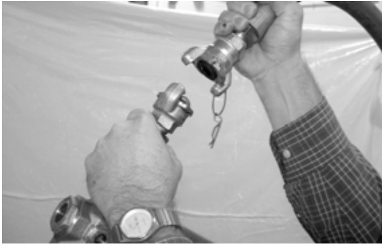
Abb. 2-5. Trennen Sie die pneumatische Energie, indem Sie die Druckluftleitung vom Druckluftantrieb entfernen.
