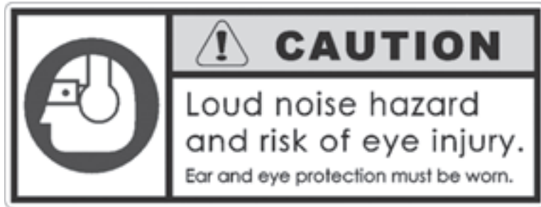
Figure 2-14. L'étiquette de protection oculaire et auditive est apposée sur le moteur de commande de la machine. Portez toujours une protection oculaire et auditive lorsque vous utilisez le matériel. (Référence 90-401-03.)
