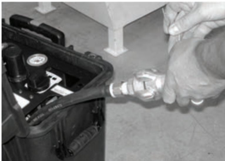
Figure 5-76. Raccordez le tuyau provenant de la source d'air comprimé au raccord d'entrée du module ACM.
