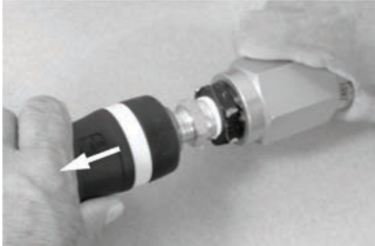
Figure 5-87. Pour libérer le raccord rapide, tirez la bague vers l'arrière. Le raccord rapide est alors libéré. (Cela libère l'air dans la canalisation pneumatique).
