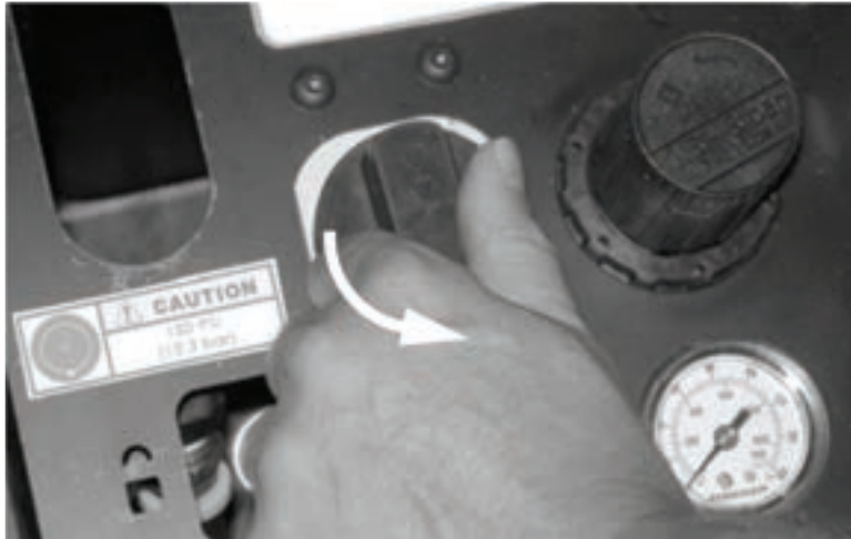
Figure 5-80. Tournez la vanne de coupure (ON/OFF) dans le sens contraire des aiguilles d'une montre en position ON (représentée en position ON).
