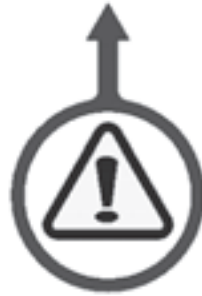
Figure 2-21. L'étiquette de l'emplacement des pieds de centrage est apposée pour indiquer les trous d'alignement. La machine LCSF comporte deux étiquettes, une pour chaque emplacement. (Référence 60-1275-00.)
