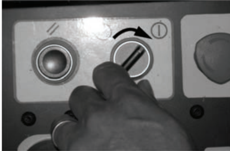
Figure 5-82. Tournez le bouton d'activation de la commande à distance (Remote Enable) pour pouvoir utiliser la machine à distance.
