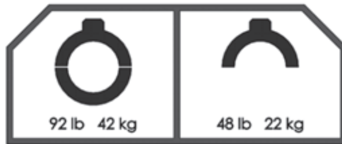
Figure 2-18. Les étiquettes de poids de la machine LCSF sont apposées sur le carter de transmission. Le poids et la référence varient en fonction du modèle LCSF. (Référence 60-1279-XX.)
