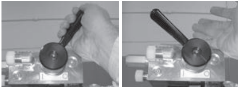
Figure 2-5. Appuyez sur le levier de commande hydraulique pour mettre en service la machine LCSF (à gauche). Lorsque vous relâchez ce levier (à droite), le moteur hydraulique s'arrête.
