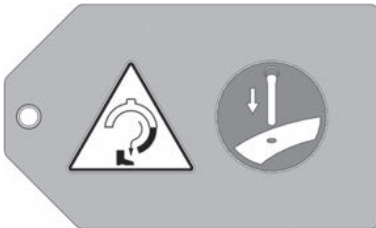
Figure 2-20. L'étiquette du pied de centrage est apposée sur le stator. N'oubliez pas d'introduire ces axes avant de séparer la machine. (Référence 60-1274-00.)
