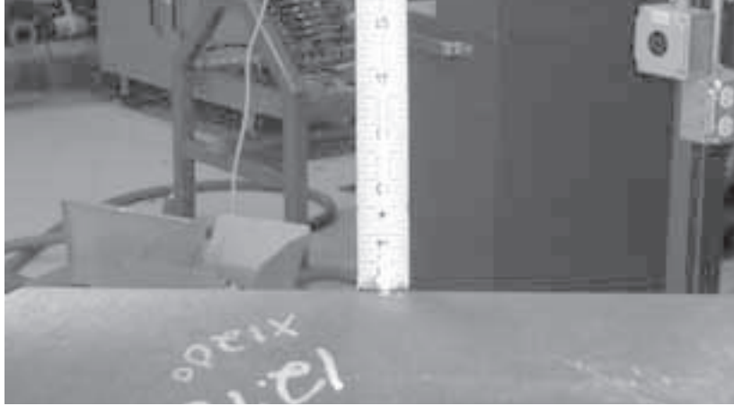
Figure 5-1. Mesurez l'espace radial libre autour du tuyau.
