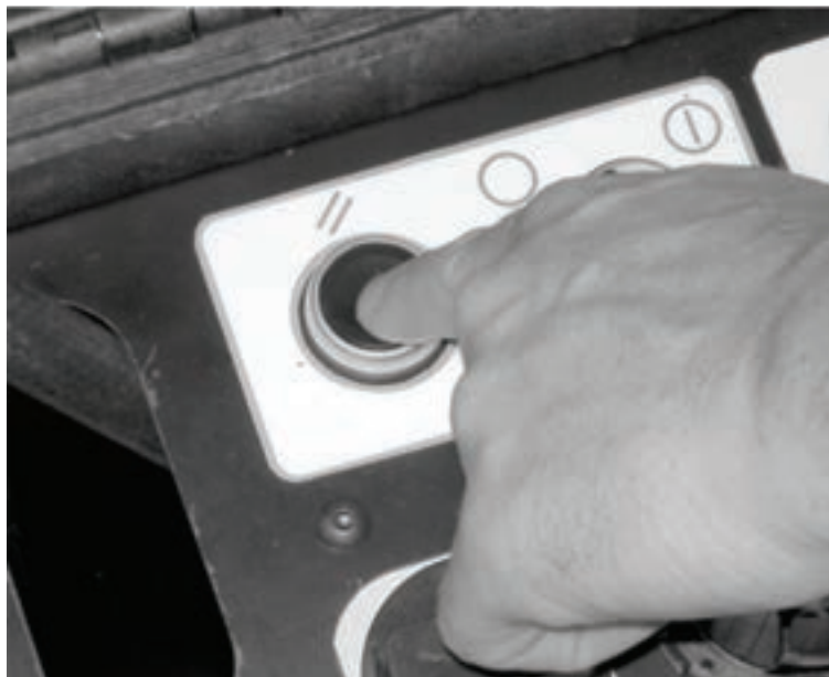
Figure 5-81. Le bouton Reset réinitialise le module ACM après une coupure de la pression ou un arrêt d'urgence.
