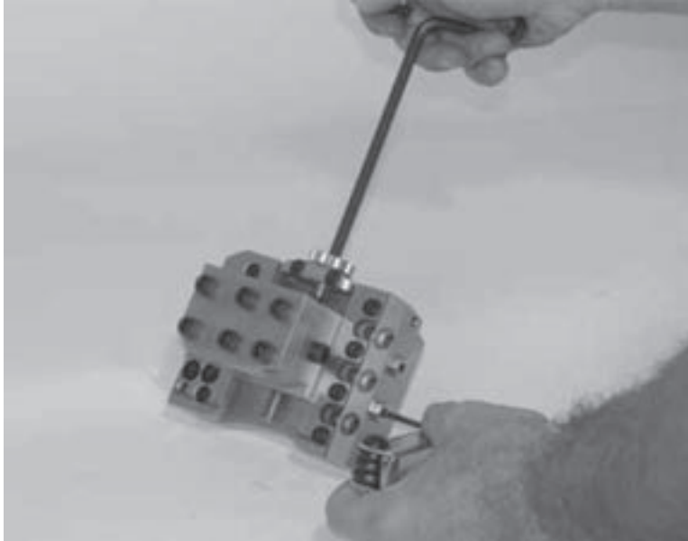
Figure 7-27. Serrez les vis de réglage en tournant la roue dentée.
