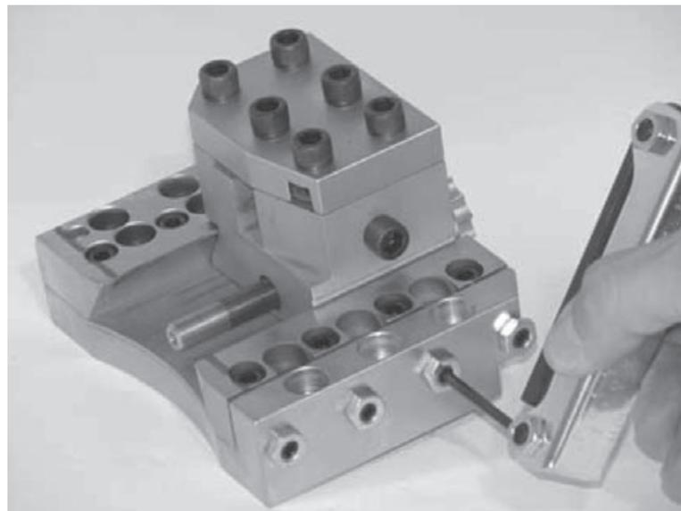
*Figura 7-14. Reinstallare le viti di fissaggio e serrarle.*
