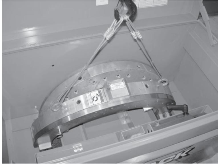
*Figura 5-9. Utilizzare un dispositivo di sollevamento per sollevare ogni metà della macchina dalla cassa.*
