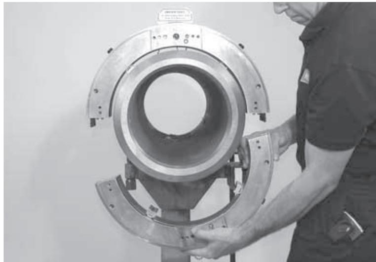
*Figura 5-19. Montare le due metà sul tubo.*
