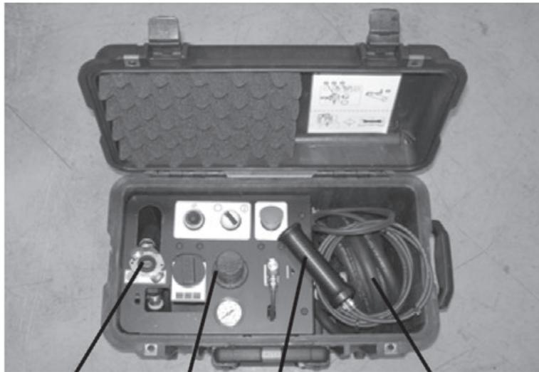
**Connettore di ingresso aria**    **Pannello di controllo**    **Telecomando**    **Tubo di uscita a telaio divisibile**
