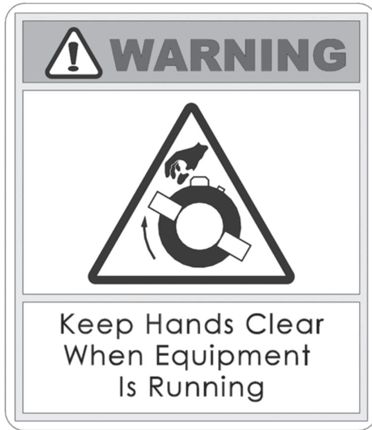
Figura 2-20. L'etichetta "Tenere le mani lontane" è affissa all'anello fisso dell'LCSF. Tenersi lontani dalle parti in movimento quando l'LCSF è in funzione. (Codice 60-363-00)
