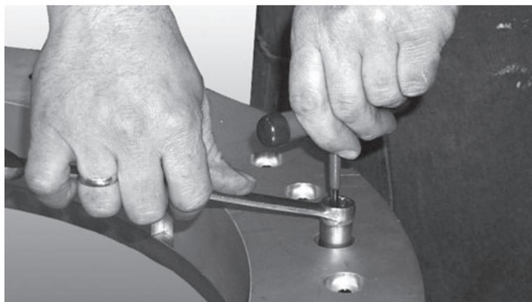
Figura 7-8. Girare l'albero in senso orario con la chiave esagonale, quindi serrare il dado nylock.
