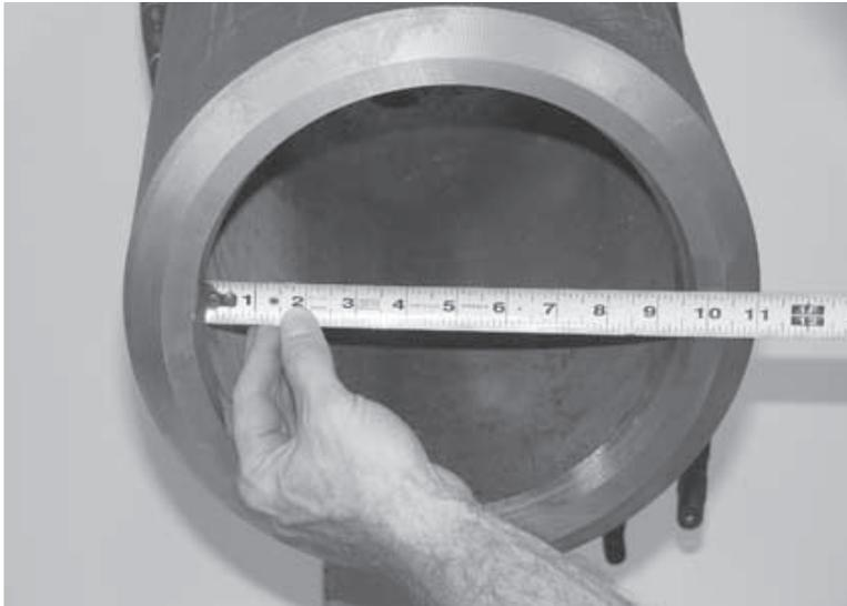
Figura 5-58. Misurare il diametro interno del tubo.
