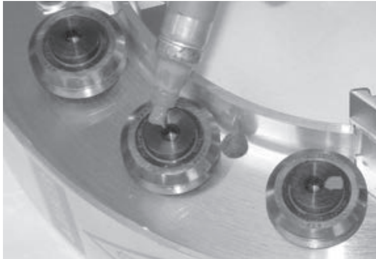
Abbildungen 7-13. Markieren Sie die Kante jedes Lagers.
