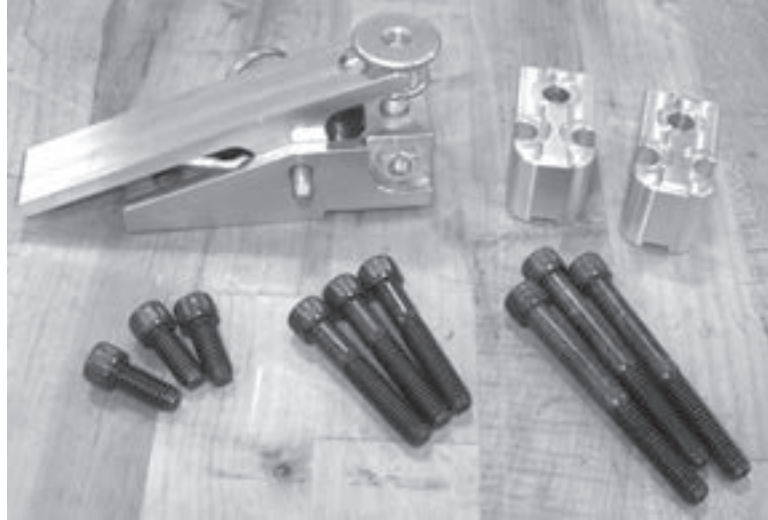
Abbildungen 5-39. Der Vorschubauslöser ist mit 2 Verlängerungsblöcken und 3 Schraubengrößen für die 3 Konfigurationen ausgestattet (kein Block, 1 Block oder 2 Blöcke).
