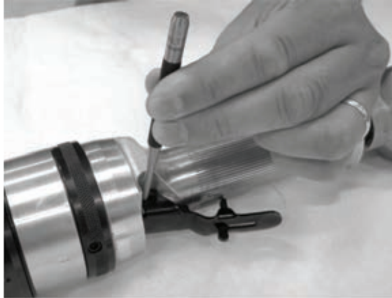
Abbildungen 5-90. Verwenden Sie einen Dorn, um den Stift herauszutreiben, mit dem der Druckluftauslöser befestigt ist.
