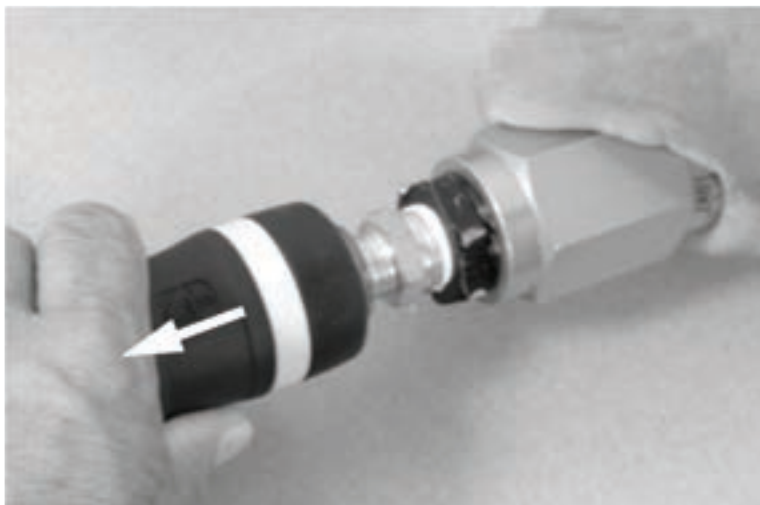
Abbildungen 5-87. Zur Lösung der Schnellkupplung ziehen Sie die Manschette zurück. Die Schnellkupplung schnappt zurück in ihre Freigabeposition. (Dadurch wird die Druckluftleitung entlüftet.)
