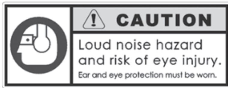
Abbildungen 2-14. Der Aufkleber bezüglich des Gehör- und Augenschutzes ist am Antriebsmotor der LCSF befestigt. Tragen Sie beim Betrieb dieser Geräte immer einen Gehör- und Augenschutz. (Artikelnummer 90-401-03.)
