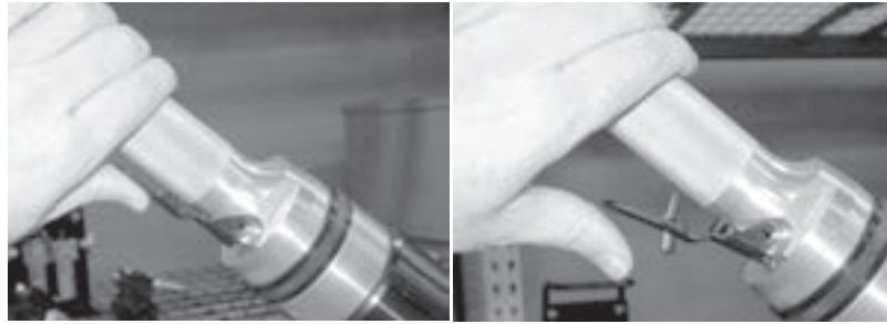
Abbildungen 2-4. Halten Sie den Druckluftmotorauslöser, um die LCSF (links) zu betreiben. Bei Loslassen des Auslösers (rechts) schaltet sich der Druckluftmotor aus.
