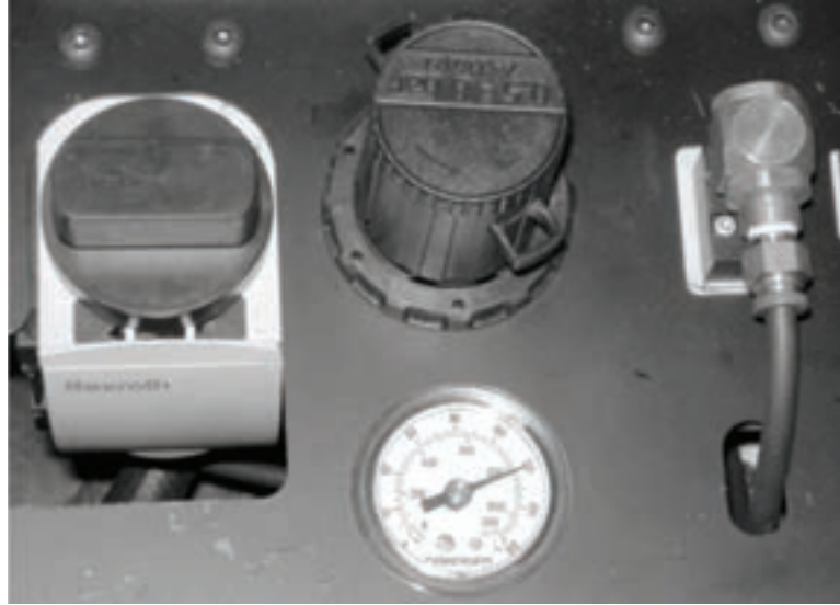
Abbildungen 5-85. Sie können den Druckknopf drehen, ohne daran zu ziehen, um die Verriegelungslaschen freizulegen. Führen Sie in Schloss durch die Laschen, um eine Einstellung des Drucks zu verhindern.
