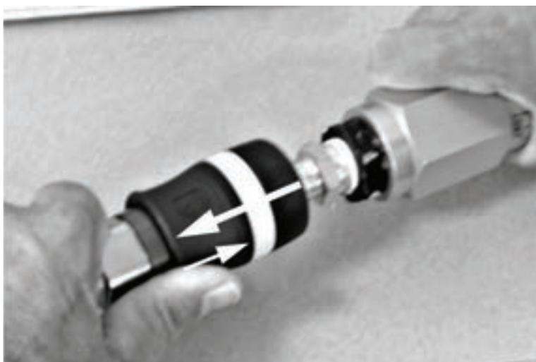
Abbildungen 5-88. Drücken Sie die Manschette nach vorne und ziehen Sie die Schnellkupplung aus der Armatur.
