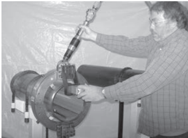
Abbildungen 2-9. Wenn Sie Zubehörteile verwenden, deren Steuerungen Sie bedienen müssen (dargestellt mit dem universellen Innenbearbeitungs-Werkzeugschlitten), nehmen Sie eine Position ein, in der Sie die Maschine bedienen können, ohne in Kontakt mit beweglichen Teilen zu kommen.
