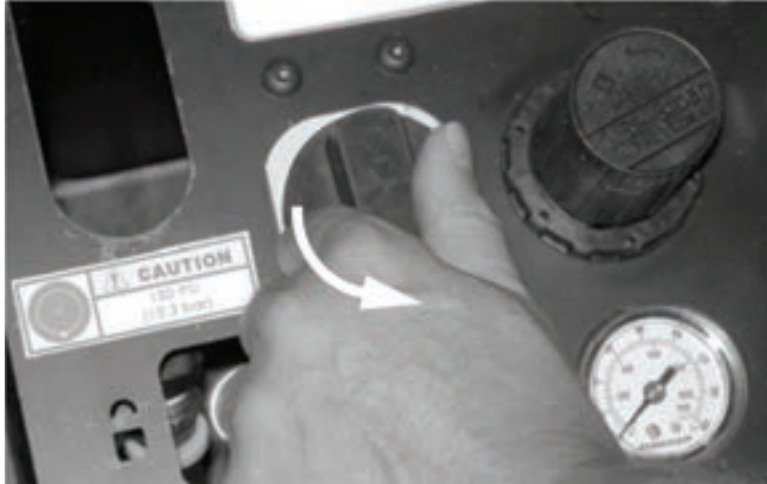
Abbildungen 5-80. Drehen Sie das EIN-/AUS-Ventil gegen den Uhrzeigersinn auf die Position EIN (dargestellt auf der Position AUS).
