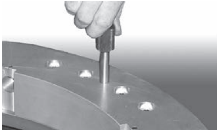
Abbildungen 7-18. Führen Sie Ausrichtungsstifte ein, um eine Drehung des Drehrings zu verhindern.
