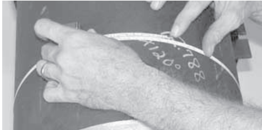
Abbildungen 5-3. Überprüfen Sie den Rohrumfang durch Nachmessen.
