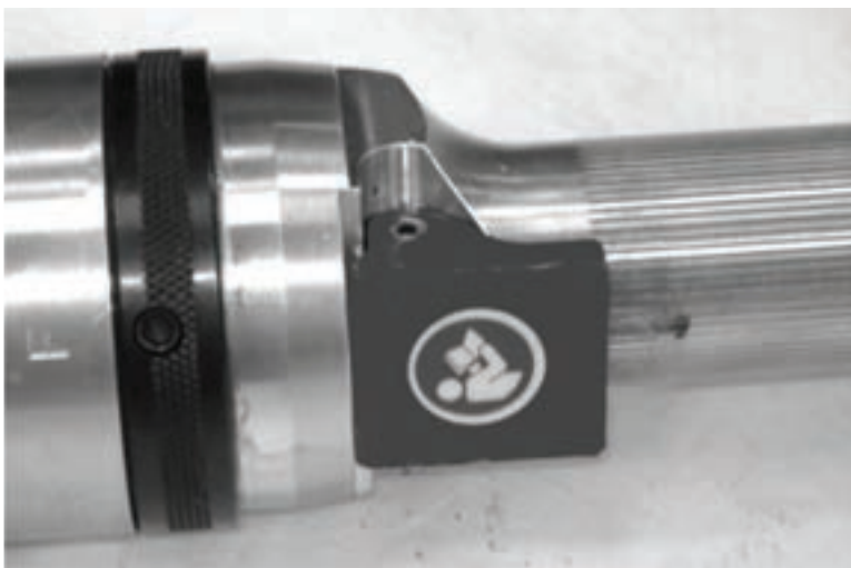
Abbildungen 5-93. Das Foto zeigt die korrekte Installation der offenen Drosselplatte.
