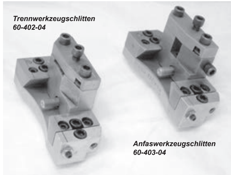
Abbildungen 3-4. Das Foto zeigt die Low Clearance Werkzeugschlitten, die für Anwendungen mit begrenztem Radialspiel um das Werkstück zur Verfügung stehen. Der Arbeitshub (Werkzeugschlittenhub) beträgt 17 mm (0,67 Zoll).
