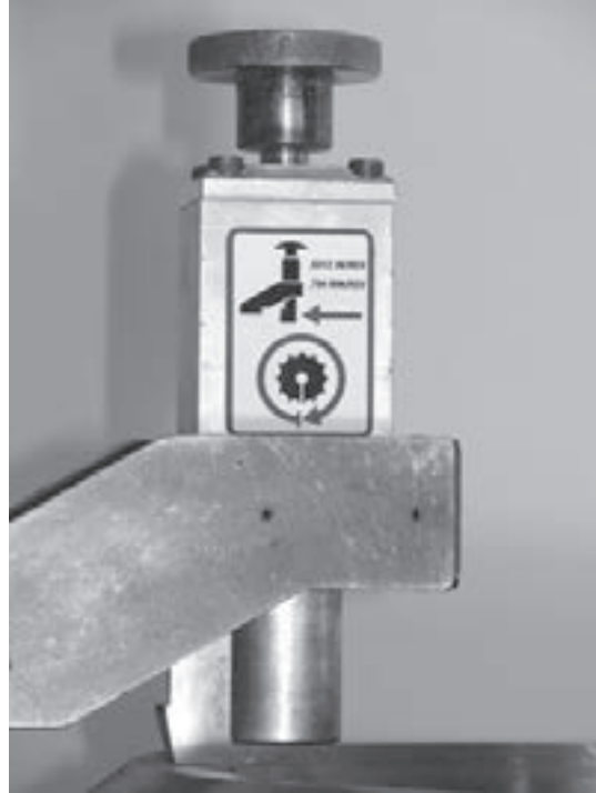
Abbildungen 5-69. Axiale (0,0312) und radiale (0,0784) Einstellung pro Umdrehung.
