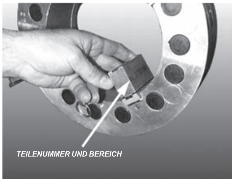
Abbildungen 5-14. Montieren Sie die Spannfüße an den Spannbacken.
