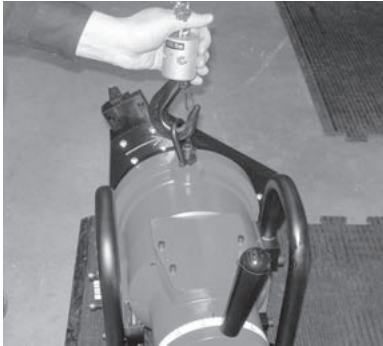
Figura 5-42. Sujete el dispositivo de elevación al cáncamo de elevación.
