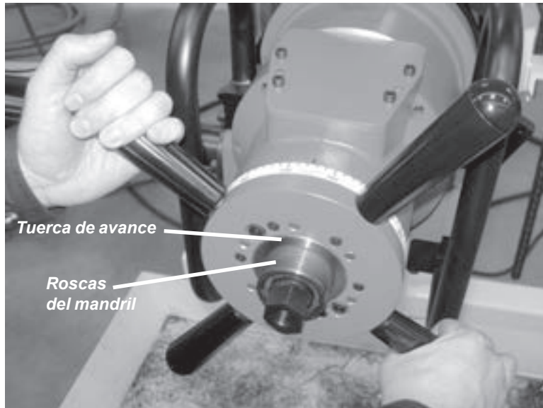
Figura 5-45. Gire la manivela de avance en el sentido del reloj para enhilar las roscas del mandril en la tuerca de avance.
