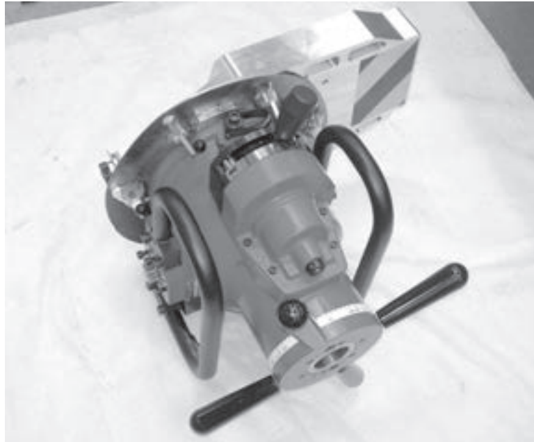
Figura 3-2. La fotografía muestra la configuración de punta única de la EP 424.
