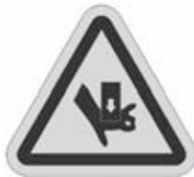
Figura 2-2. Etiqueta de riesgo de seguridad por aplastamiento y corte (número de pieza 90-401-04).
