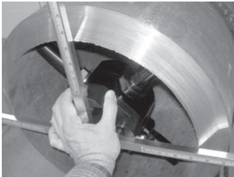
Figura 5-16. Empuje el cuerpo del plato hacia el tubo hasta que todos los cuatro brazos del medidor de alineación estén contra la superficie del tubo.
