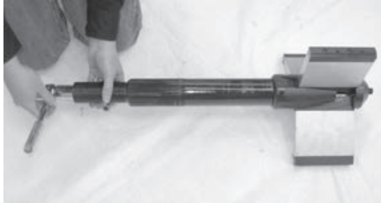
Figura 5-4. Gire la tuerca de la barra de tracción en sentido contrarreloj para retraer las patas de fijación.
