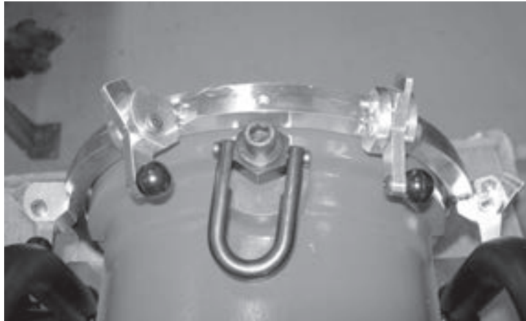
Figura 3-4. La foto muestra el ensamble de desenganche montado en la caja de accionamiento principal.
