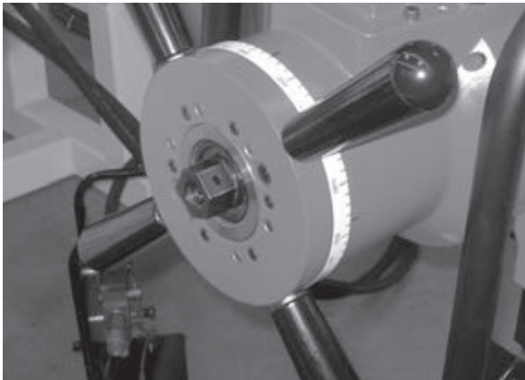
Figura 5-46. Enhile las roscas del mandril totalmente en la tuerca de avance para una operación estabilizada.
