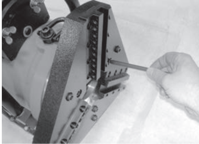
Figura 5-77. Apriete los 6 tornillos que sujetan la cabeza giratoria.
