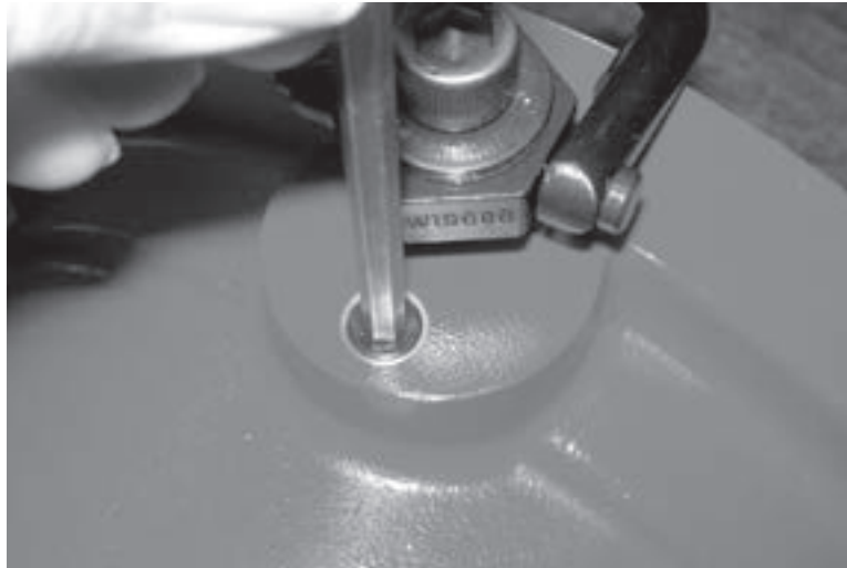
Figura 6-2. Quite el tapón de engrase antes de poner grasa en el ensamblaje de accionamiento principal.
