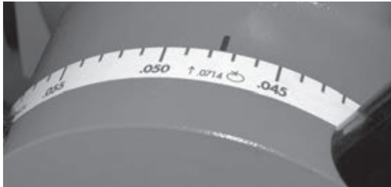
Figura 5-49. Use la escala en la carcasa de avance para medir la distancia de avance axial.
