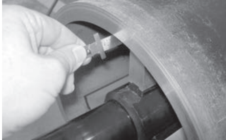
Figura 5-7. Mida la distancia entre el extremo del tubo y las patas de fijación para asegurarse de que haya suficiente espacio libre para realizar la operación.
