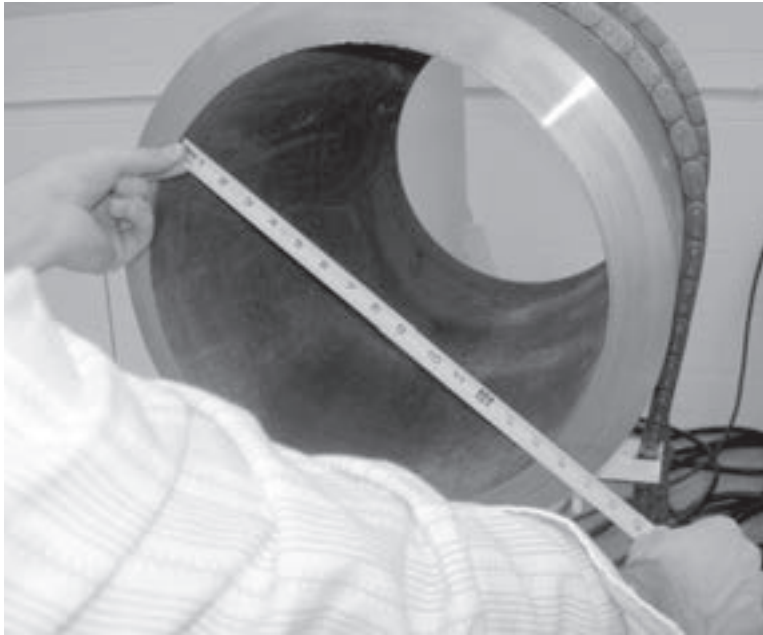
Figura 5-1. Mida el diámetro interno del tubo para determinar el juego de patas que será requerido.
