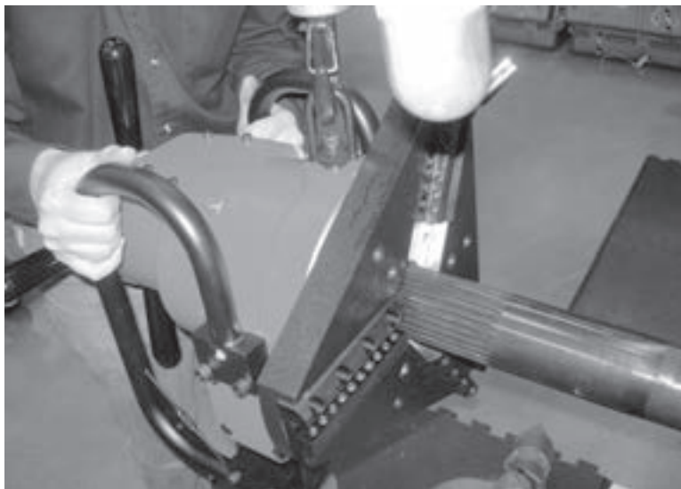
Figura 5-43. Coloque la máquina en posición para montarla en el mandril.
