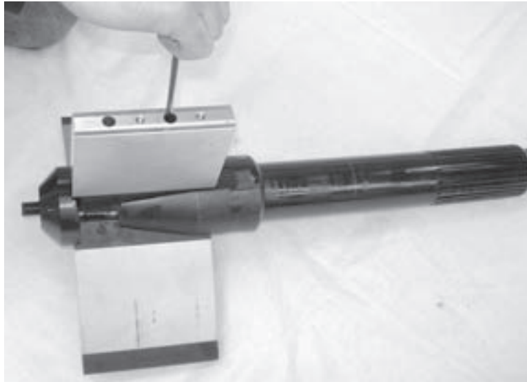
Figura 5-2. Atornille los tornillos cautivos en el mandril para fijar las patas.
