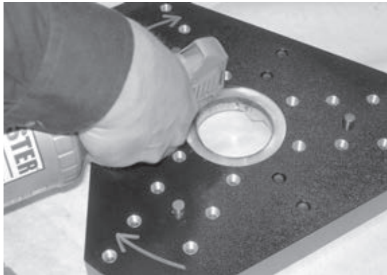
Figura 6-4. Aplique aceite al limpiador de fieltro en la cabeza giratoria.
