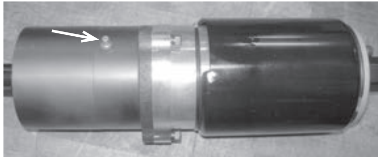
Figura 6-8. Engrase el motor neumático una vez al mes.
