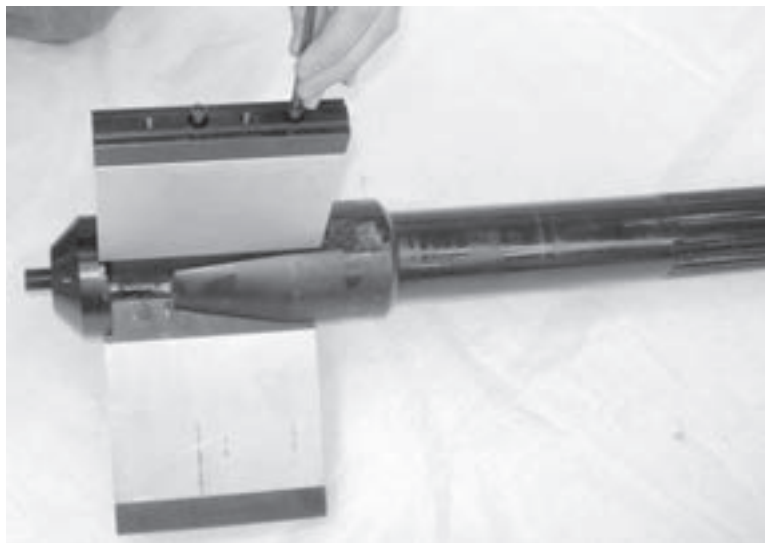
Figura 5-3. Instale las patas de extensión de acero (#1 o #2) encima cuando vaya a instalar varias patas.
