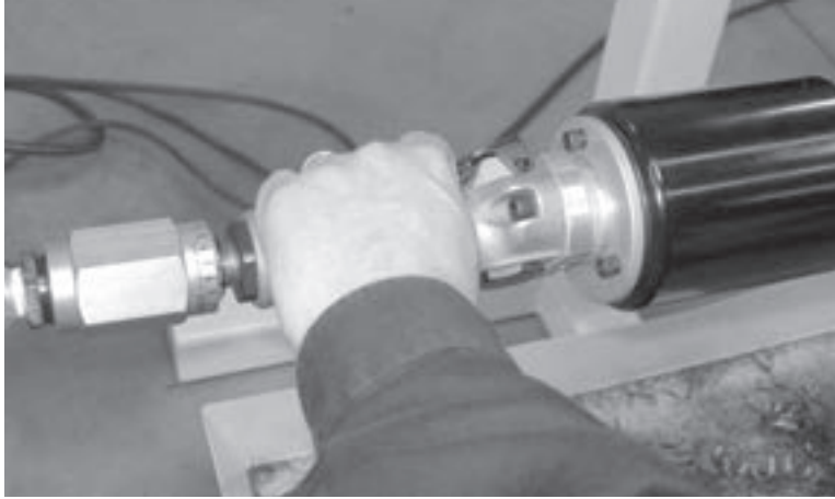
Figura 5-29. Apriete el gatillo del motor neumático para arrancar la máquina.
