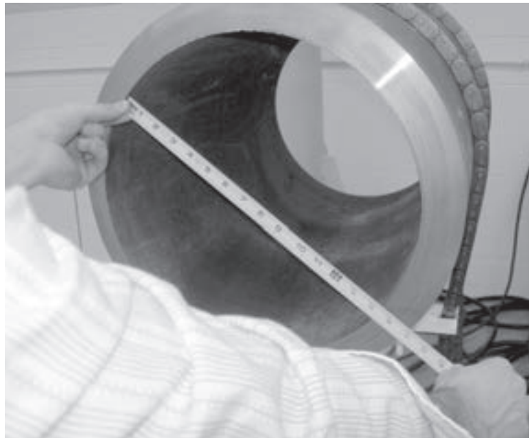
Figura 5-8. Mida el diámetro interno del tubo para determinar el juego de patas que será requerido.
