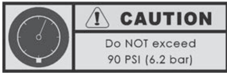
Figura 2-5. Etiqueta de seguridad de presión neumática (número de pieza 90-401-02).
