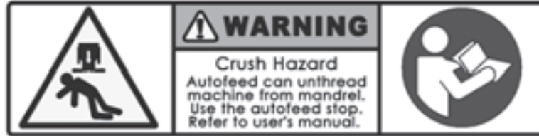
Figura 2-1. Etiqueta de riesgo de seguridad por aplastamiento (número de pieza 81-165-00).
