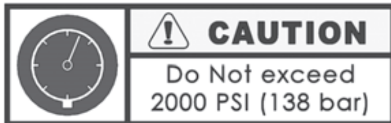
Figura 2-6. Etiqueta de seguridad de presión hidráulica (número de pieza 90-402-01).
