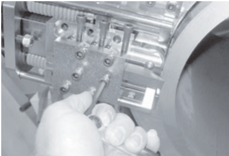
Figure 3-19. Serrez légèrement les vis de réglage supérieures pour maintenir l'outil à chanfreiner en place.
