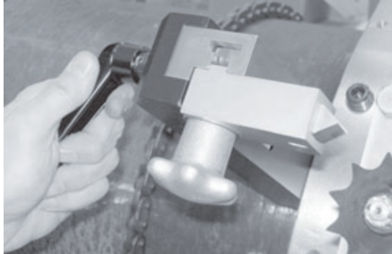
Figure 3-14. Engagez le déclencheur en serrant le levier de blocage du déclencheur et en poussant la barre du déclencheur vers la machine LCSF.
