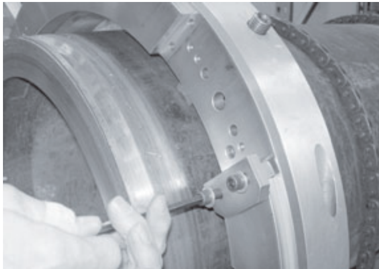
Figure 3-5. Montez les brides de fixation sur les rotors de la machine LCSF aux emplacements de fixation du plateau.
