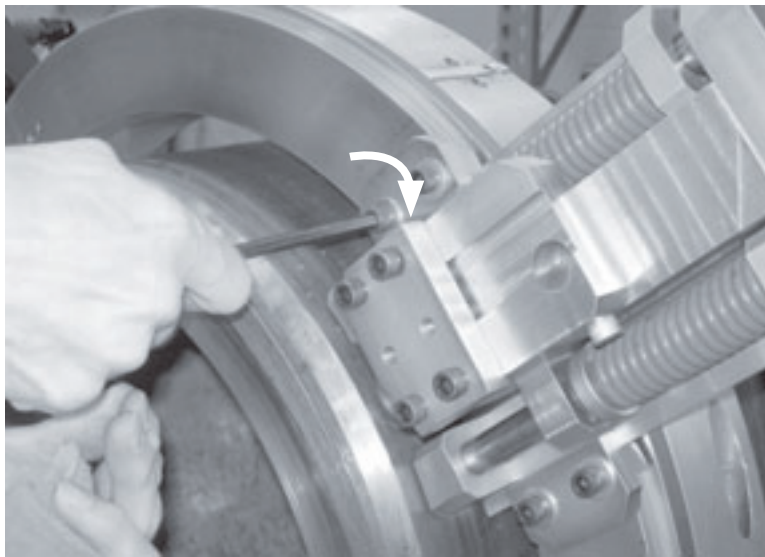
Figure 3-12. Lorsque les positions des plateaux sont réglées, serrez fermement les vis des brides de fixation.
