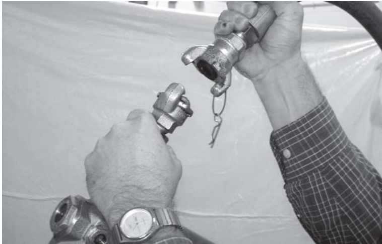
Rysunek 2-5. Odłączyć zasilanie pneumatyczne poprzez odłączenie przewodu pneumatycznego od napędu pneumatycznego.
