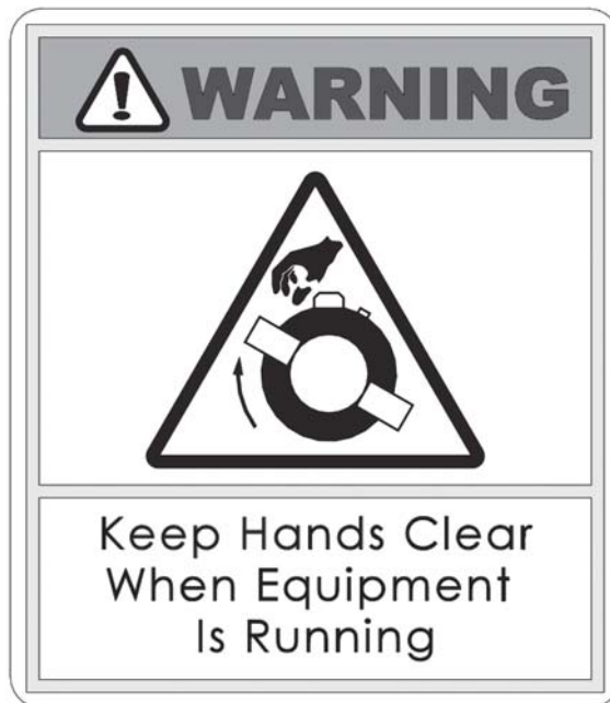
Rysunek 2-14. Naklejka „Keep Hands Clear” (Nie zbliżać rąk) jest umieszczona na stałym pierścieniu MDSF. Podczas pracy urządzenia nie zbliżać się do ruchomych części urządzenia. (Nr części 60-363-00).
