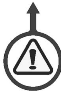
Rysunek 2-16. Naklejka umiejscowienia sworzni ustalających została dołączona w celu wskazania otworów na sworznie. Na MDSF znajdują się dwie etykiety, po jednej w każdej lokalizacji sworzni. (Nr części 60-1275-00).
