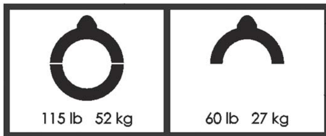
Rysunek 2-13. Naklejki informujące o masie sekcji MDSF są przymocowane do korpusu zębatki. Masy i numery części różnią się w zależności od modelu. (Nr części 69-0134-XX).
