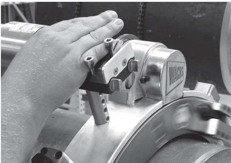
Rysunek 5-5. Popchnąć kołek podający do przodu, aby uruchomić mechanizm podający.
