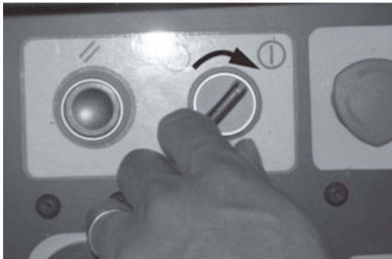
Figura 5-46. Gire el interruptor “Remote Enable” (habilitar control remoto) para activarlo para habilitar una operación usando el control de mano.
