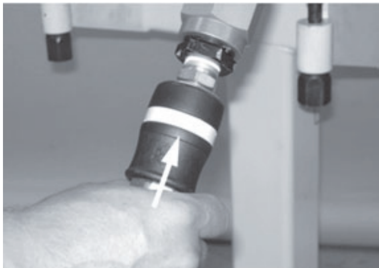
Figura 5-50. Empuje la desconexión de línea de aire en el conector de la unidad de accionamiento neumático hasta que se enclava en su lugar.
