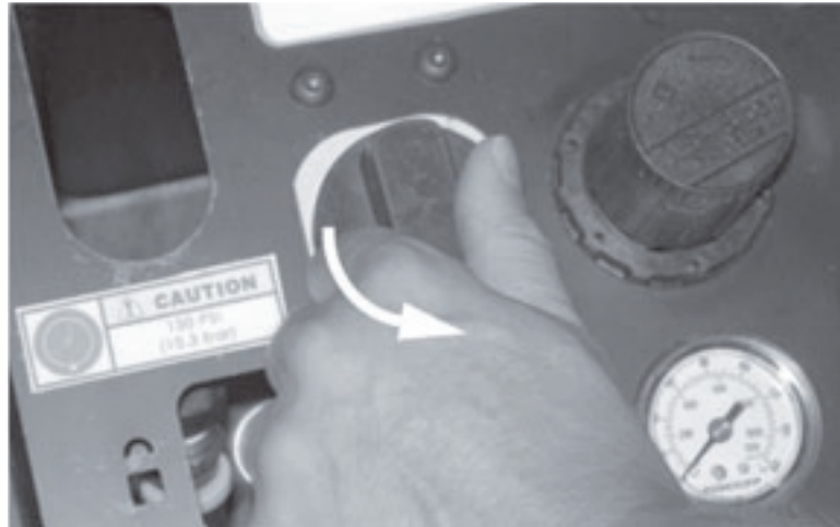
Figura 5-44. Gire la válvula de “ON/OFF” (encendido/apagado) en sentido contrarreloj a la posición “ON” (encendido). (Se muestra en posición “OFF” (apagado)).
