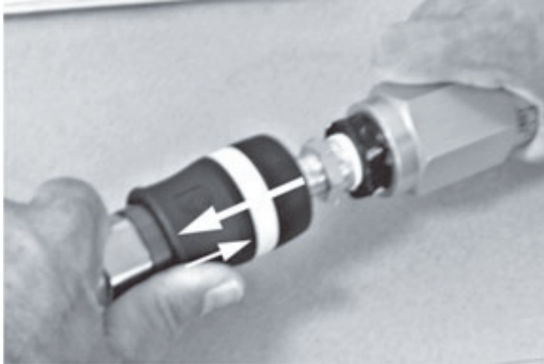
Figura 5-52. Empuje el collarín hacia adelante y jale la desconexión para quitarla del conector.
