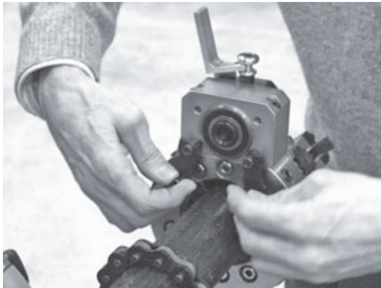
Figura 5-20. Mueva las abrazaderas hacia abajo para instalar el motor.
