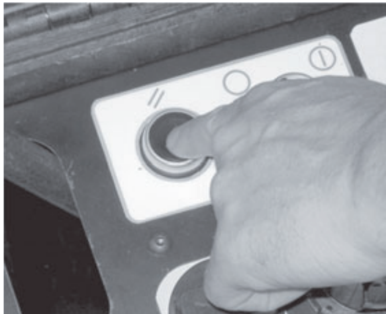
Figura 5-45. El botón “Reset” restablece el ACM después de una pérdida de presión o de una parada de emergencia.
