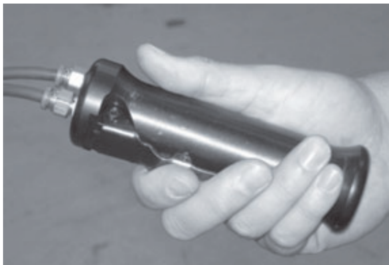
Figura 5-47. Apriete el disparador en el control de mano para operar la máquina.
