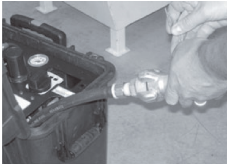
Figura 5-40. Conecte la línea de la alimentación de aire al conector de entrada en el ACM.
