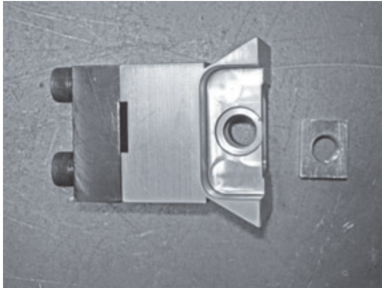
Figura 7-2. Reemplace la tuerca de avance usada en el portaherramientas.
