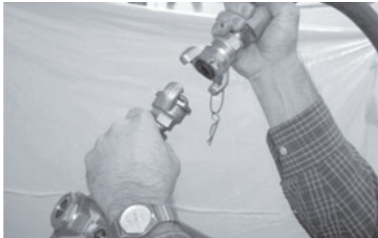
Figura 2-4. Desconecte la alimentación neumática quitando la línea de aire de la unidad de accionamiento neumático.
