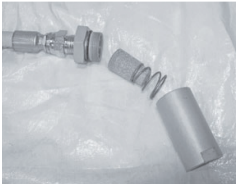
Figura 6-4. Inspeccione el filtro de aire semanalmente. Reemplace como sea necesario.
