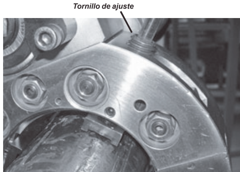
Figura 3-5. Gire el tornillo de ajuste para apretar o aflojar la zapata de fijación.
