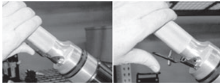
Figura 2-2. Sostenga el disparador del motor neumático para operar la SDSF (izquierda). Cuando suelte el disparador (derecha), el motor neumático se apaga.
