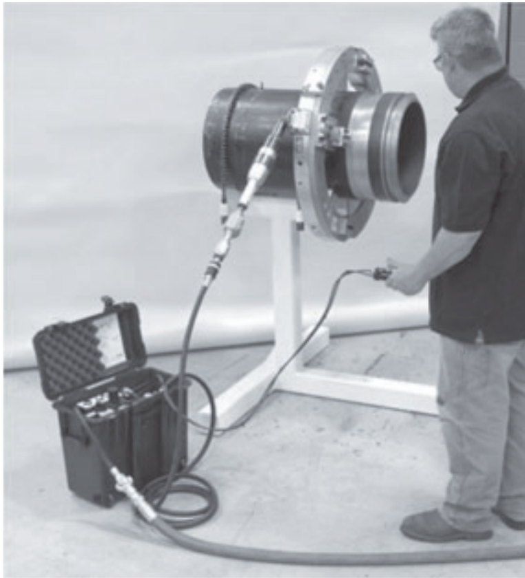
Figura 5-38. Coloque el ACM a una distancia conveniente de la máquina cortadora bi-partida.
