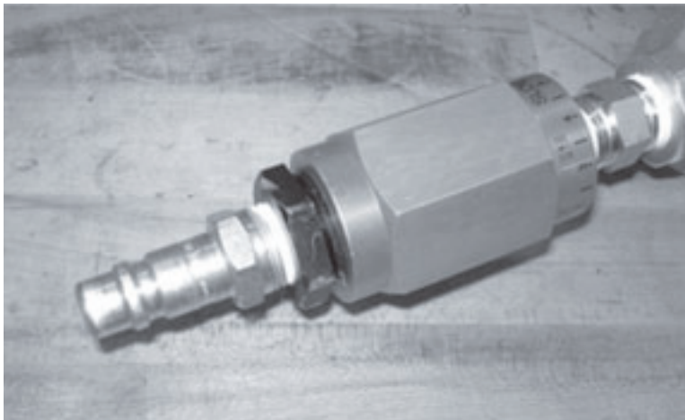
Figura 5-53. Instale el conector suministrado en el motor neumático para usarlo con el ACM.
