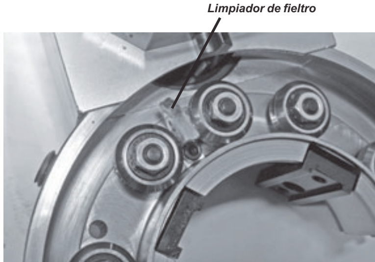
Figura 4-1. Aplique aceite al limpiador de fieltro después de cada uso de la máquina.
