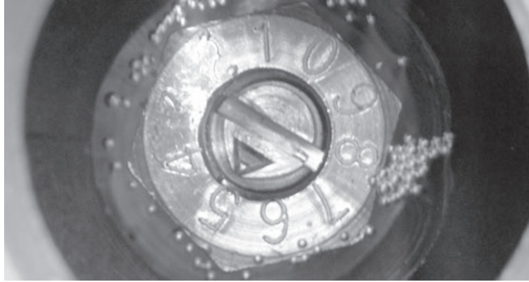
Figura 6-1. Utilizzare la vite della valvola a spillo per regolare la frequenza di gocciolamento dell'oliatore motore di aria.
