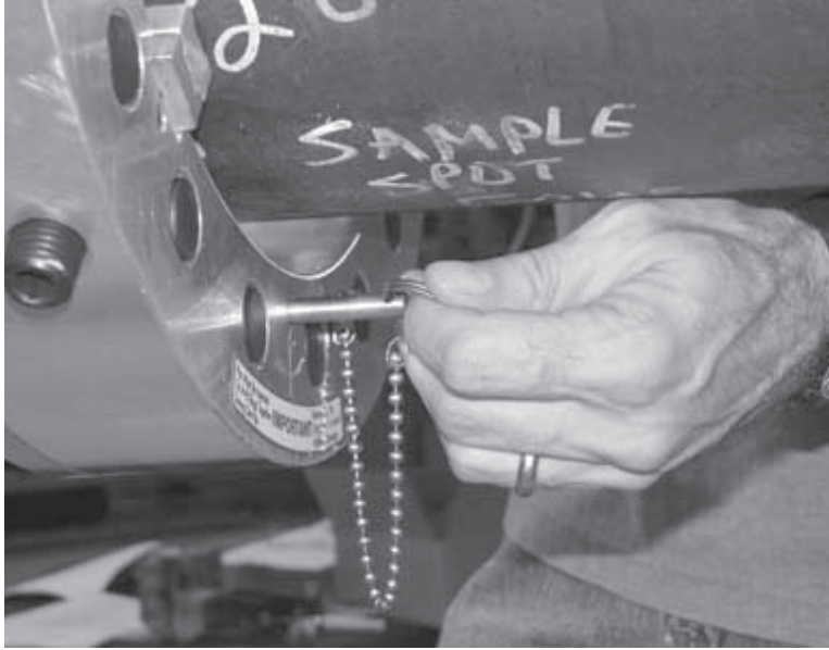
Figura 5-25. Rimuovere i perni di bloccaggio del telaio.
