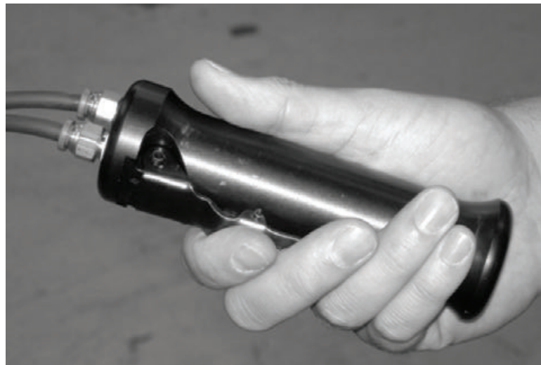
Figura 5-83. Premere il grilletto sul telecomando per azionare la macchina.
