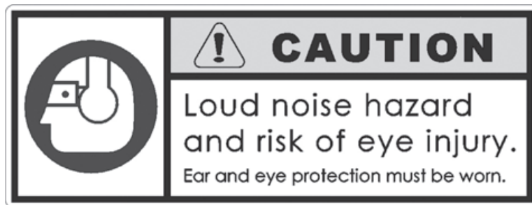
Figura 2-14. L'etichetta di protezione udito e vista è affissa sul motore dell'LCSF. Indossare sempre una protezione per udito e vista durante il funzionamento dell'apparecchiatura. (Codice 90-401-03)
