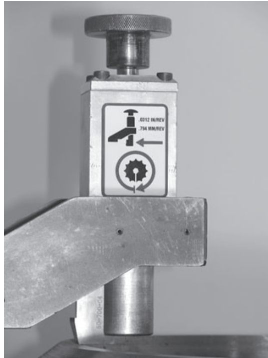
Figura 5-69. Regolazione assiale (0,0312) e radiale (0,0784) per rivoluzione
