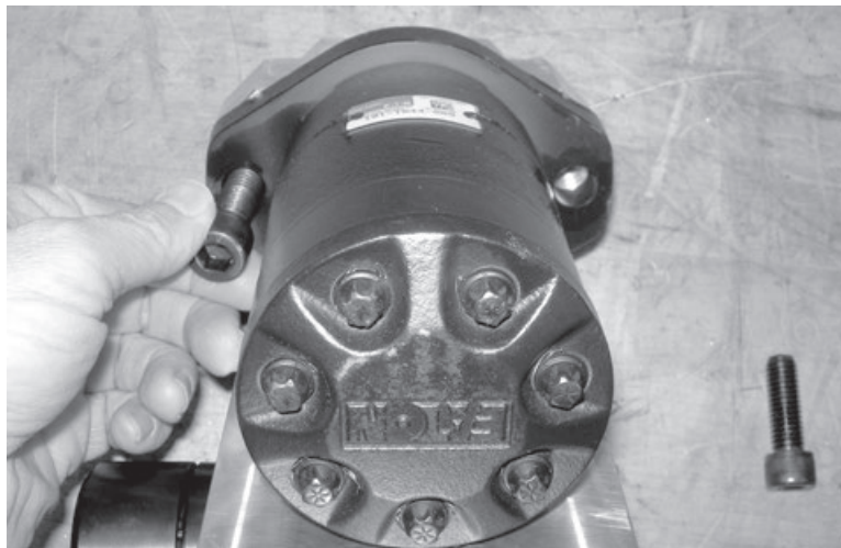
Figura 5-47. Rimuovere le viti del motore idraulico per staccare il motore dall'adattatore.
