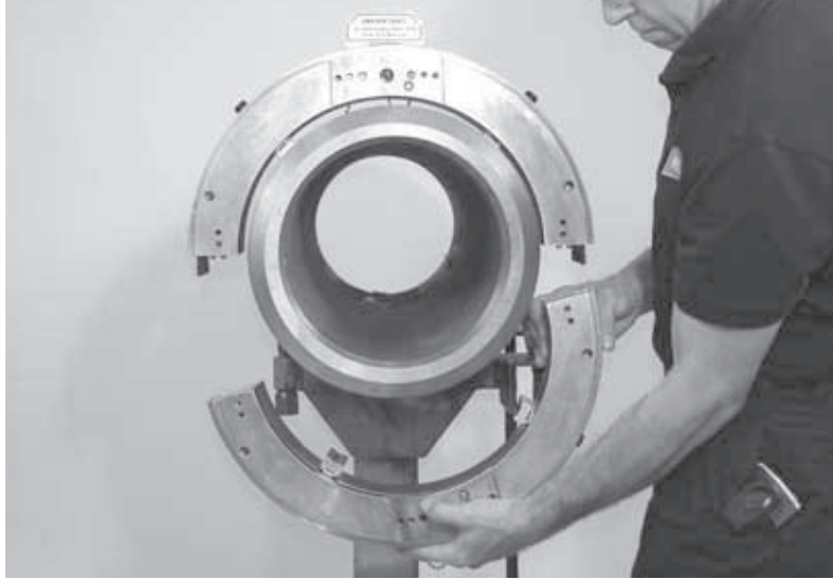
Figura 5-19. Montare le due metà sul tubo.
