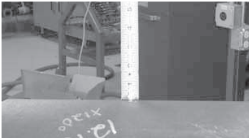
Figura 5-1. Misurare il gioco radiale intorno alla superficie del tubo.
