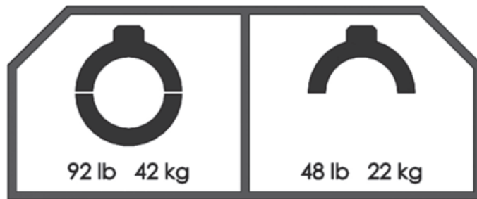
Figura 2-18. Le etichette dei pesi dell'LCSF sono affisse alla sede pignone. I pesi e i codici dipendono dal modello LCSF. (Codice 60-1279-XX)
