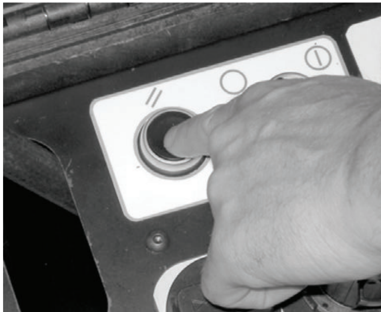
Figura 5-81. Il pulsante Reset reimposta l'ACM dopo una perdita di pressione o un arresto di emergenza.
