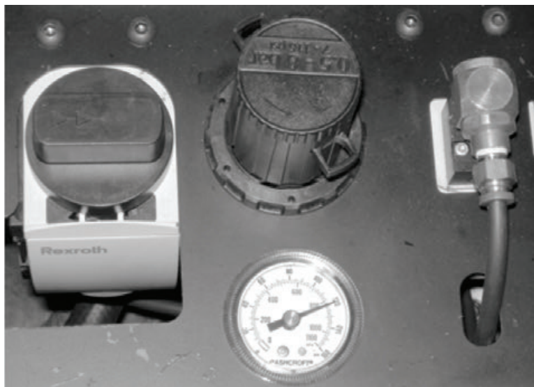
Figura 5-85. Senza tirare la manopola di pressione, è possibile ruotarla per esporre le linguette di blocco. Inserire un lucchetto nella linguetta per impedire che la pressione possa essere regolata.
