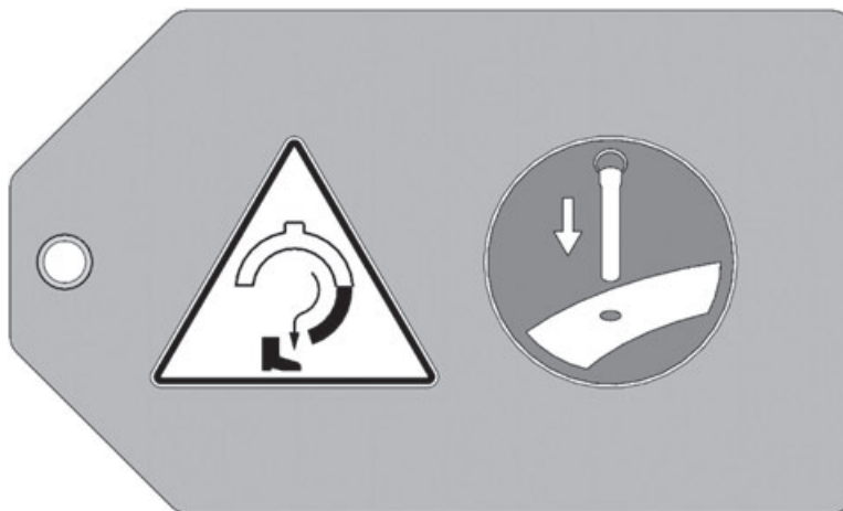
Figura 2-20. La targhetta del perno di allineamento è affissa all'anello sul perno stesso. Assicurarsi di inserire i perni prima di dividere la macchina. (Codice 60-1274-00)
