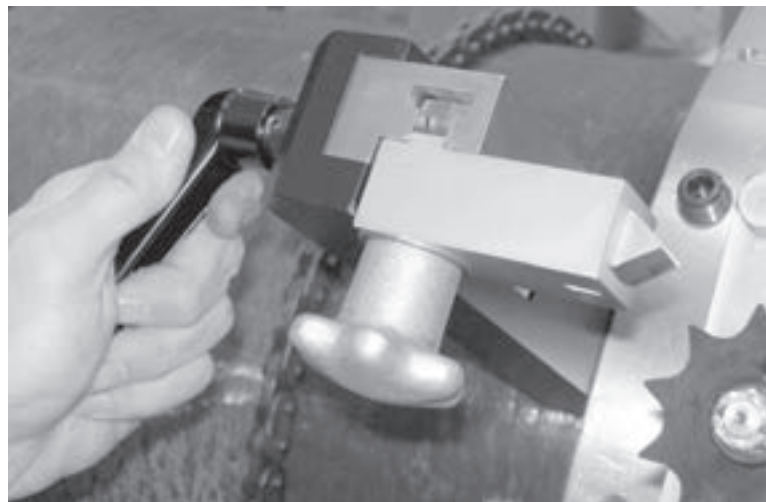
Figura 3-14. Enganche el desenganche aflojando la palanca de bloqueo de desenganche y empuje la barra de desenganche hacia adentro hacia la LCSF.
