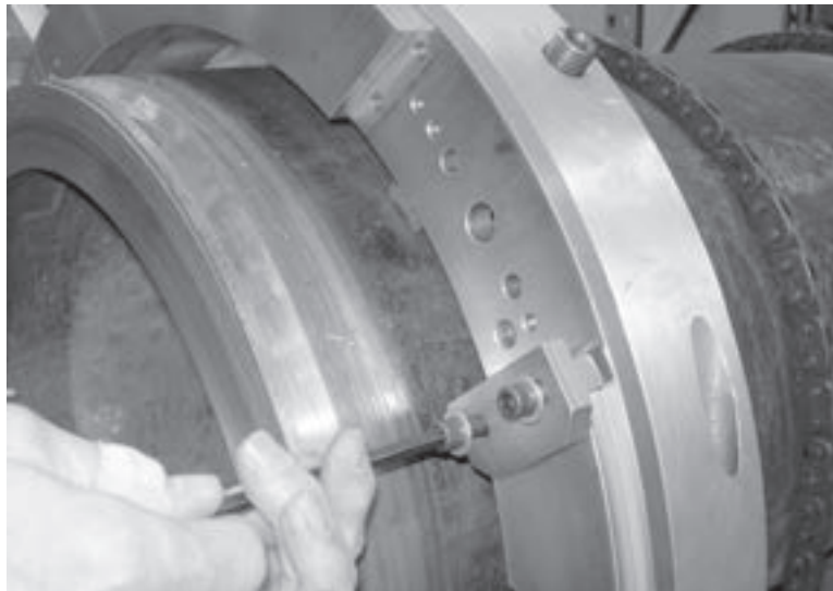
Figura 3-5. Instale las abrazaderas de montaje en el anillo giratorio de la LCSF en las ubicaciones de montaje del portaherramientas
