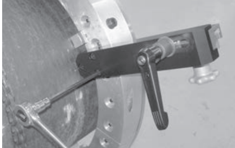
Figura 3-6. Monte el desenganche en la LCSF con los 3 tornillos proporcionados.
