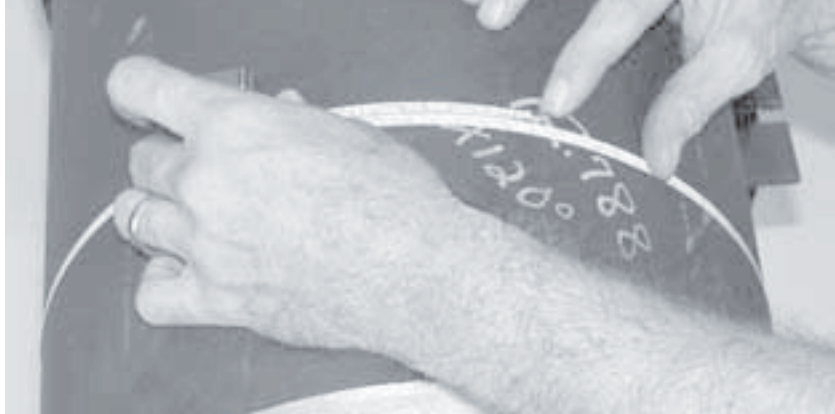
Figure 5-3. Mesurez la circonférence du tuyau.
