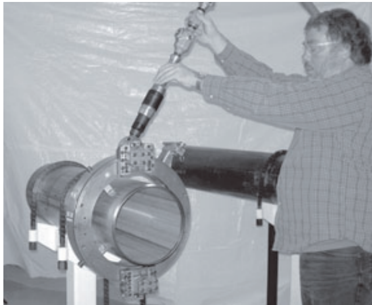
Figure 2-9. Lorsque vous utilisez la machine par l'avant, tenez-vous sur le côté de la machine pour utiliser les commandes sans entrer en contact avec le rotor.
