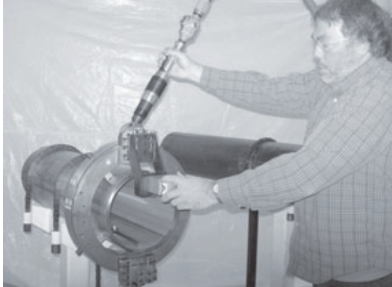
Figure 2-10. Lorsque vous utilisez des accessoires qui nécessitent d'utiliser leurs commandes (traverse de lamage universel représentée), tenez-vous dans une position qui permet d'utiliser la machine sans entrer en contact avec des pièces mobiles.
