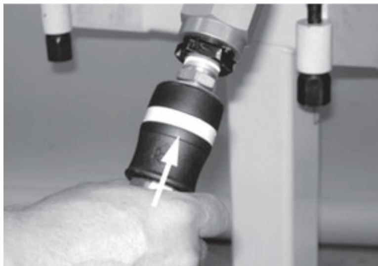
Figure 5-86. Poussez le raccord rapide de la canalisation pneumatique sur le raccord du moteur pneumatique jusqu'à ce qu'il soit bloqué.
