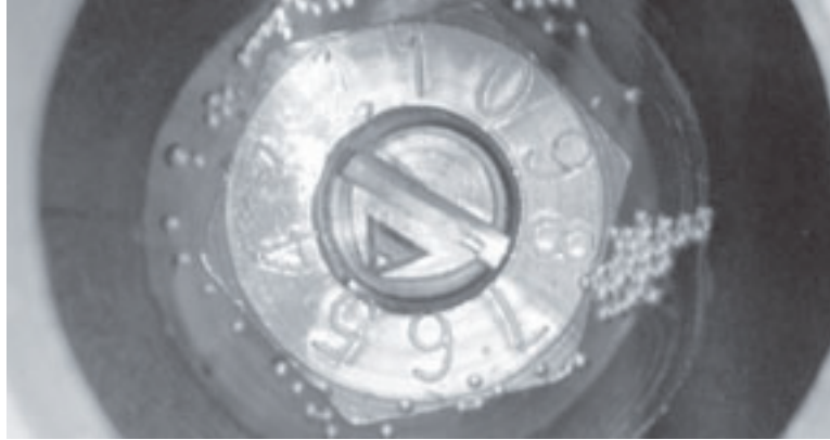
Figure 6-1. Utilisez la vis de la vanne à pointeau pour régler de débit d'écoulement du graisseur du moteur pneumatique.
