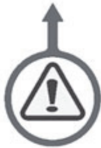
Figure 2-22. L'étiquette de l'emplacement des pieds de centrage est apposée pour indiquer les trous d'alignement. La machine LCSF comporte deux étiquettes, une pour chaque emplacement. Référence 60-1275-00.)
