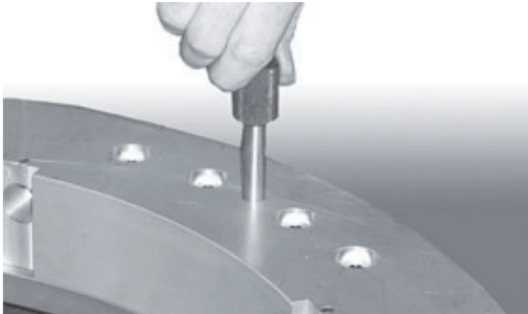
Figure 7-6. Introduisez les pieds de centrage pour empêcher la rotation du rotor.
