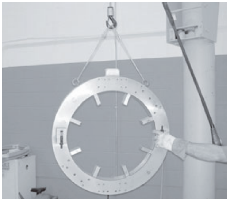
Figure 5-8. Levez la machine assemblée.
