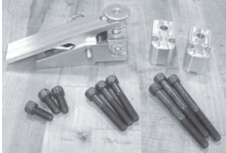
Figure 5-39. L'ensemble déclencheur est fourni avec 2 blocs de rallonge et 3 tailles de vis pour les 3 configurations (sans bloc, 1 bloc ou 2 blocs).
