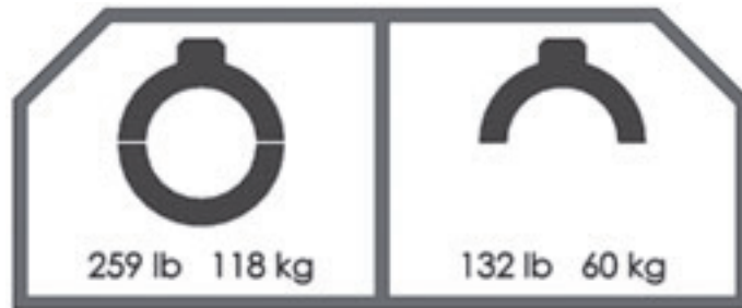
Figure 2-19. Les étiquettes de poids de la machine LCSF sont apposées sur le carter de transmission. Le poids et la référence varient en fonction du modèle LCSF. (Référence 60-1279-XX.)
