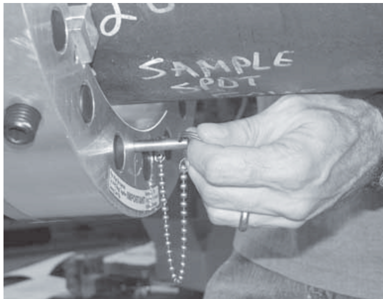
Figure 5-25. Déposez les goupilles de blocage du châssis.
