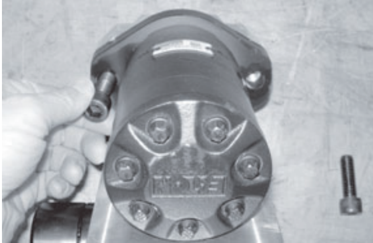
Figure 5-47. Démontez les vis de la transmission hydraulique pour déposer le moteur de l'adaptateur.
