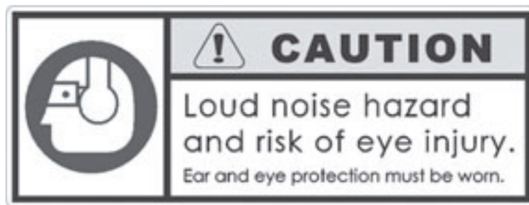
Figure 2-15. L'étiquette de protection oculaire et auditive est apposée sur le moteur de commande de la machine. Portez toujours une protection oculaire et auditive lorsque vous utilisez le matériel. Référence 90-401-03.)
