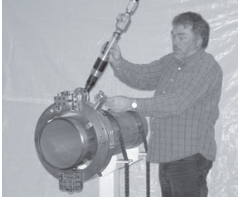
Figure 2-8. Dans la mesure du possible, tenez-vous derrière la machine pour rester hors de portée des pièces mobiles pendant l'utilisation des commandes.
