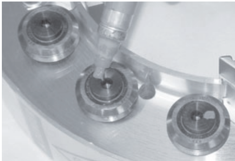
Figure 7-1. Marquez le côté de chaque roulement.
