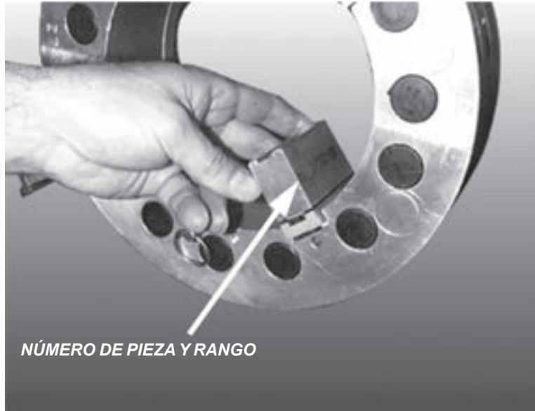
Figura 5-14. Instale las patas en las placas de fijación.
