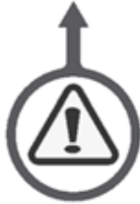
Figura 2-22. La etiqueta de ubicación del pasador de alineación está adherida para indicar los orificios de los pasadores de alineación. Hay dos etiquetas en la LCSF, una para cada ubicación del pasador. (Núm. de pieza 60-1275-00).
