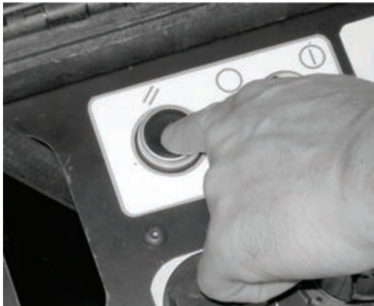
Figura 5-81. El botón "Reset" restablece el ACM después de una pérdida de presión o de una parada de emergencia.
