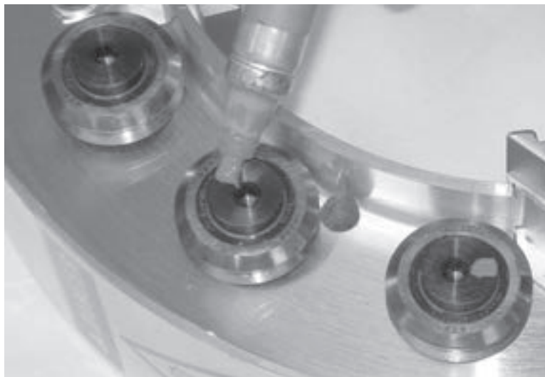
Figura 7-1. Marque el borde de cada rodamiento.
