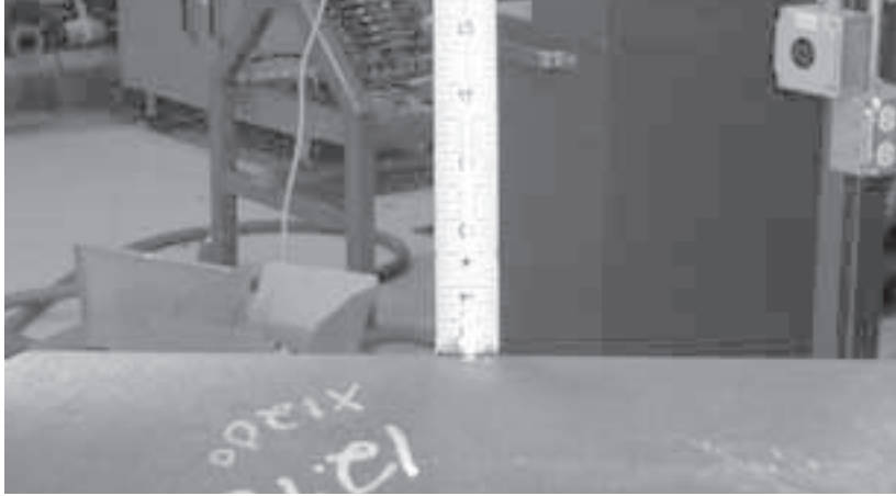
Figura 5-1. Mida el claro radial alrededor de la superficie del tubo.
