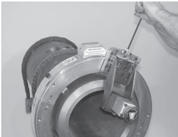
Figura 5-68. Ajuste el portaherramientas de abocardado girando el tornillo de alimentación radial en el sentido del reloj.
