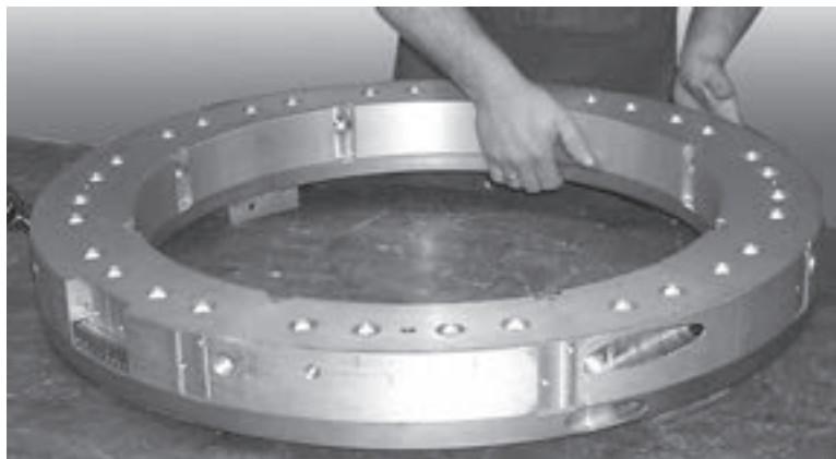
Figura 7-5. Verifique el juego entre los anillos giratorio y estacionario.
