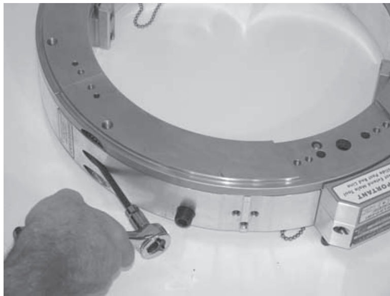
Figura 5-16. Afloje los tornillos cautivos para separar las mitades.
