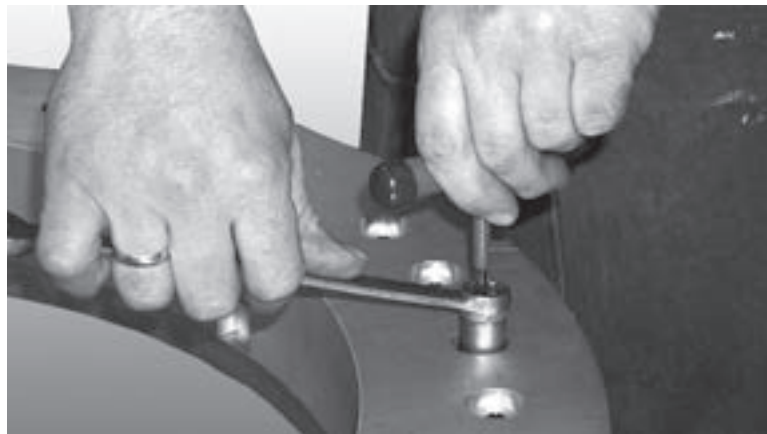
Figura 7-8. Gire el eje de rodamiento en sentido del reloj con la llave hexagonal, luego apriete la tuerca Nylock.
