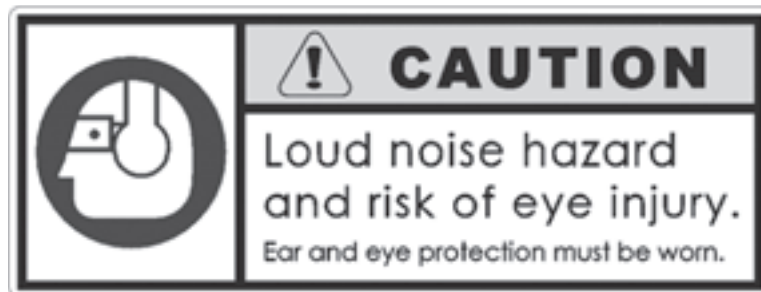
Figura 2-15. La etiqueta de protección de la vista y la audición está adherida al motor de accionamiento de la LCSF. Siempre use protección de la vista y de la audición al momento de operar el equipo. (Núm. de pieza 90-401-03).
