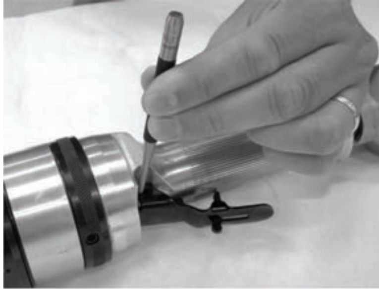
Figura 5-90. Use un punzón para sacar el pasador que sujeta el disparador neumático.
