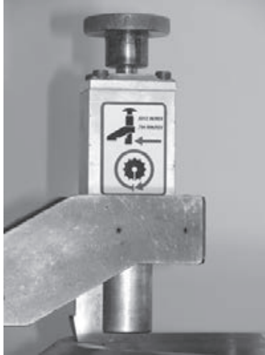
Figura 5-69. Ajuste axial (0,0312) y radial (0,0784) por revolución.
