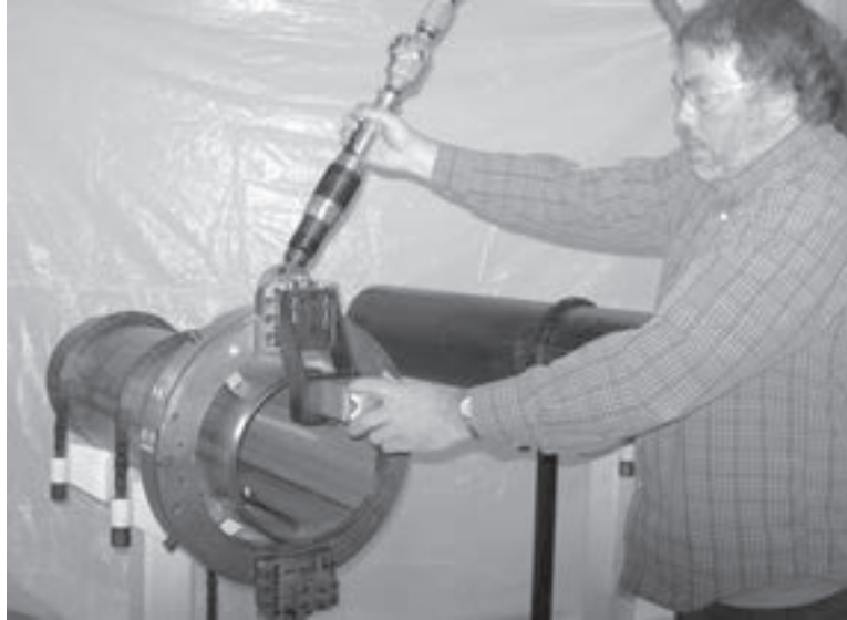
Figura 2-10. Cuando use accesorios que requieren que opere sus controles (se muestra con el portaherramientas de abocardado universal), párese en una posición donde pueda operar la máquina sin entrar en contacto con las piezas en movimiento.
