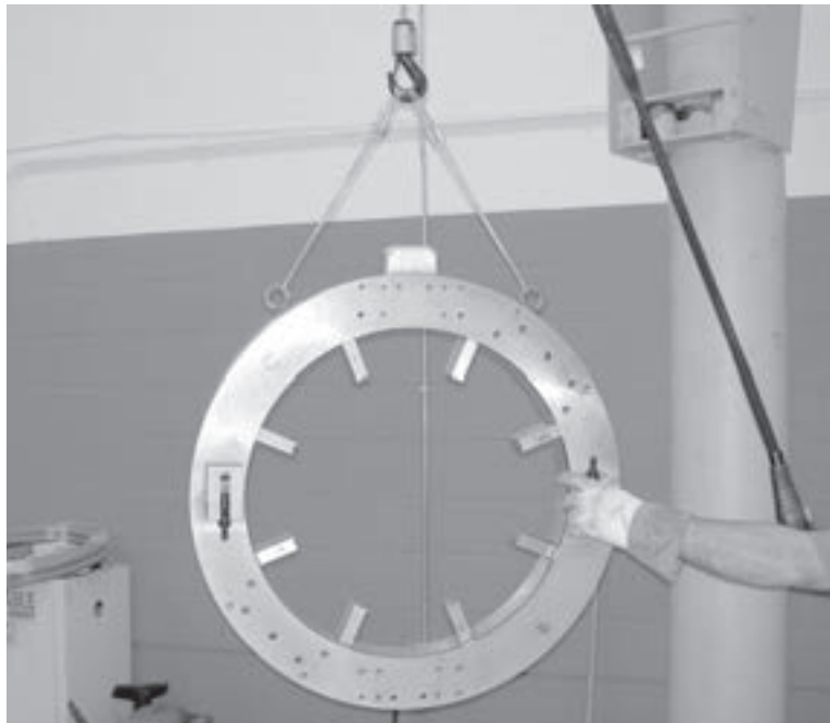
Figura 5-8. Eleve la máquina ensamblada como se muestra.
