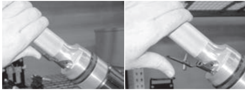
Figura 2-5. Sostenga el disparador del motor neumático para operar la LCSF (izquierda). Cuando suelte el disparador (derecha), el motor neumático se apaga.
