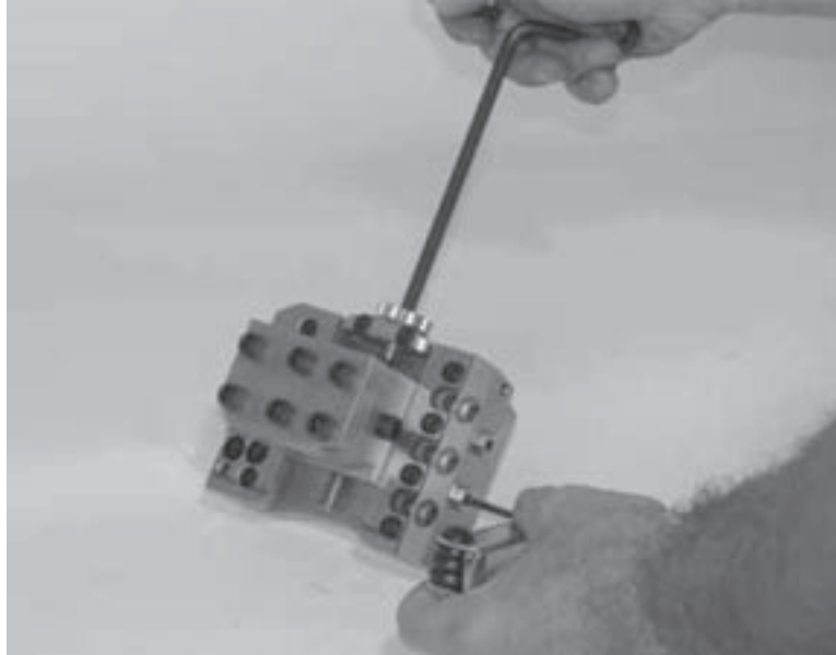
Figura 7-15. Apriete los tornillos de fijación mientras gira la estrella.
