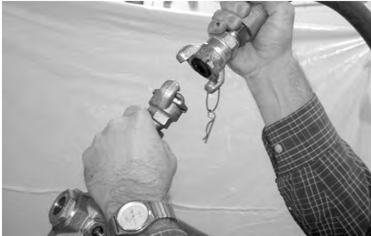
Figura 2-5. Desconecte la alimentación neumática retirando la línea de aire de la transmisión neumática.
