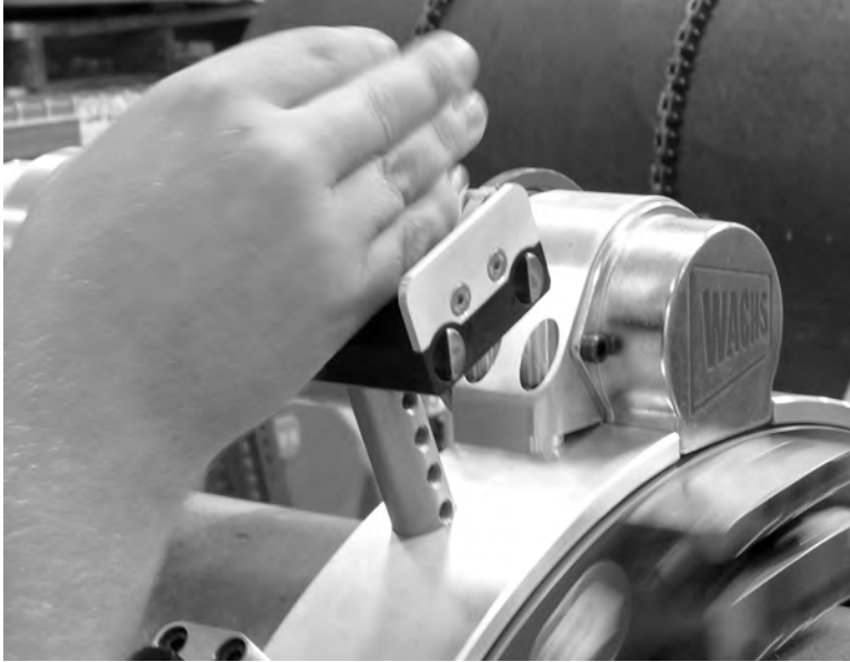
Figura 5-4. Antes de poner la máquina en funcionamiento, presione las perillas de disparo hacia atrás para desconectar los disparos.
