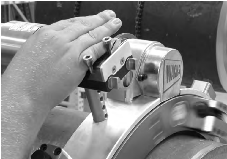
Figura 5-5. Para activar los disparos, empuje las perillas de disparo hacia adelante.
