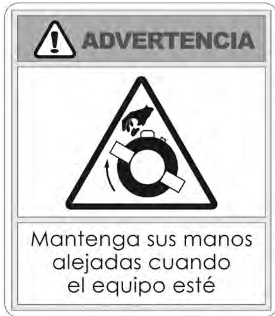
Figura 2-14. La etiqueta "Mantenga sus manos alejadas" va adherida al anillo fijo del MDSF. Manténgase lejos de las piezas móviles mientras la máquina esté en funcionamiento. (Núm de pieza 60-363-00.)
