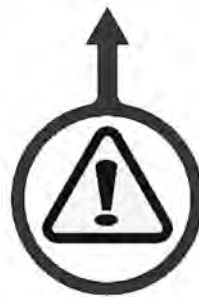
Figura 2-16. La etiqueta de ubicación del pasador de alineación va adherida para indicar los orificios del pasador de alineación. Hay dos etiquetas en MDSF, una para cada ubicación de pasador. (Núm de pieza 60-1275-00.)
