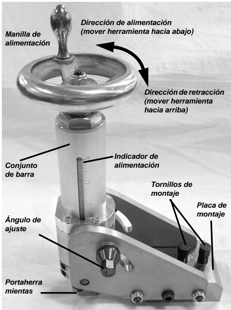
Figura 7-1. La foto muestra los componentes de la corredera de rectificado.
