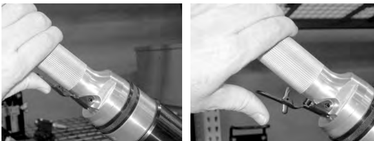
Figura 2-2. Mantenga apretado el gatillo del motor neumático para que funcione DynaPrep MDSF (izquierda). Al soltar el gatillo (derecha), el motor neumático se apaga.
