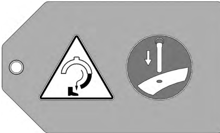
Figura 2-15. La etiqueta del pasador de alineación va adherida al anillo del pasador de alineación. Asegúrese de insertar los pasadores antes de dividir la máquina. (Núm de pieza 60-1274-00.)
