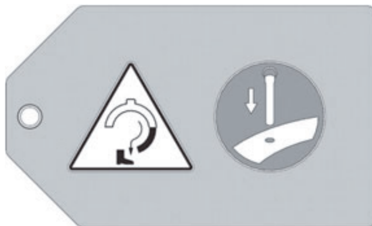
Рис. 2-21. Наклейка с указанием места расположения центрирующего штифта прикреплена к станине. Убедитесь в установке центрирующих штифтов перед разъемом половин станины. (Артикул 60-1274-00).
