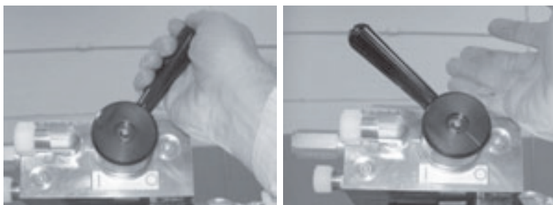
Рис. 2-6. Удерживайте пусковой рычаг гидравлического двигателя для задействования НПРА (слева). При отпускании рычага (справа) происходит останов гидравлического двигателя.
