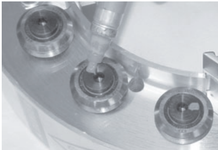
Рис. 7-1. Проставьте отметку на кромках всех подшипников.
