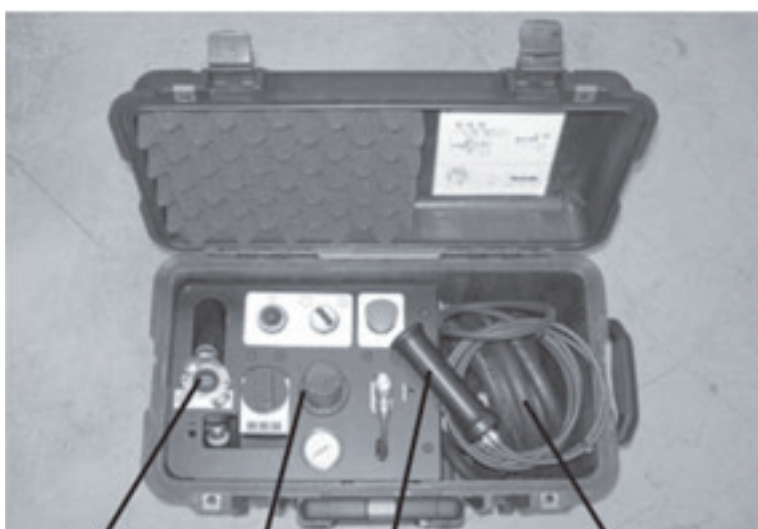
Соединитель подачи воздуха Пульт управления Переносной пульт управления Выпускной шланг к разъемному агрегату
