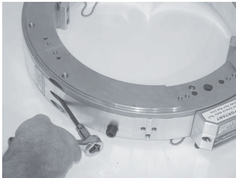
Рис. 5-16. Отверните невыпадающие винты для разъема половин агрегата.
