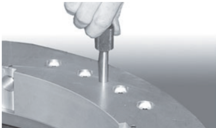
Рис. 7-6. Вставьте центрирующие штифты для предотвращения проворачивания вращающейся платформы.
