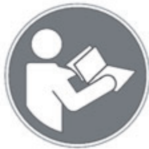
Рис. 2-23. Наклейка «Сверьтесь с руководством по эксплуатации» прикреплена к станине НППА. До начала работы убедитесь в понимании всех указаний по настройке и эксплуатации агрегата. (Артикул 90-900-00).
