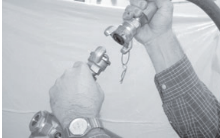
Рис. 2-11. Расцепите соединительную муфту пневматического двигателя и воздушной линии.
