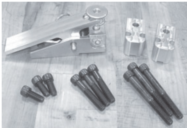
Рис. 5-39. Механизм включения/выключения подачи резца имеет 2 шт. удлинительных блоков и 3 комплекта винтов различных размеров для 3 конфигураций установки (без блоков, с одним и двумя блоками).
