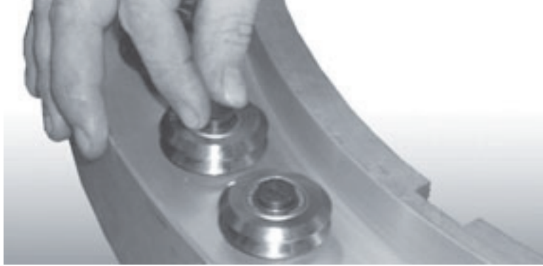
Рис. 7-2. Проверните все эксцентриковые валы для установки наивысших точек всех подшипников по направлению к внутренней части неподвижной платформы.
