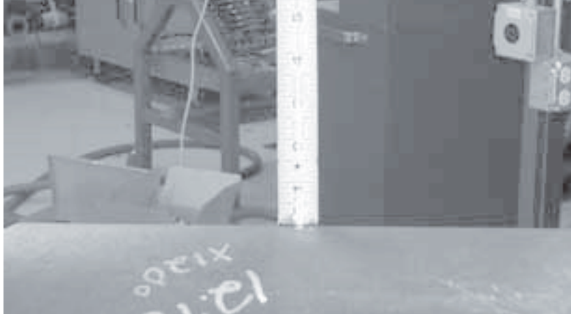
Рис. 5-1. Измерьте радиальный зазор вокруг поверхности трубы.
