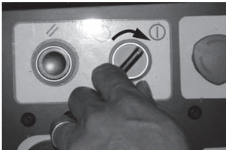
Рис. 5-82. Поверните переключатель задействования дистанционного управления в положение ON («Вкл.») для включения переносного пульта.
