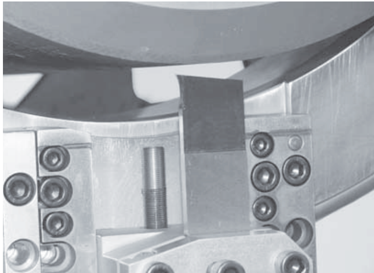
Рис. 5-37. Расположите кончик реза с зазором 1/8" (3 мм) от поверхности трубы.
