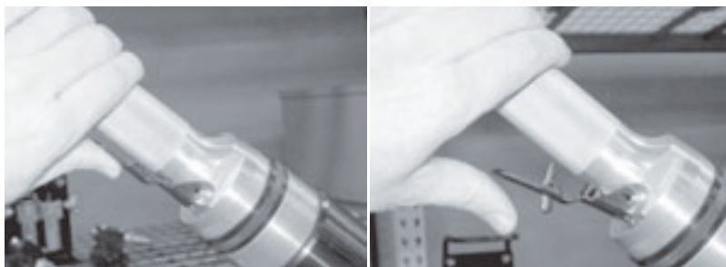
Рис. 2-5. Удерживайте пускатель пневматического двигателя для задействования НПРА (слева). При отпускании пускателя (справа) происходит останов пневматического двигателя.
