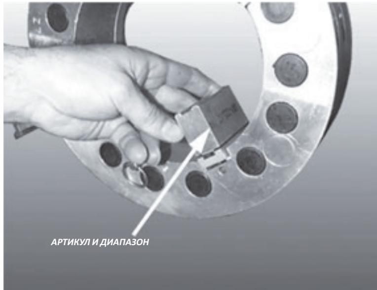
Рис. 5-14. Установите зажимные механизмы в зажимные блоки.
