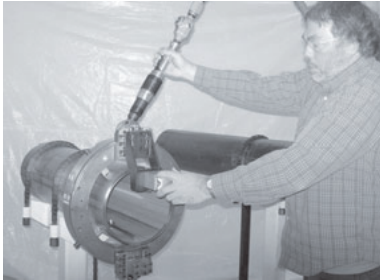
Рис. 2-10. При использовании вспомогательного оборудования с необходимостью контроля органов управления (показано унифицированное расточное устройство) следует располагаться в положении, позволяющем управлять агрегатом без контакта с подвижными частями.
