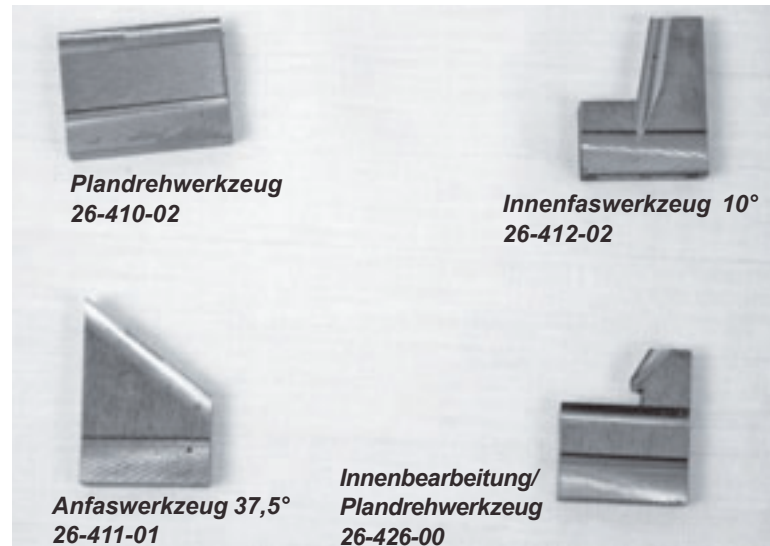
Abbildung 3-3. Mit dem Standardwerkzeug des SDB kann der Bediener Leerzeichen Rohre und Rohrleitungen anplanen, fassen, U-Nähte vorbereiten und innenbearbeiten.
