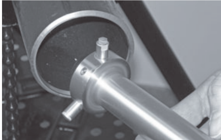
Abbildung 5-12. Führen Sie den Spanndorn in das Rohr ein.
