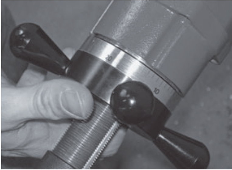
Abbildung 5-26. Der kalibrierte Vorschubhebel ist in Schrittgrößen von 1/1000" abgestuft.
