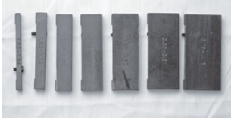
Abbildung 5-6. Jeder Spannfuß ist mit einer Referenznummer markiert, die dem Rohrinnendurchmesserbereich entspricht, für den der Spannfußsatz geeignet ist.
