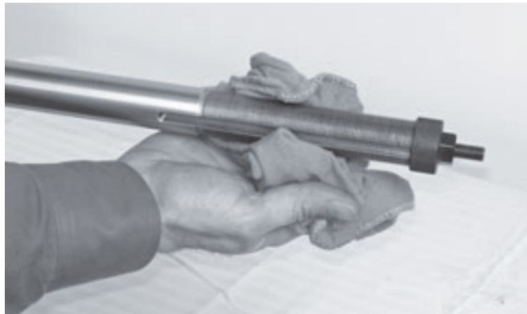
Abbildung 5-1. Prüfen Sie bei der Reinigung des Spanndorns die Gewinde auf Beschädigungen.
