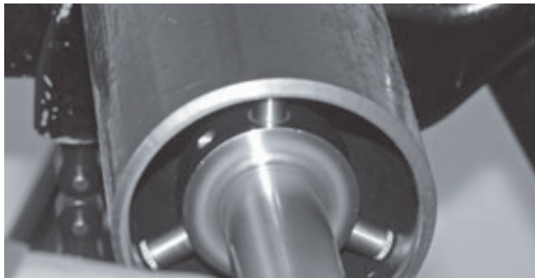
Abbildung 5-15. Die Spanndornfüße sollten sich nahe der Rohrkante befinden.
