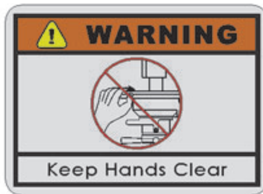
Abbildung 2-1. Der Aufkleber „Warnung“ befindet sich auf dem SDB 103. Kommen Sie nicht mit Ihren Händen in die Nähe des rotierenden Werkzeugkopfes, während die Maschine in Betrieb ist. (Artikelnummer 66-147-00.)
