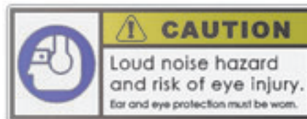
Abbildung 2-3. Der Aufkleber „Vorsicht Lärm und Gefahr von Augenschäden“ befindet sich auf dem Druckluftmotor des SDB 103. Tragen Sie beim Betrieb dieser Maschine immer einen Gehör- und Augenschutz. (Artikelnummer 90-401-03.)
