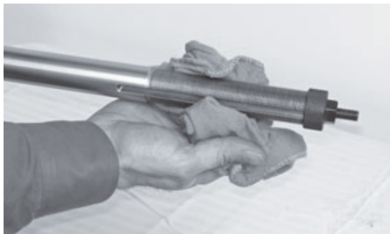
Abbildung 6-3. Prüfen Sie bei der Reinigung des Spanndorns die Gewinde auf Beschädigungen.
