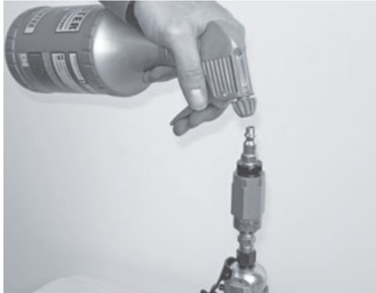
Abbildung 6-2. Schmieren Sie den Druckluftmotor täglich mit Druckluftmotoröl.
