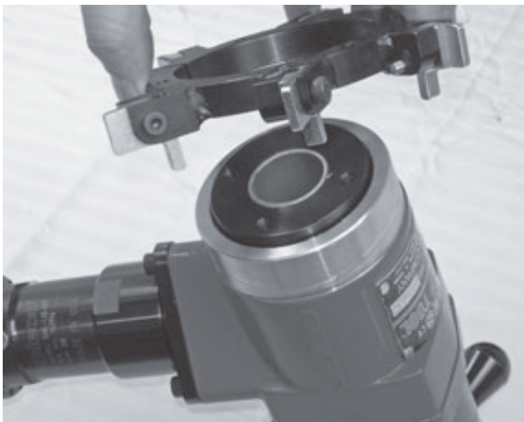
Abbildung 5-30. Die Arretierschraube des Auslösebunds sollte sich so nahe am Druckluftmotorgehäuse wie möglich befinden.
