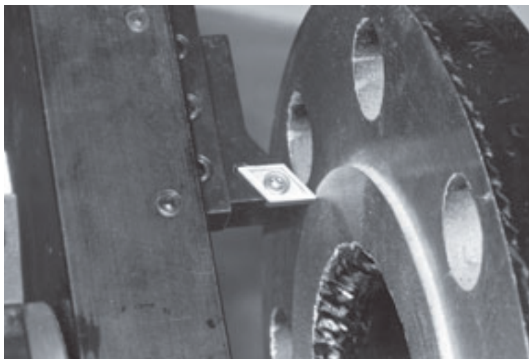
Abbildung 5-38. Positionieren Sie das einschneidige Trennwerkzeug mit der Schnittkante in Drehrichtung.
