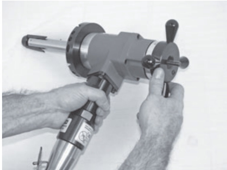
Abbildung 5-3. Drehen Sie den Vorschubhebel, um den Spanndorn in das Maschinengehäuse zu schrauben
