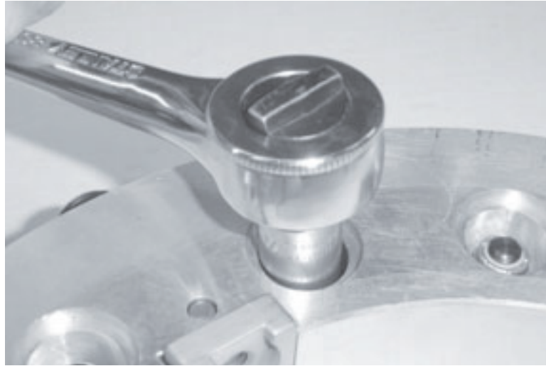
Figura 7-5. Afloje las tuercas de bloqueo.
