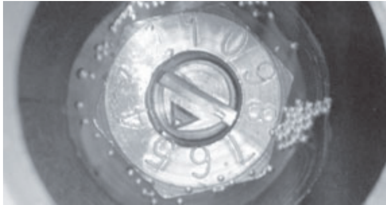
Figura 6-1. Use el tornillo de la válvula de aguja para ajustar la velocidad de goteo de la aceitera del motor neumático.
