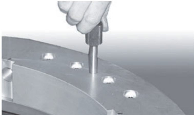
Figura 7-18. Inserte los pasadores de alineación para prevenir que gire el anillo giratorio.
