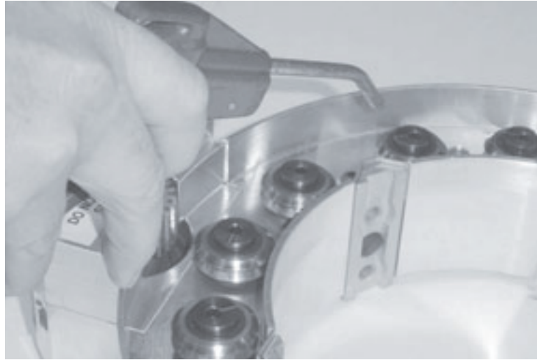
Figura 7-2. Limpie los residuos del anillo estacionario.
