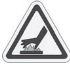
Figura 2-17. La etiqueta de superficie caliente está adherida al motor de accionamiento de la LCSF (neumático o hidráulico). Los componentes de la unidad de accionamiento pueden ponerse muy calientes y causar quemaduras. Asegúrese de que estos componentes no estén calientes antes de tocarlos. (Núm. de pieza 90-403-00).
