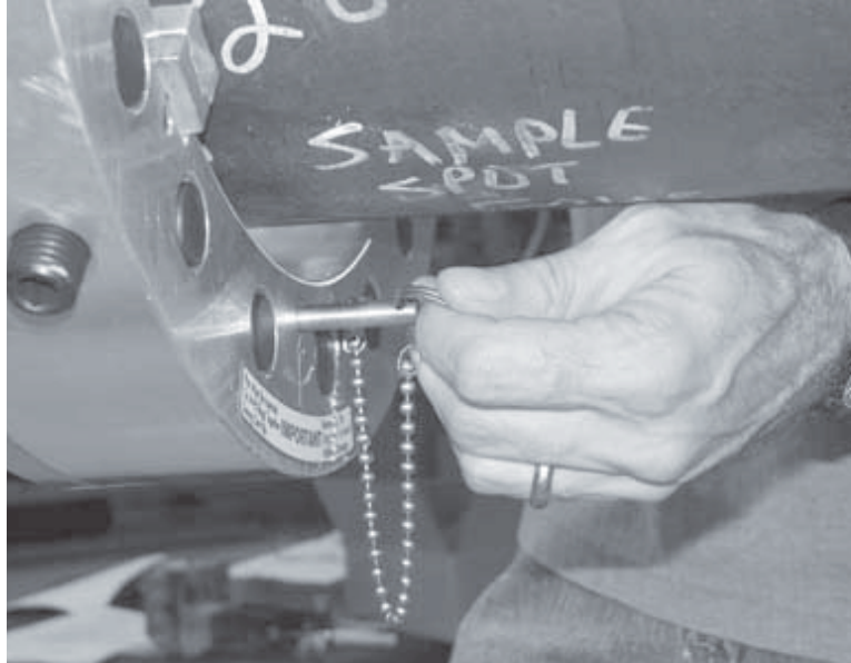
Figura 5-25. Quite los pernos de bloqueo de la cortadora.
