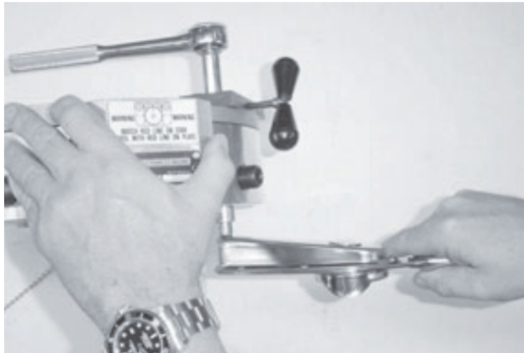
Figura 7-10. Fije el eje excéntrico.
