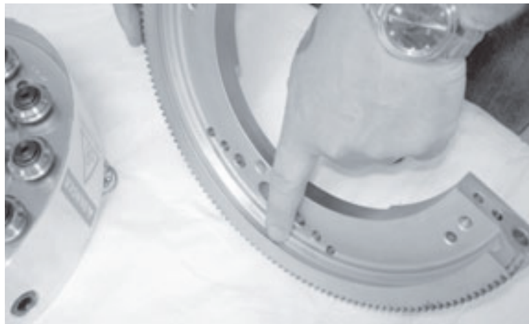
Figura 7-3. Revise que la ranura en “V” del anillo giratorio no tenga desgaste o daños.
