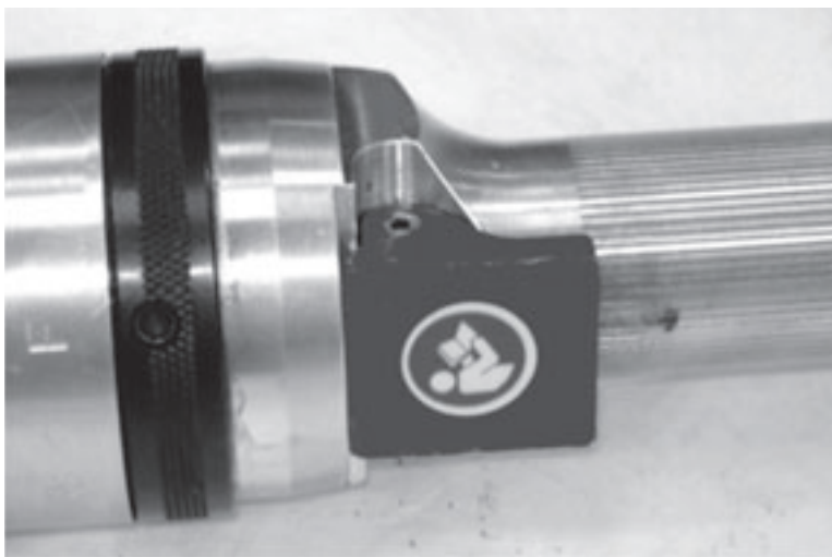
Figura 5-93. La foto muestra la instalación correcta de la válvula mariposa de aceleración abierta.
