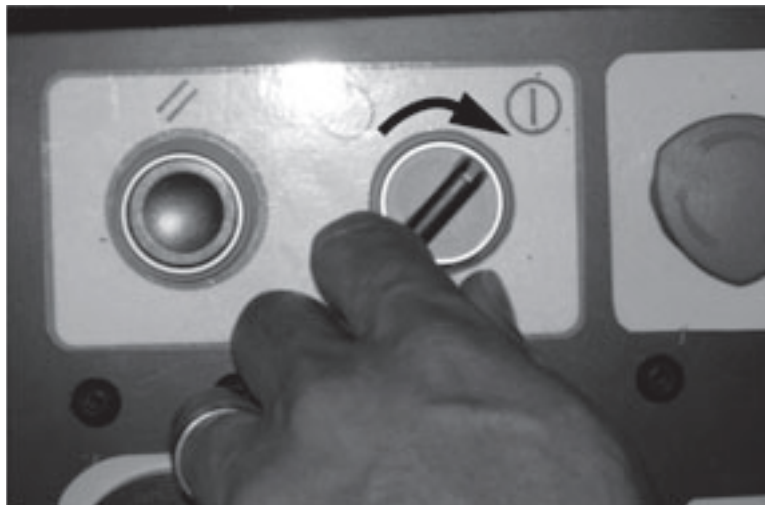
Figura 5-82. Gire el interruptor "Remote Enable" (habilitar control remoto) para activarlo para habilitar una operación usando el control de mano.
