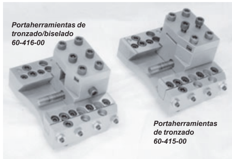
Figura 3-5. La foto muestra el portaherramientas extendido, el cual es el estándar para la LCSF modelos 204 a 1420. El tiro de corte (carrera del portaherramientas) es de 1,67" (41,8 mm).
