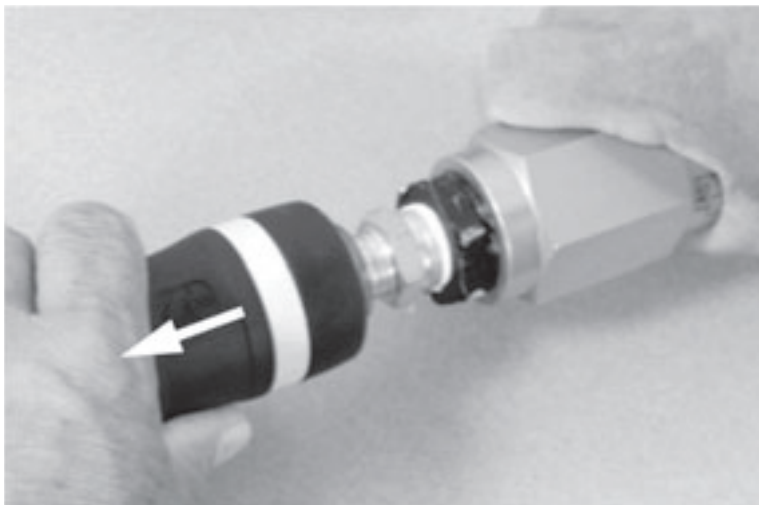
Figura 5-87. Para liberar la desconexión, jale el collarín hacia atrás. La desconexión se instalará de nuevo en la posición de liberación. (De este modo se ventilará el aire en la línea de aire).
