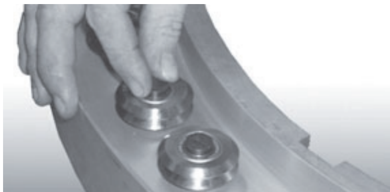
Figura 7-14. Gire los ejes excéntricos de modo que el punto alto de cada rodamiento esté de frente hacia el interior del anillo.
