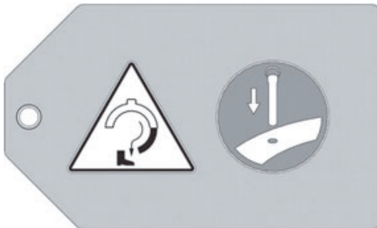
Figura 2-20. La etiqueta del pasador de alineación está adherida al anillo en el pasador de alineación. Asegúrese de insertar los pasadores antes de dividir la máquina. (Núm. de pieza 60-1274-00).
