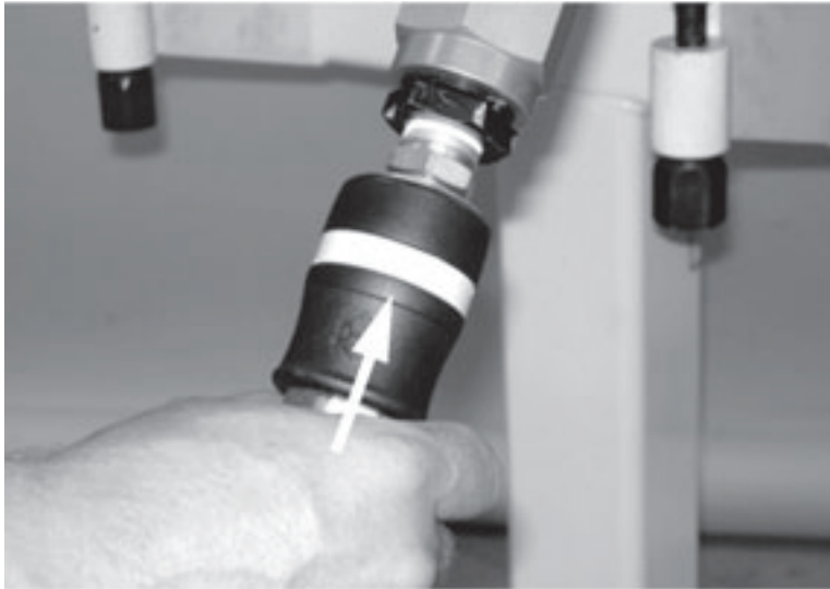
Figura 5-86. Empuje la desconexión de línea de aire en el conector de la unidad de accionamiento neumático hasta que se enclave en su lugar.
