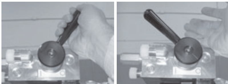
Figura 2-5. Sostenga la palanca hidráulica para operar la LCSF (izquierda). Cuando suelte la palanca (derecha), el motor hidráulico se apaga.
