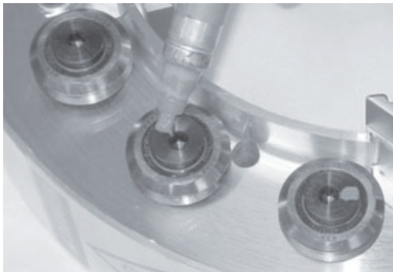
Figura 7-13. Marque el borde de cada rodamiento.
