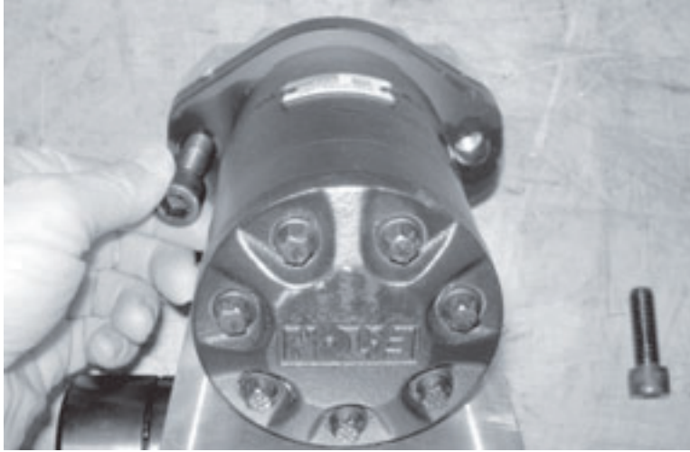
Figura 5-47. Quite los tornillos de la unidad de accionamiento hidráulico para quitar el motor de accionamiento del adaptador:
