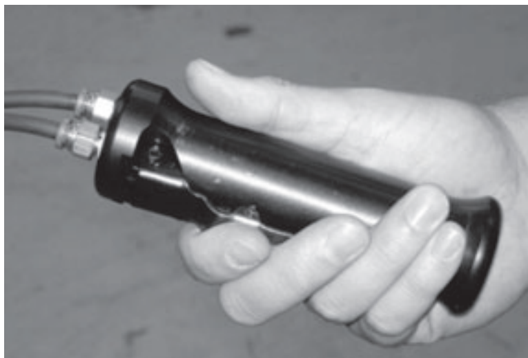
Figura 5-83. Apriete el disparador en el control de mano para operar la máquina.
