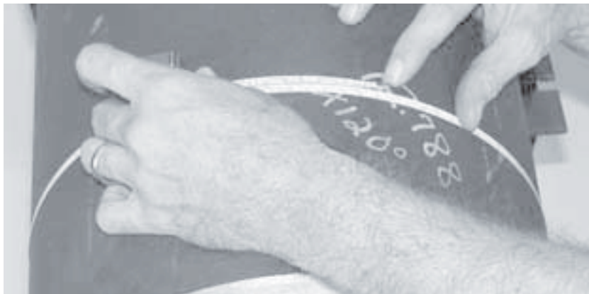
Figura 5-3. Verifique la circunferencia del tubo haciendo una medición.
