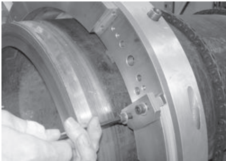
Abbildungen 3-5. Installieren Sie die Montagespanner an den Werkzeugschlitten-Montagepositionen des LCSF-Drehrings.
