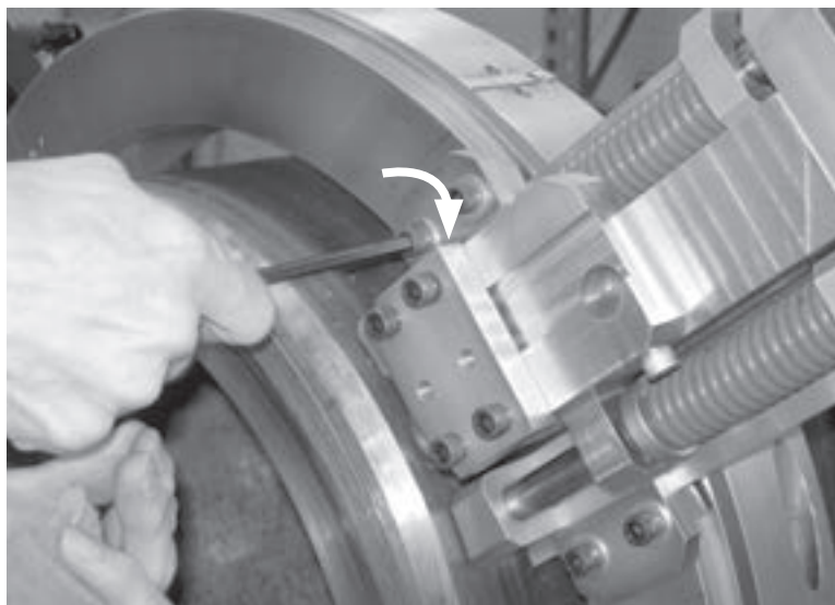
Abbildungen 3-12. Sobald die Schlittenpositionen eingestellt sind, ziehen Sie die Montagespannerschrauben sicher an.
