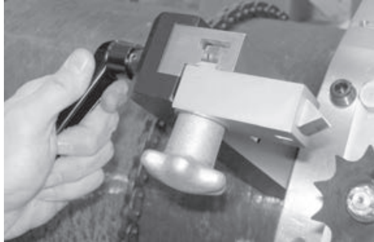
Abbildungen 3-14. Kuppeln Sie den Vorschubauslöser ein, indem Sie den Auslöseverriegelungshebel lösen und die Auslöserstange in Richtung der LCSF hineindrücken.
