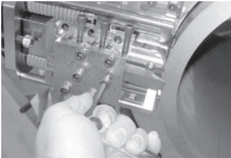
Abbildungen 3-19. Ziehen Sie die oberen Stellschrauben an, um das Anfaswerkzeug in seiner Position zu halten.
