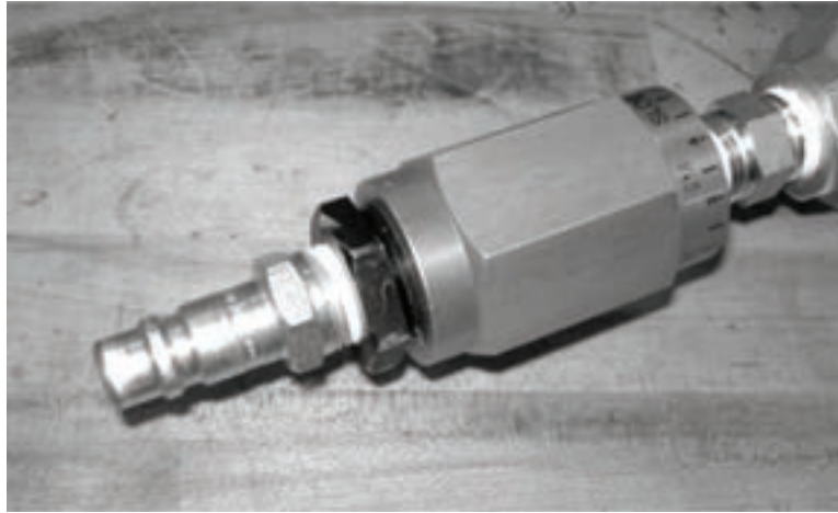
Figure 5-89. Montez l'embout fourni sur le moteur pneumatique pour l'utiliser avec le module ACM.
