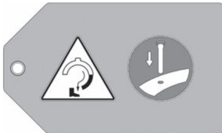
Figure 2-21. L'étiquette du pied de centrage est apposée sur le stator. N'oubliez pas d'introduire ces axes avant de séparer la machine. Référence 60-1274-00.)
