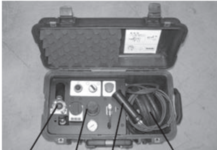
Connecteur d'arrivée d'air Tableau de commande Pendulaire Tuyau de sortie vers le châssis en 2 parties
