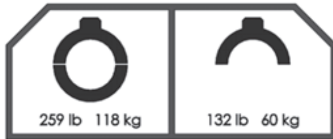
Figure 2-19. Les étiquettes de poids de la machine LCSF sont apposées sur le carter de transmission. Le poids et la référence varient en fonction du modèle LCSF. (Référence 60-1279-XX.)
