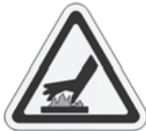
Figure 2-18. L'étiquette de surface chaude est apposée sur le moteur de commande LCSF (pneumatique ou hydraulique). Les composants de transmission peuvent être suffisamment chauds pour provoquer des brûlures. Vérifiez qu'ils ne sont pas chauds avant de les toucher. Référence 90-403-00.)
