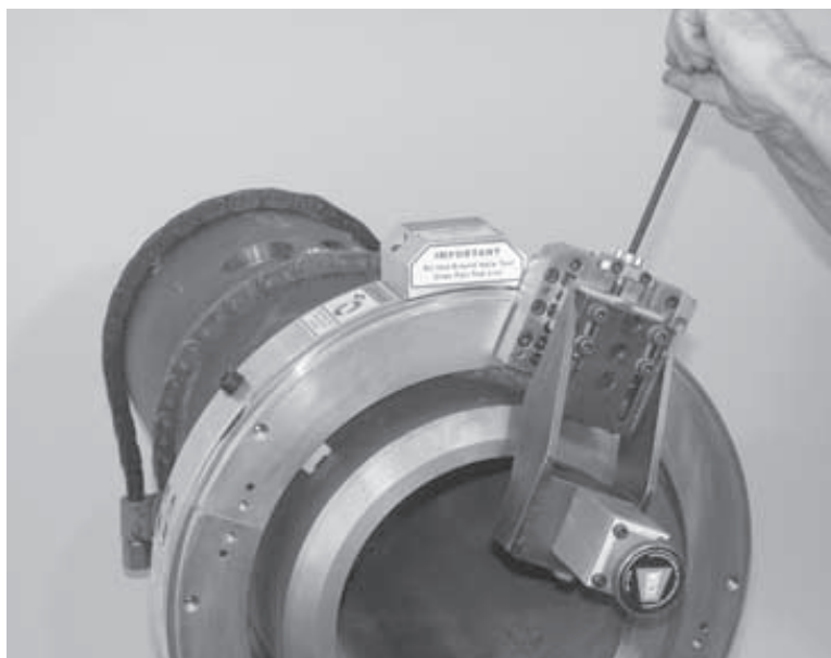
Figure 5-68. Réglez le porte-outil de lamage en tournant la vis d'avance radiale dans le sens des aiguilles d'une montre.
