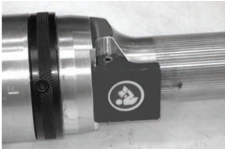
Figure 5-93. La photo illustre le montage correct du papillon de réglage.
