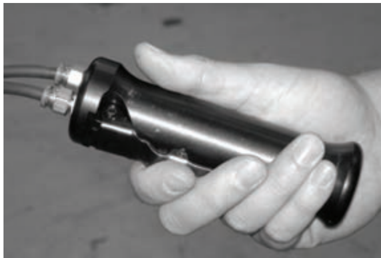
Figure 5-83. Appuyez sur la gâchette du pendulaire pour faire fonctionner la machine.
