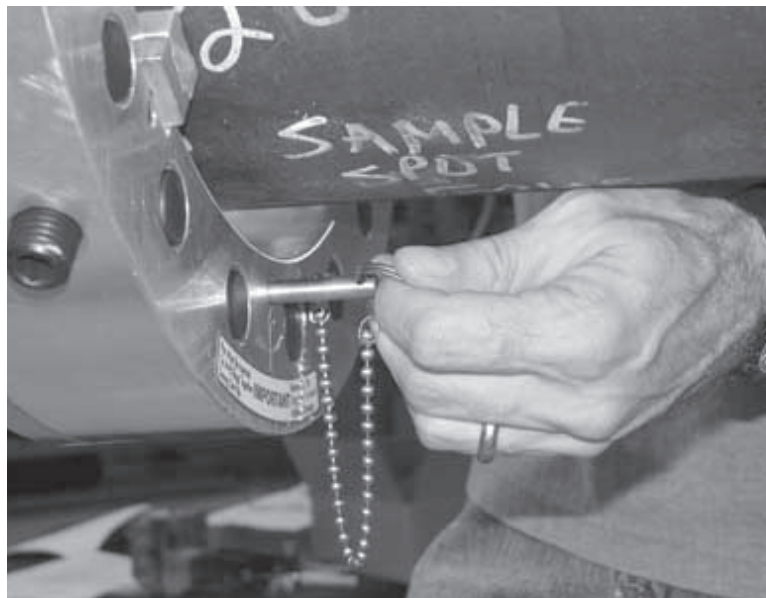
Figure 5-25. Déposez les goupilles de blocage du châssis.
