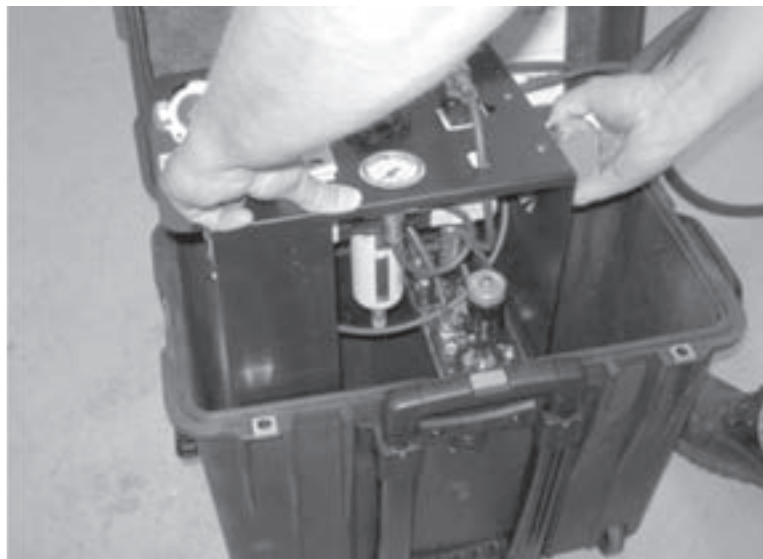
Figure 6-2. Levez le tableau de commande pour le sortir de la caisse pour l'entretien ou vidanger l'eau accumulée.
