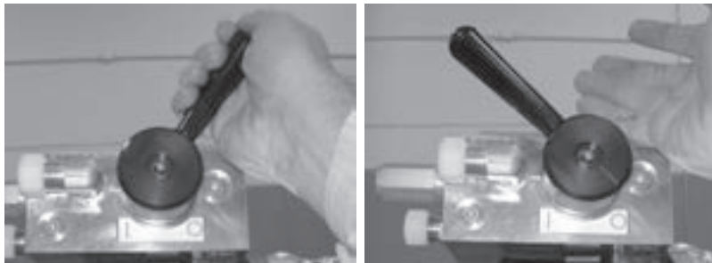
Figure 2-6. Appuyez sur le levier de commande hydraulique pour mettre en service la machine LCSF (à gauche). Lorsque vous relâchez ce levier (à droite), le moteur hydraulique s'arrête.
