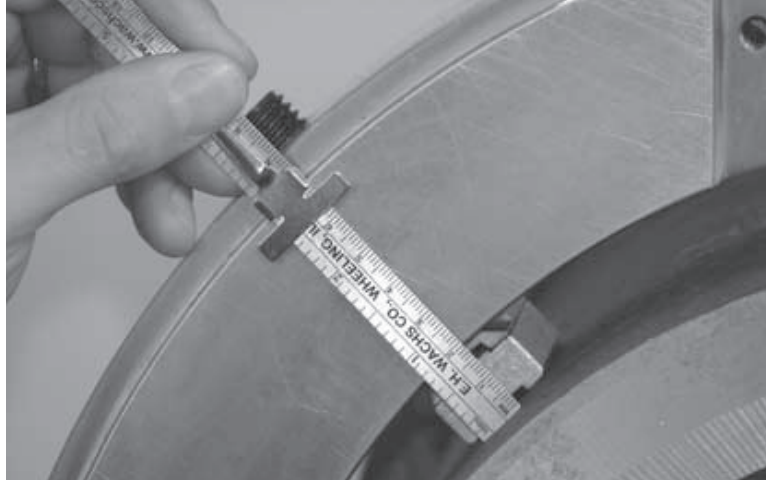
Figure 5-24. Mesurez l'espace à la cale d'appui la plus proche de la position "midi".
