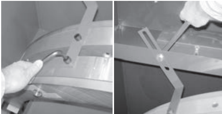
Figure 4-3. Pour sortir la machine de sa caisse, démontez les vis de fixation des équerres sur la machine (à gauche), puis démontez les vis des équerres sur la caisse (à droite).
