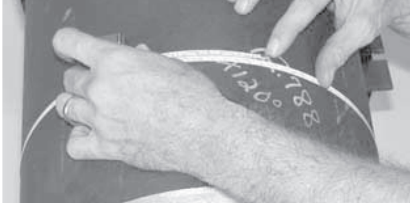
Figure 5-3. Mesurez la circonférence du tuyau.
