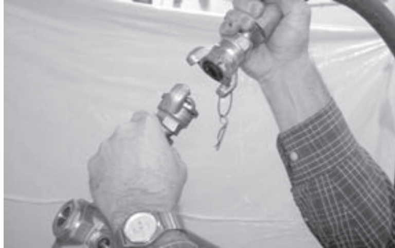
Figure 2-11. Débranchez l'alimentation pneumatique en déposant la canalisation pneumatique de la transmission pneumatique.
