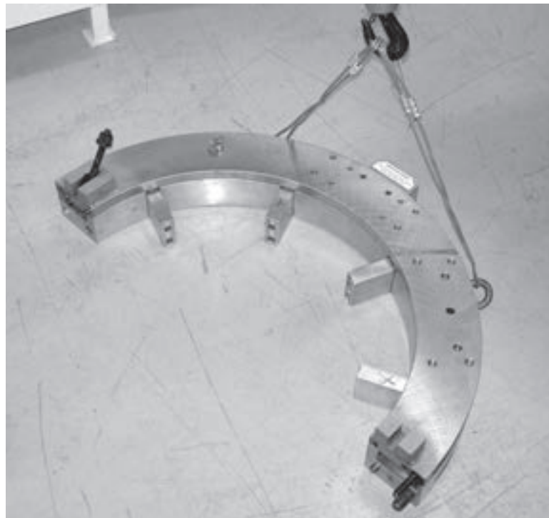
Figure 5-10. Posez la demi-couronne sur la surface de travail.
