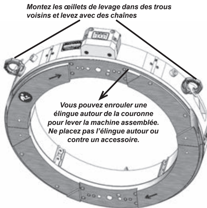
Figure 2-13. Lorsque vous levez la machine LCSF montée, utilisez les œillets de levage fournis. Vous pouvez également lever la machine en utilisant une élingue autour du rotor. (Machine 16", modèle 1016 représenté.)
