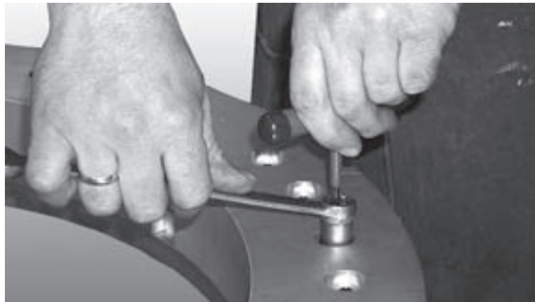
Figure 7-8. Tournez l'arbre du roulement dans le sens des aiguilles d'une montre avec la clé BTR et serrez l'écrou Nylstop.
