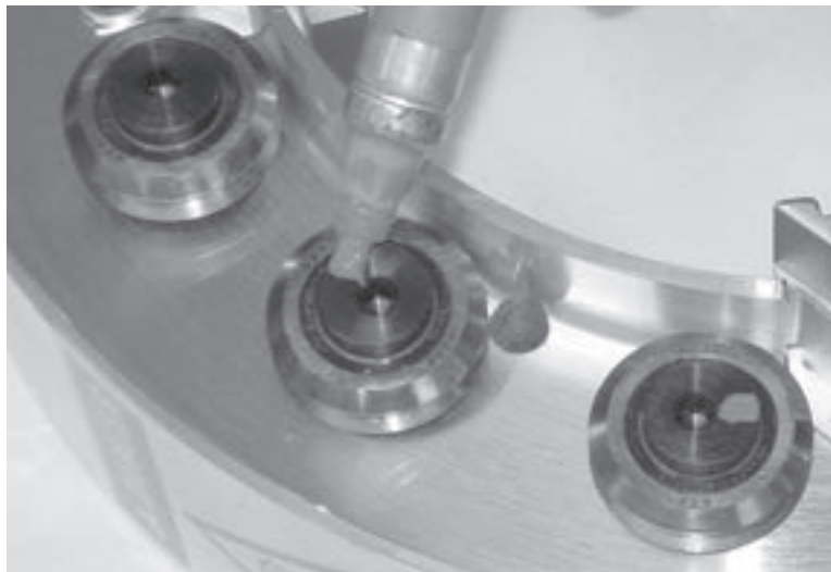
Figure 7-1. Marquez le côté de chaque roulement.
