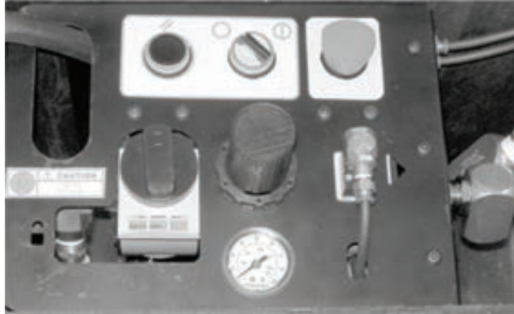
Figure 5-75. Les commandes du module ACM doivent être prêtes à fonctionner (voir la photo) avant de raccorder les canalisations pneumatiques
