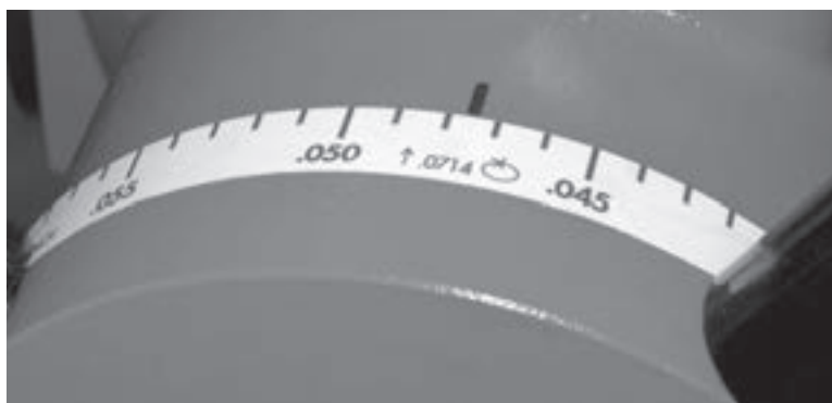
Figure 5-49. Utilisez les graduations sur le boîtier d'avance pour mesurer l'avance axiale.
