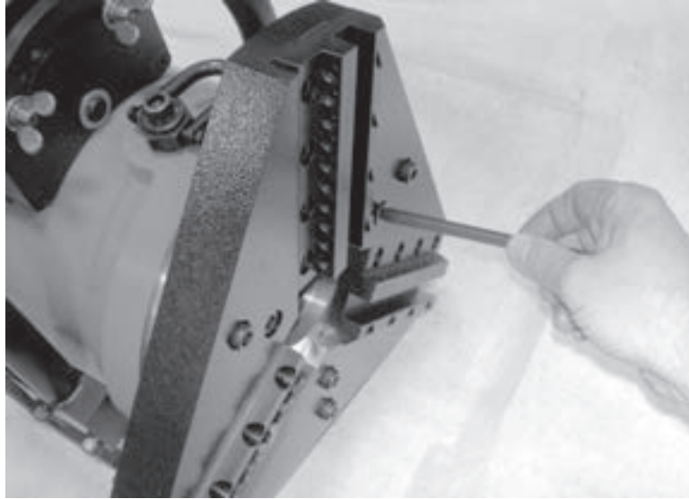
Figure 5-77. Serrez les 6 vis de fixation sur la tête rotative.
