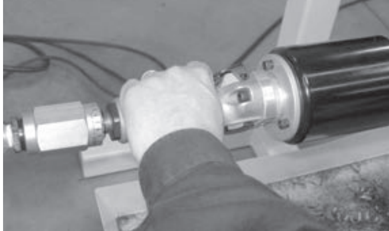
Figure 5-29. Appuyez sur le déclencheur du moteur pneumatique pour démarrer la machine.
