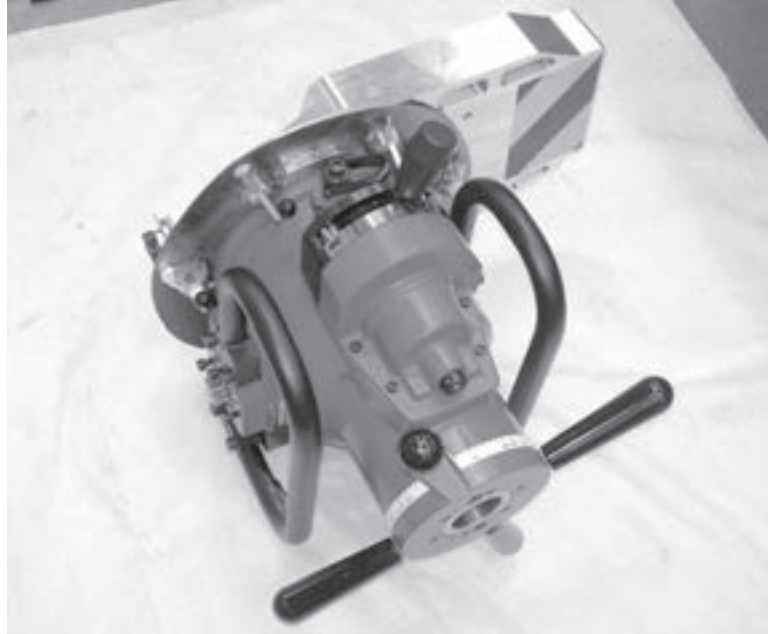
Figure 3-2. La photo illustre la configuration à dresser de la machine EP 424.
