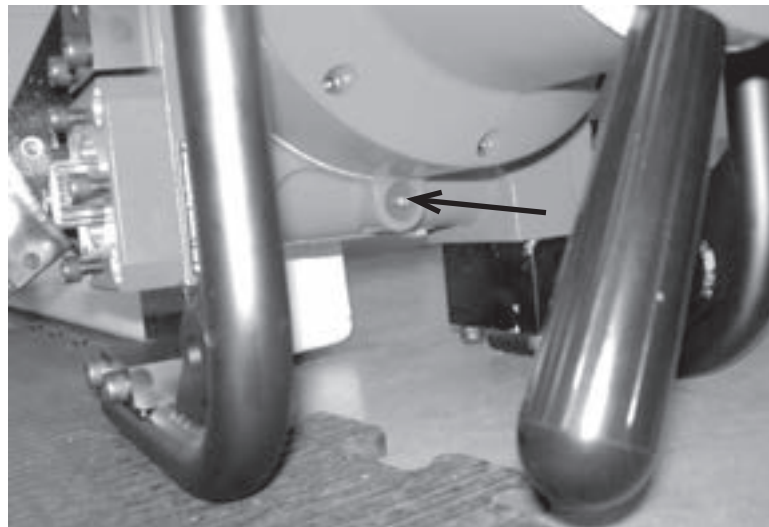
Figure 6-1. Tous les 30 jours (plus souvent en cas d'utilisation intensive), appliquez de la graisse dans le graisseur.
