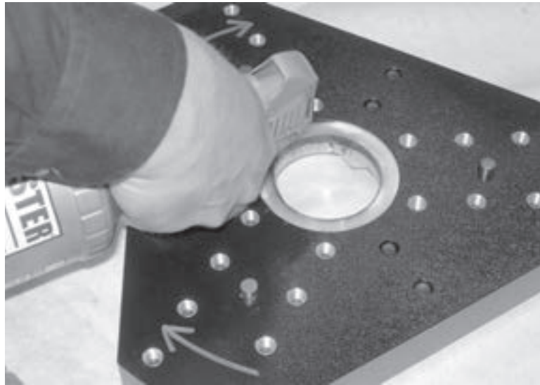
Figure 6-4. Appliquez de l'huile sur le racleur en feutre dans la tête rotative.
