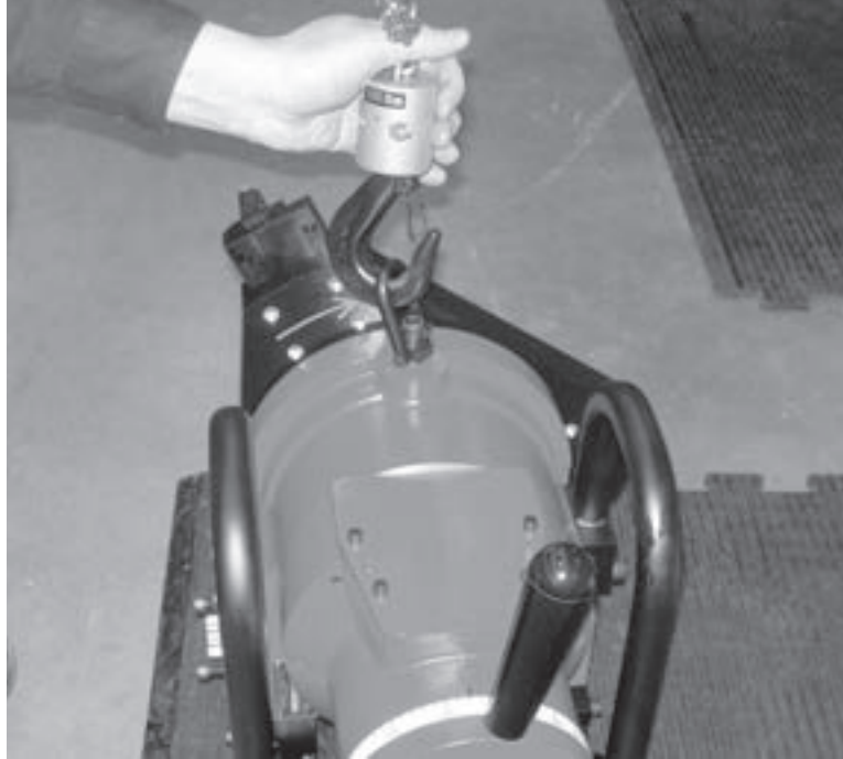
Figure 5-42. Fixez l'appareil de levage sur le crochet.
