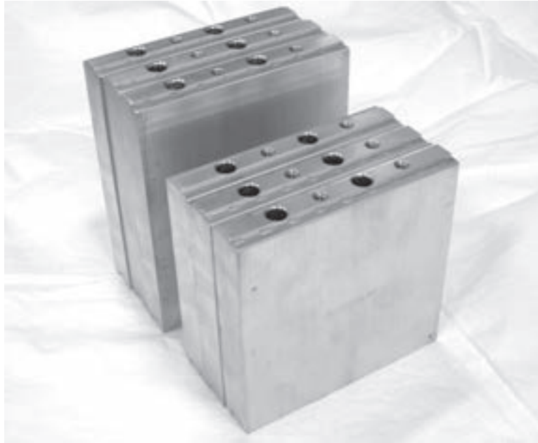
Figure 3-7. Deux jeux de cales d'extension permettent de monter le mandrin standard dans des tuyaux de diamètre extérieur 600,5 mm (23,64").
