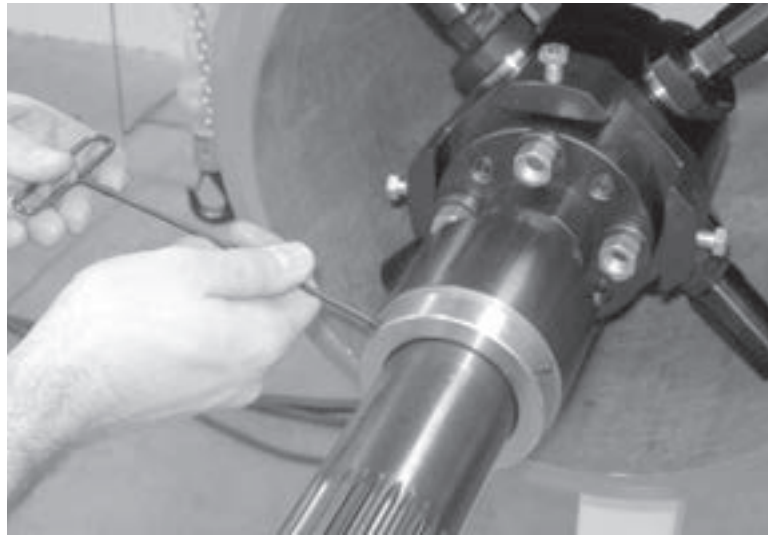
Figure 5-22. Placez la bague à proximité de la face du tuyau et serrez les vis de réglage pour la maintenir en place.
