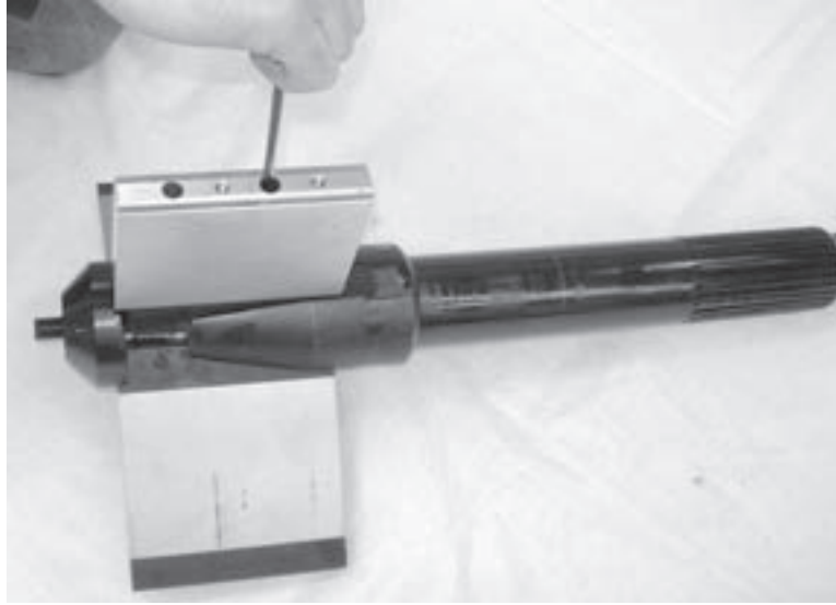
Figure 5-2. Vissez les vis captives dans le mandrin pour fixer les cales.
