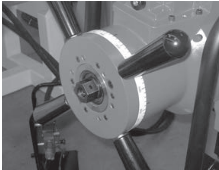
Figure 5-65. Engagez les filets du mandrin dans l'écrou d'avance pour réaliser un usinage stable.
