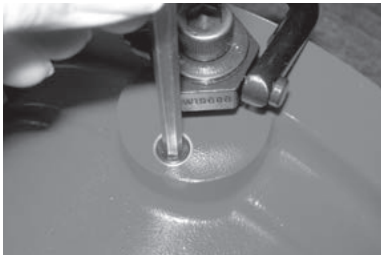
Figure 6-2. Démontez le bouchon avant de graisser le carter de la transmission principale.
