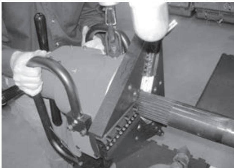
Figure 5-43. Positionnez la machine pour la monter sur le mandrin.
