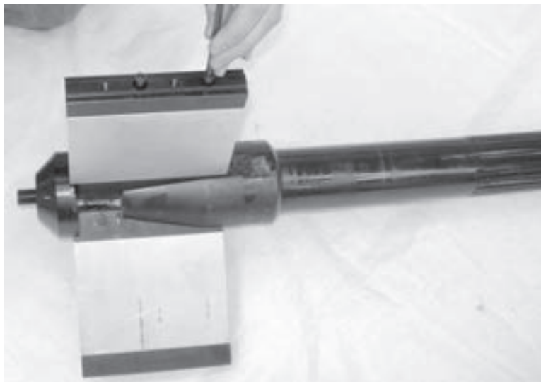
Figure 5-3. Utilisez les cales d'extension en acier (n°1 ou 2) au-dessus lorsque vous montez plusieurs cales.
