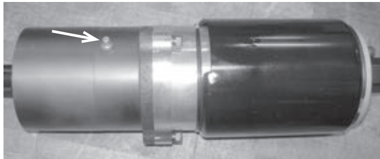
Figure 6-8. Graissez le moteur pneumatique une fois par mois.
