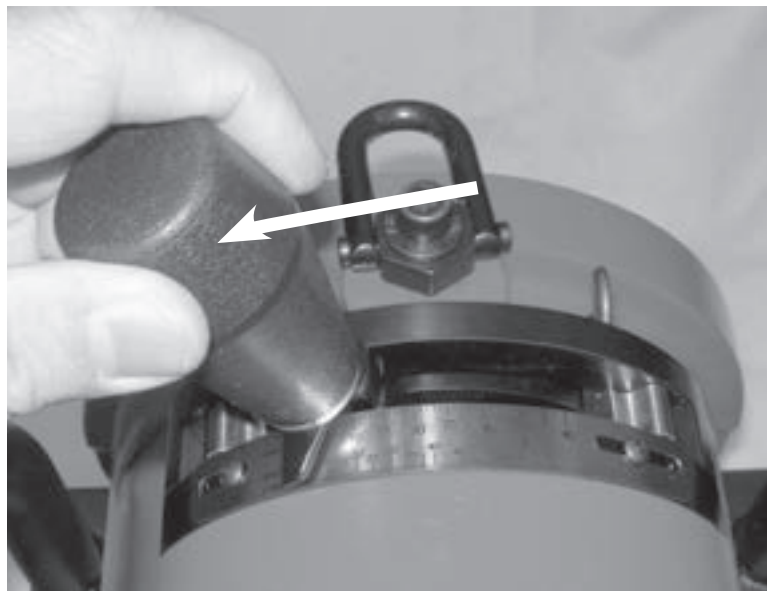
Figure 5-36. Réglez le sélecteur Speed Prep sur 0° avant tout usinage de forme.
