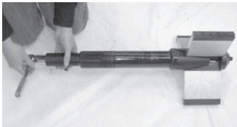
Figure 5-4. Tournez l'écrou de la barre de serrage dans le sens inverse des aiguilles d'une montre pour rentrer les cales d'appui.
