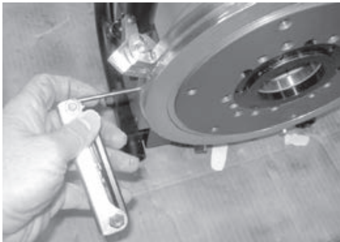
Figure 5-54. Montez l'ensemble déclencheur sur le châssis.
