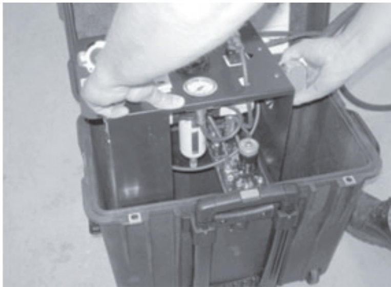
Figura 6-2. Togliere il pannello di controllo dall'involucro per la riparazione o per drenare l'acqua accumulata.
