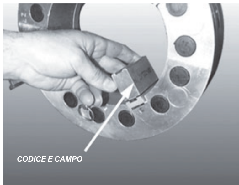
Figura 5-14. Installare le ganasce sui pattini.
