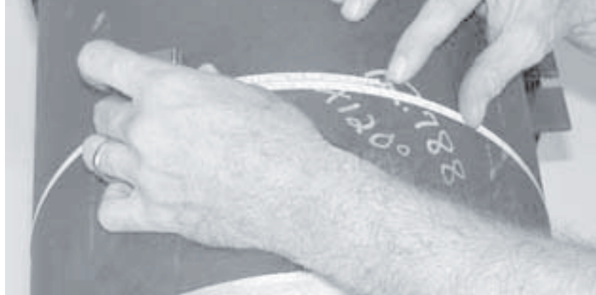
Figura 5-3. Verificare la circonferenza del tubo misurandola.
