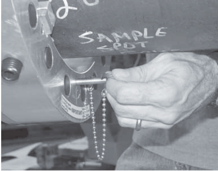
Figura 5-25. Rimuovere i perni di bloccaggio del telaio.
