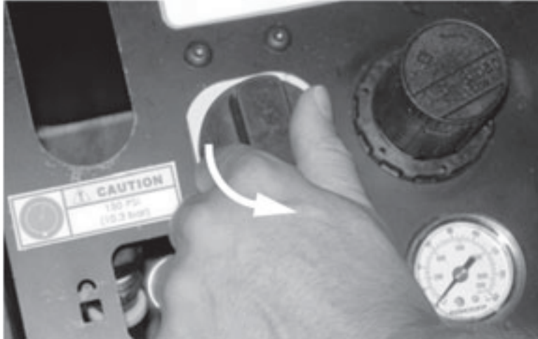
Figura 5-80. Girare la valvola ON/OFF in senso antiorario in posizione ON (mostrata in posizione OFF).
