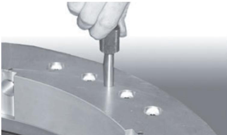
Figura 7-18. Inserire i perni di allineamento per impedire all'anello rotante di girare.
