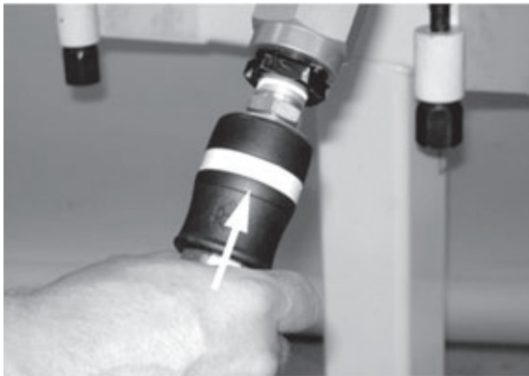
Figura 5-86. Spingere la disconnessione della linea dell'aria sul raccordo del motore pneumatico finché non scatta in posizione.
