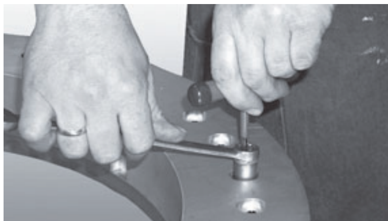
Figura 7-20. Girare l'albero in senso orario con la chiave esagonale, quindi serrare il dado nylock.
