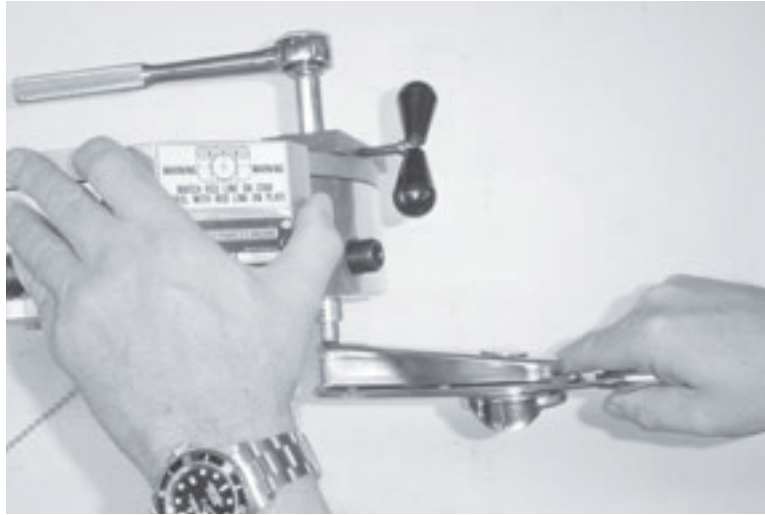
Figura 7-10. Fissare l'albero eccentrico.
