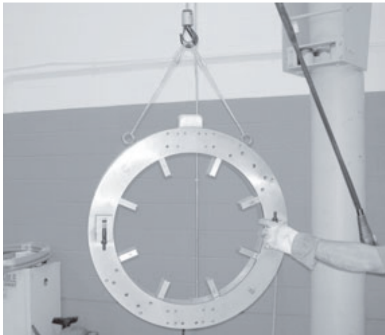
Figura 5-8. Sollevare la macchina montata come mostrato.
