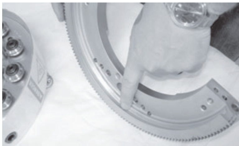
Figura 4-1. Verificare che la guida del cuscinetto non contenga trucioli e pulirla se necessario.
