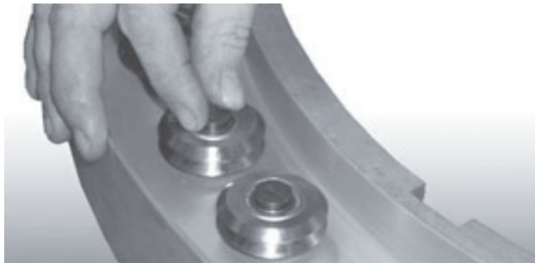
Figura 7-14. Ruotare gli alberi eccentrici in modo che il punto alto di ogni cuscinetto sia rivolto all'interno dell'anello.
