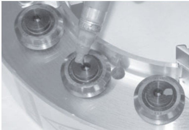
Figura 7-13. Contrassegnare il bordo di ogni cuscinetto.
