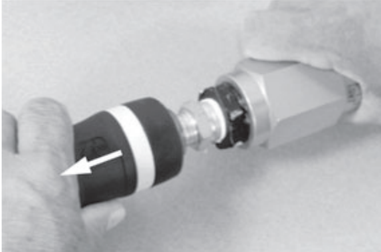
Figura 5-87. Per rilasciare la disconnessione, tirare indietro il collare. La disconnessione tornerà nella posizione di rilascio. (In questo modo l'aria si sfiata dalla linea.)
