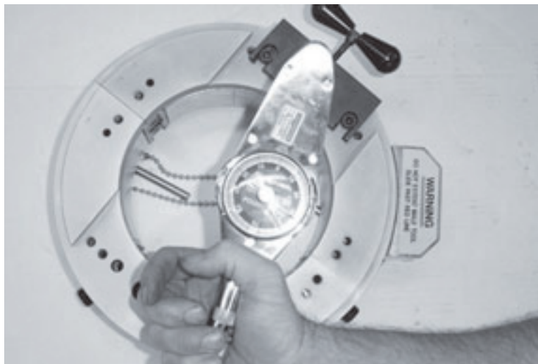
Figura 7-8. La piastra di fissaggio trattiene l'albero eccentrico mentre si porta la ruota del cuscinetto contro la scanalatura a V.
