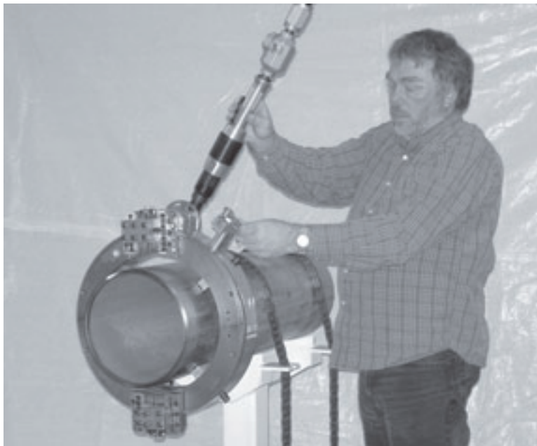
Figura 2-7. Se possibile, sostare in piedi dietro l'LCSF per tenersi a distanza dalle parti in movimento durante il funzionamento dei comandi.
