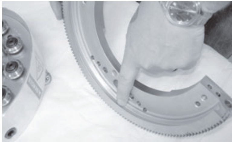
Figura 7-3. Ispezionare la scanalatura a V dell'anello rotante per identificare segni di usura o danno.
