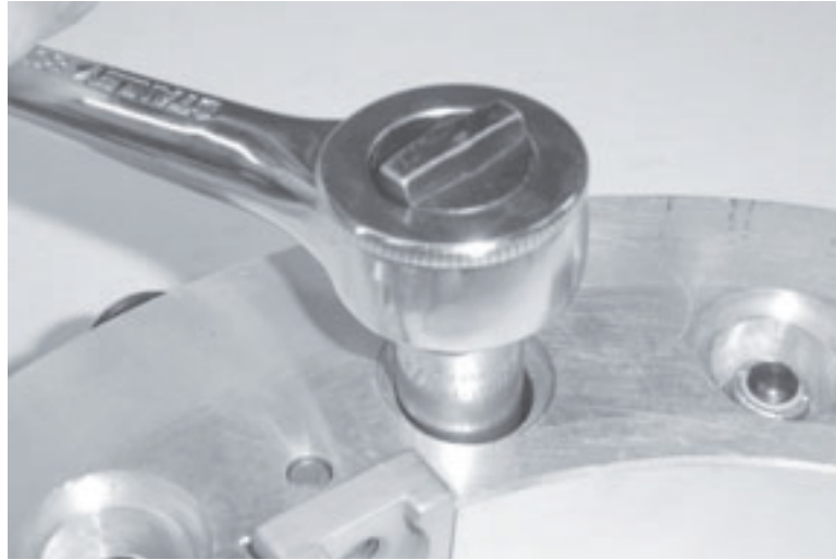
Figura 7-5. Allentare i dadi di bloccaggio.
