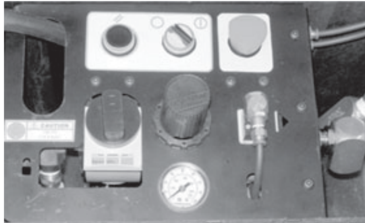
Figura 5-75. I comandi dell'ACM devono trovarsi nello stato pre-operazione, come illustrato, prima di collegare le linee dell'aria.
