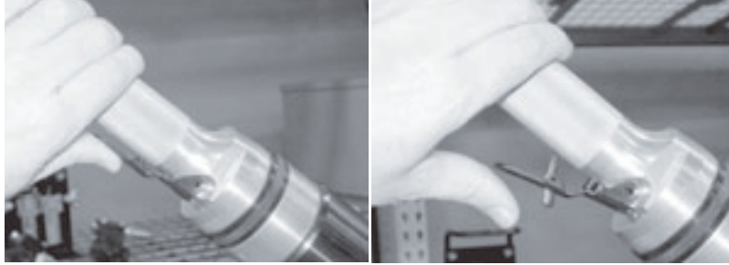
Figura 2-4. Premere l'azionamento motore pneumatico per avviare l'LCSF (sinistra). Quando lo si rilascia (destra), il motore pneumatico si spegne.
