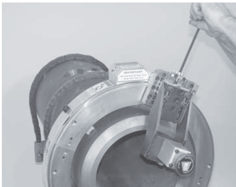
Figura 5-68. Regolare la slitta da svasatura ruotando la vite di avanzamento radiale in senso orario
