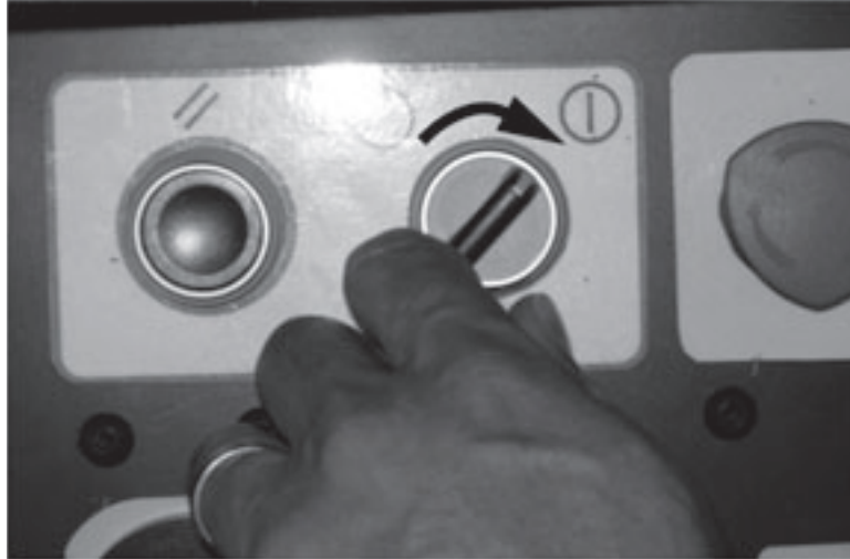
Figura 5-82. Girare l'interruttore Remote Enable per permettere il funzionamento mediante il telecomando.
