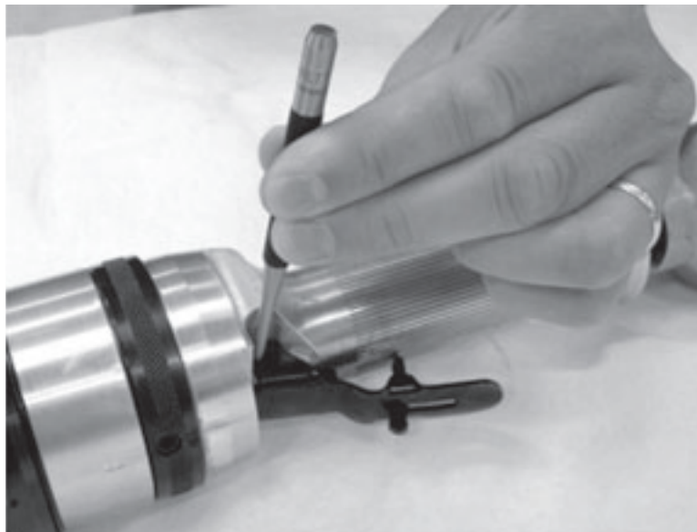
Figura 5-90. Utilizzare un punteruolo per estrarre il perno che trattiene l'azionamento aria.
