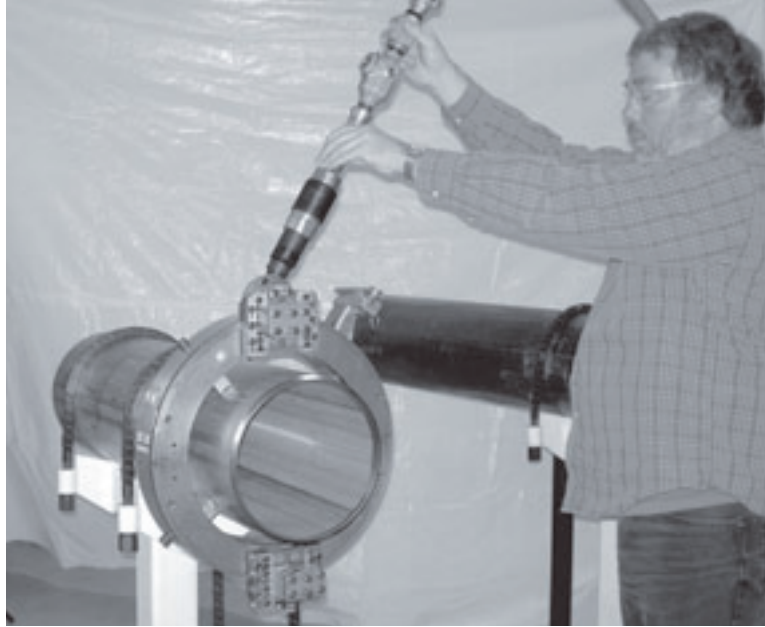
Figura 2-8. Durante il funzionamento dell'LCSF dalla parte anteriore, sostare a fianco della macchina per azionare i comandi senza estendersi sopra l'anello rotante.
