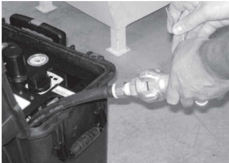
Figura 5-76. Collegare la linea dalla fonte dell'aria al connettore di ingresso sull'ACM.
