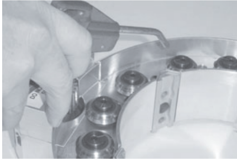
Figura 7-2. Rimuovere i detriti dall'anello fisso.
