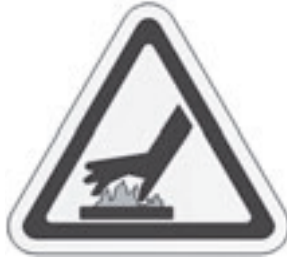
Figura 2-17. L'etichetta di superficie calda è affissa al motore dell'LCSF (pneumatico o idraulico). I componenti di trasmissione possono riscaldarsi fino a provocare ustioni. Assicurarsi che non siano caldi prima di toccarli. (Codice 90-403-00)
