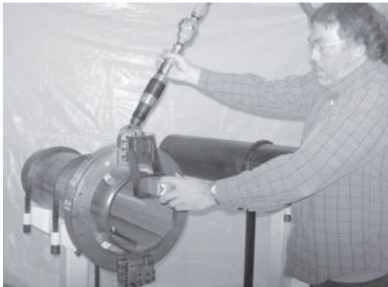
Figura 2-9. Quando si usano accessori che richiedono l'uso dei comandi (in figura con la slitta da svasatura universale), sostare in una posizione in cui sia possibile azionare la macchina senza entrare in contatto con le parti in movimento.
