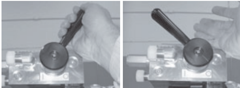
Figura 2-5. Spingere la leva idraulica per avviare l'LCSF (sinistra). Quando la si rilascia (destra), il motore idraulico si spegne.
