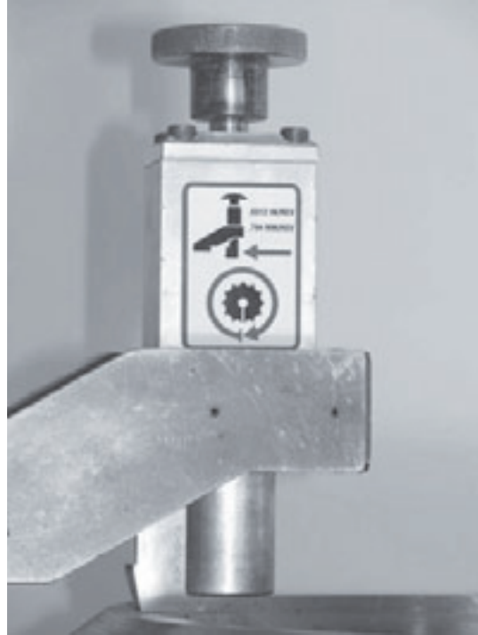
Figura 5-69. Regolazione assiale (0,0312) e radiale (0,0784) per rivoluzione
