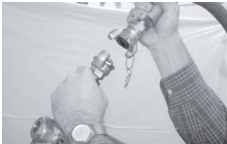
Figura 2-10. Scollegare l'alimentazione pneumatica rimuovendo la linea d'aria dall'azionamento pneumatico.
