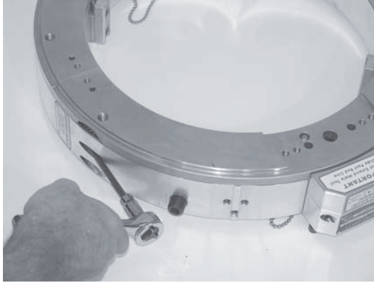
Abbildungen 5-16. Lösen Sie die unverlierbaren Schrauben, um die Hälften zu trennen.
