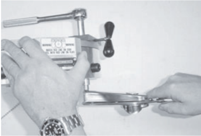
Abbildungen 7-10. Sichern Sie die Exzenterwelle.
