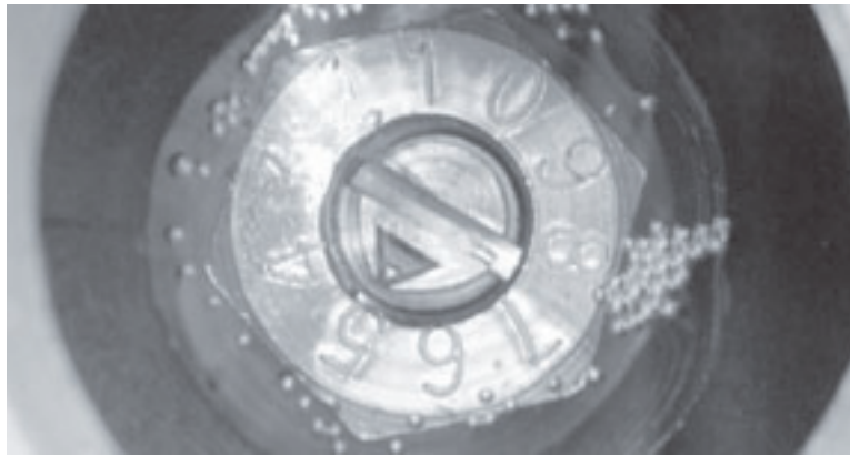
Abbildungen 6-1. Verwenden Sie die Schraube des Nadelventils, um die Tropfrate des Druckluftmotorölers einzustellen.
