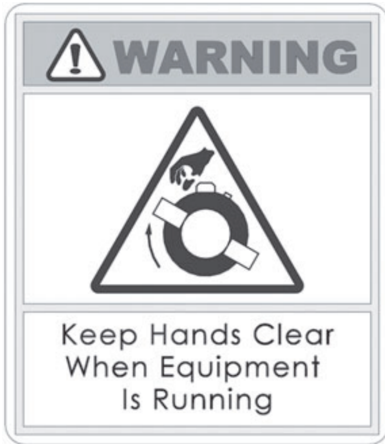
Abbildungen 2-19. Der Aufkleber "Hände entfernt halten" ist am festen Ring der LCSF befestigt. Halten Sie sich beim Betrieb der LCSF von beweglichen Teilen entfernt. (Artikelnummer 60-363-00.)
