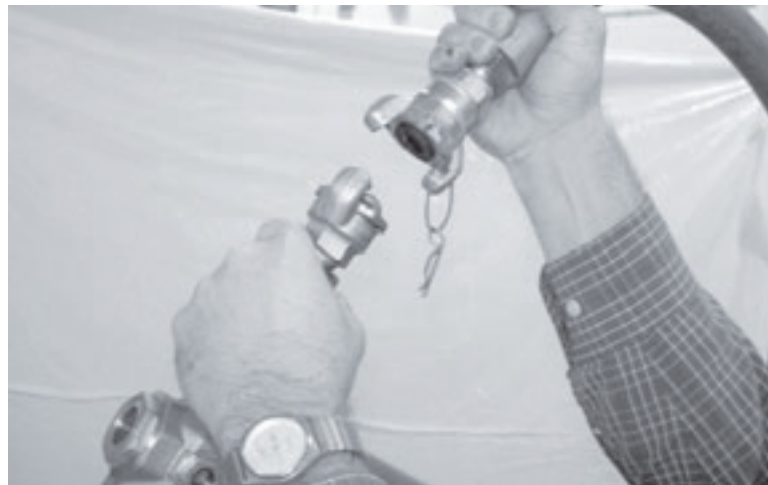
Abbildungen 2-10. Trennen Sie die pneumatische Energie, indem Sie die Druckluftleitung vom Druckluftantrieb entfernen.
