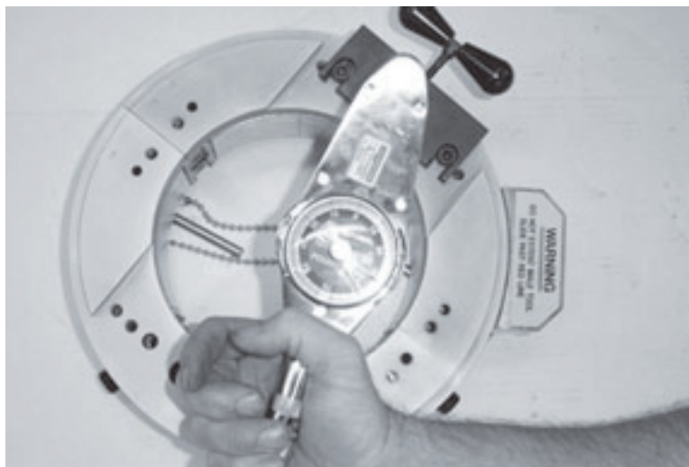
Abbildungen 7-8. Die Befestigungsplatte hält die Exzenterwelle, während Sie das Lagerrad gegen die V-Nut einstellen.
