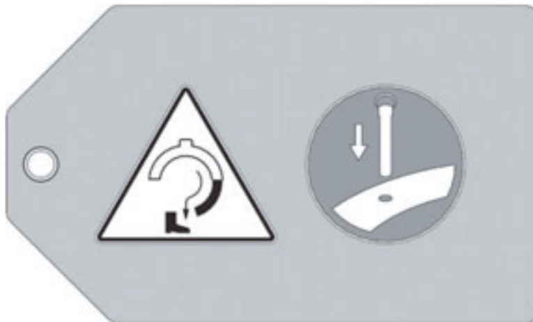
Abbildungen 2-20. Der Anhänger mit dem Ausrichtungsstift ist am Ring des Ausrichtungsrings befestigt. Stellen Sie sicher, die Stifte vor dem Trennen der Maschine einzuführen. (Artikelnummer 60-1274-00.)
