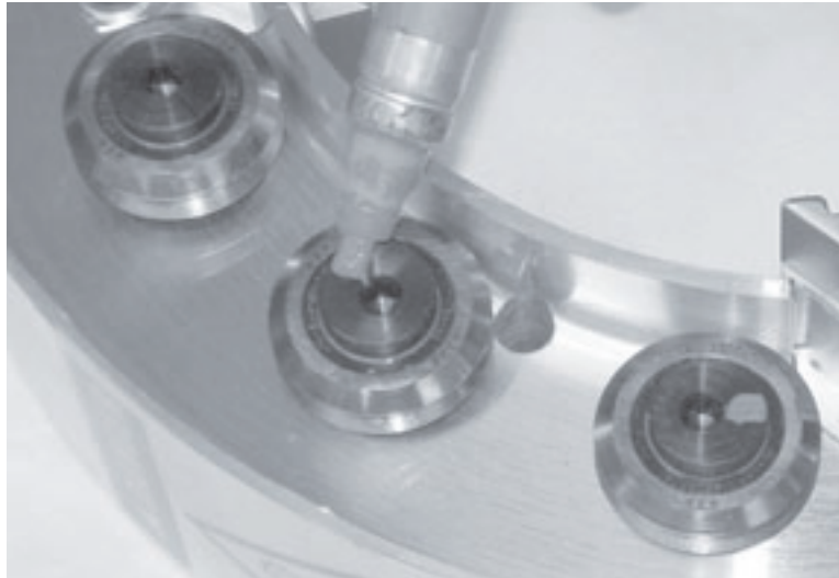
Abbildungen 7-13. Markieren Sie die Kante jedes Lagers.
