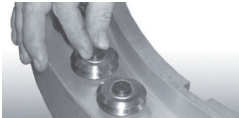
Abbildungen 7-14. Drehen Sie die Exzenterwellen so, dass der Gipfelpunkt jedes Lagers ins Innere des Rings zeigt.
