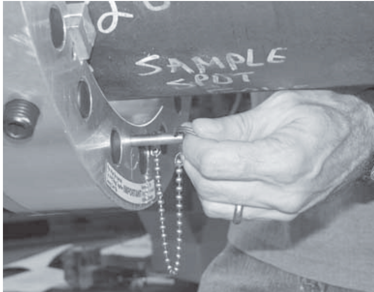
Abbildungen 5-25. Entfernen Sie die Rahmen-Sicherungsstifte.
