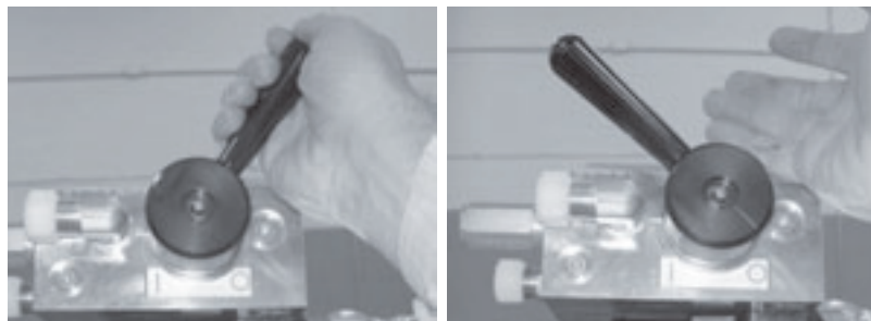
Abbildungen 2-5. Halten Sie den Hydraulikhebel, um die LCSF (links) zu betreiben. Bei Loslassen des Hebels (rechts) schaltet sich der Hydraulikmotor aus.
