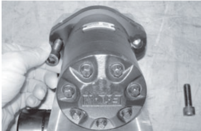
Abbildungen 5-47. Entfernen Sie die Schrauben des Hydraulikantriebs, um den Antriebsmotor vom Adapter abzubauen.
