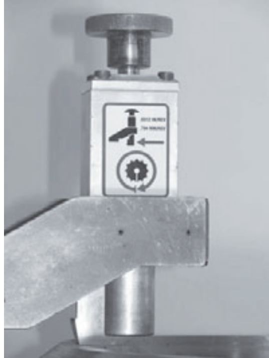
Abbildungen 5-69. Axiale (0,0312) und radiale (0,0784) Einstellung pro Umdrehung.
