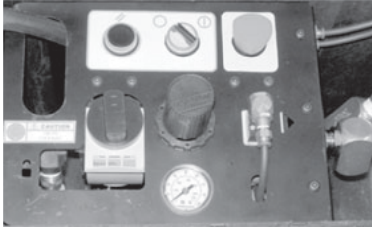
Abbildungen 5-75. Die ACM-Steuerungen sollten sich in dem Zustand vor Inbetriebnahme befinden, bevor die Druckluftleitungen angeschlossen werden.
