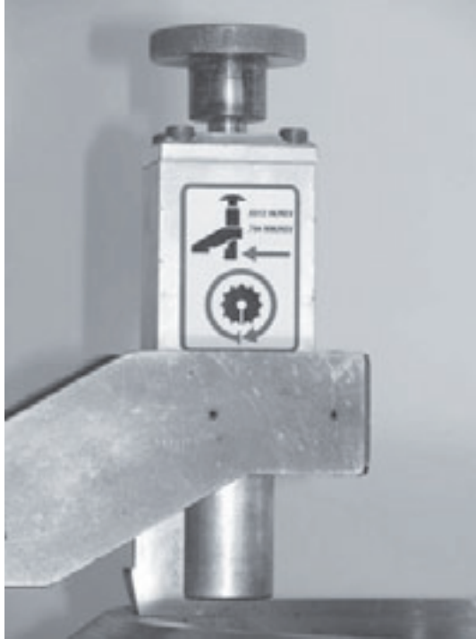
Abbildungen 5-69. Axiale (0,0312) und radiale (0,0784) Einstellung pro Umdrehung.
