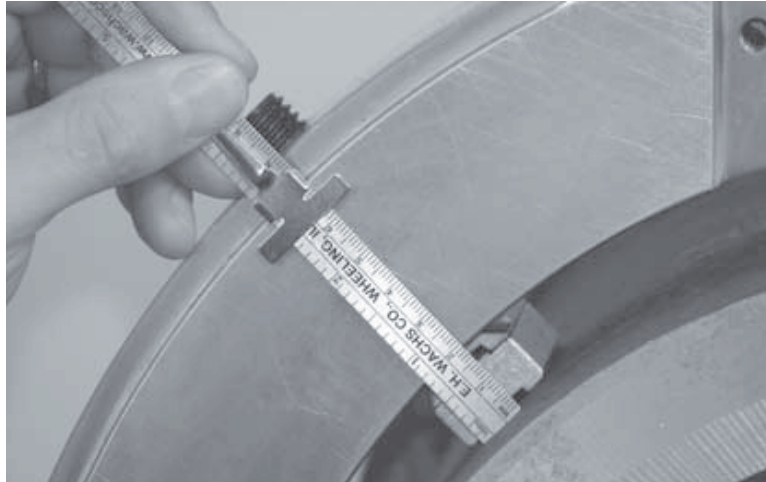
Abbildungen 5-24. Messen Sie die Lücke am Spannfuß in der Nähe der 12-Uhr-Position.
