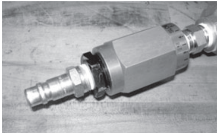
Abbildungen 5-89. Montieren Sie den mitgelieferten Nippel am Druckluftmotor zur Verwendung mit dem ACM.
