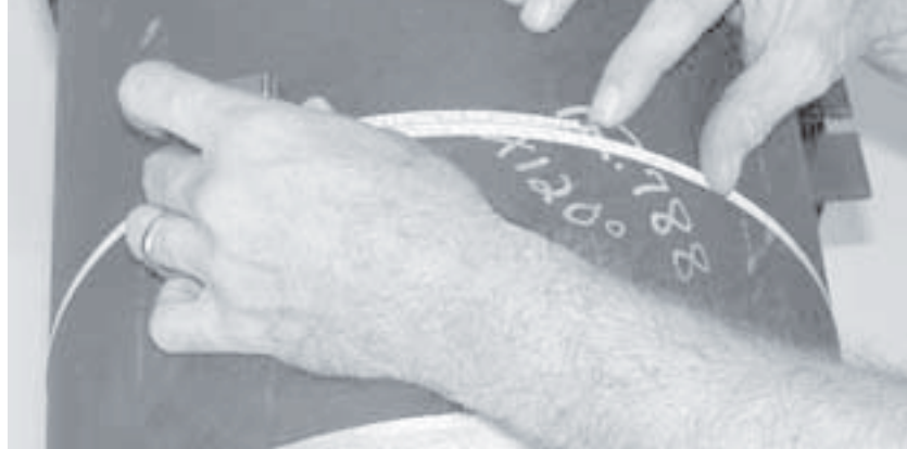
Abbildungen 5-3. Überprüfen Sie den Rohrumfang durch Nachmessen.
