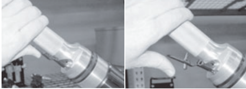
Abbildungen 2-5. Halten Sie den Druckluftmotorauslöser, um die LCSF (links) zu betreiben. Bei Loslassen des Auslösers (rechts) schaltet sich der Druckluftmotor aus.
