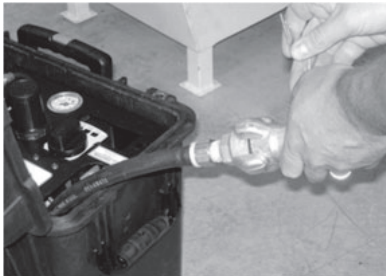
Abbildungen 5-76. Schließen Sie die Leitung von der Druckluftversorgung an dem Eingangsanschluss des ACM an.
