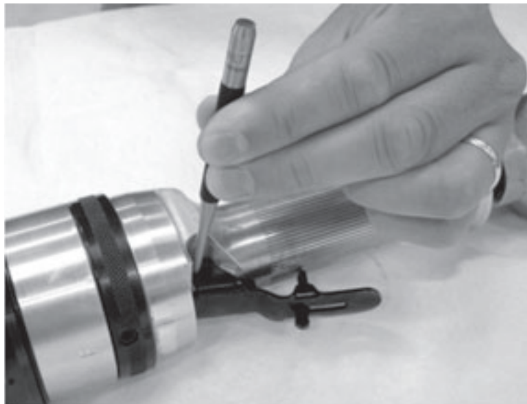
Abbildungen 5-90. Verwenden Sie einen Dorn, um den Stift herauszutreiben, mit dem der Druckluftauslöser befestigt ist.
