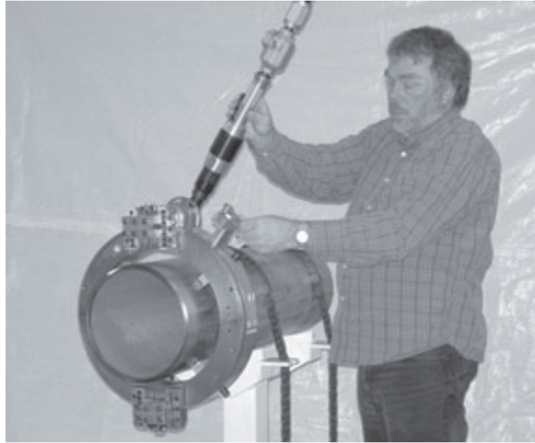
Abbildungen 2-8. Stellen Sie sich möglichst hinter die LCSF, um sich während der Bedienung der Steuerungen von beweglichen Teilen entfernt zu halten.
