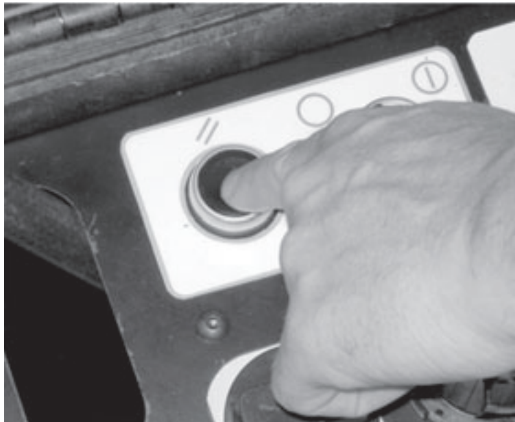
Abbildungen 5-81. Die Reset-Taste setzt das ACM nach einem Druckverlust oder einer Notausschaltung wieder zurück.
