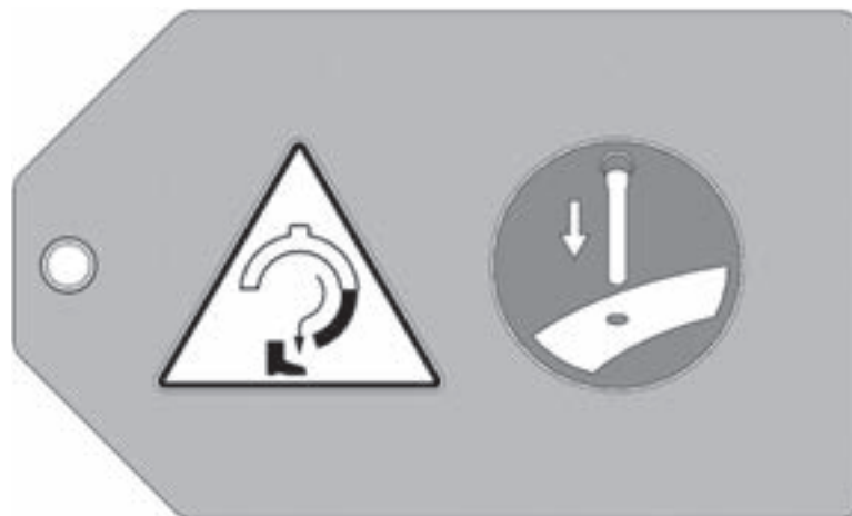
Abbildungen 2-21. Der Anhänger mit dem Ausrichtungsstift ist am Ring des Ausrichtungsrings befestigt. Stellen Sie sicher, die Stifte vor dem Trennen der Maschine einzuführen. (Artikelnummer 60-1274-00.)
