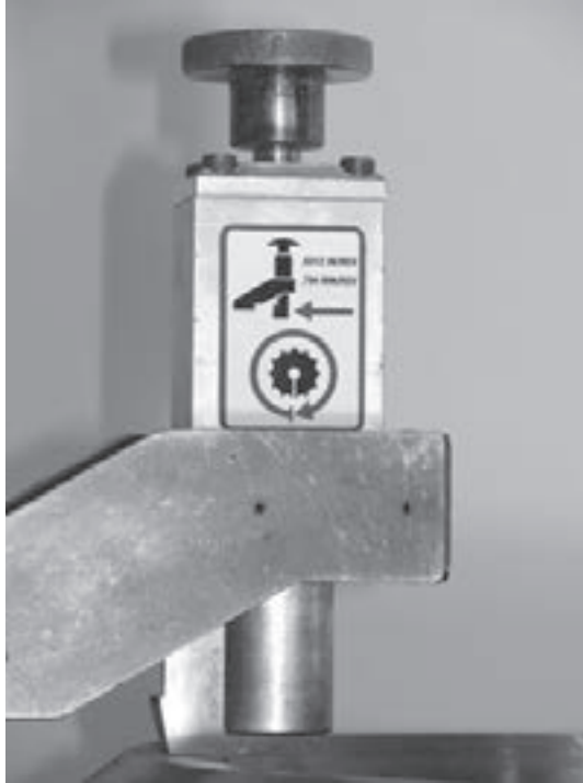
Abbildungen 5-69. Axiale (0,0312) und radiale (0,0784) Einstellung pro Umdrehung.
