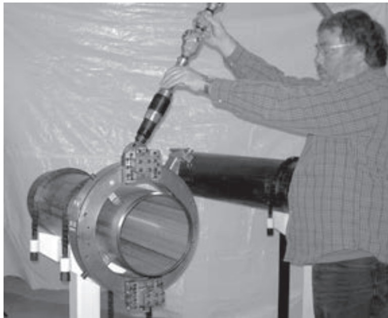
Abbildungen 2-9. Stellen Sie sich beim Betrieb der LCSF von vorne auf die Seite der Maschine, um die Steuerungen zu bedienen, ohne über den Drehring greifen zu müssen.
