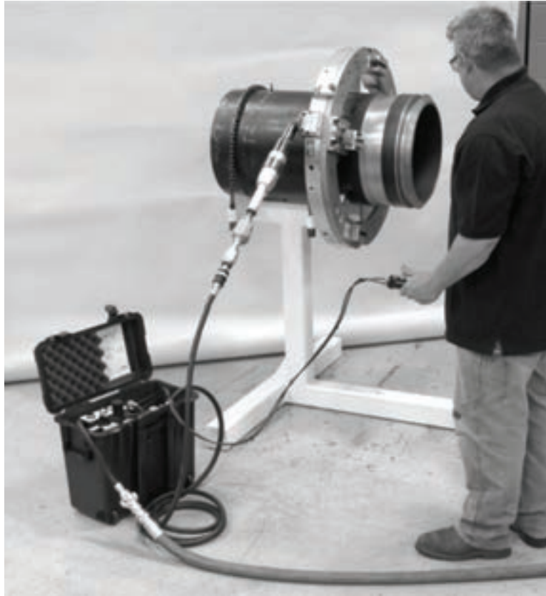
Abbildungen 5-74. Stellen Sie das ACM in einem geeigneten Abstand von der Split Frame Maschine auf.
