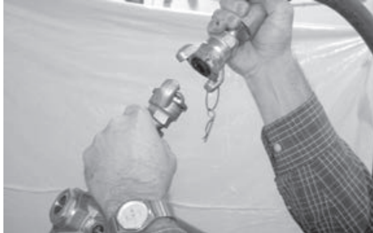
Abbildungen 2-11. Trennen Sie die pneumatische Energie, indem Sie die Druckluftleitung vom Druckluftantrieb entfernen.
