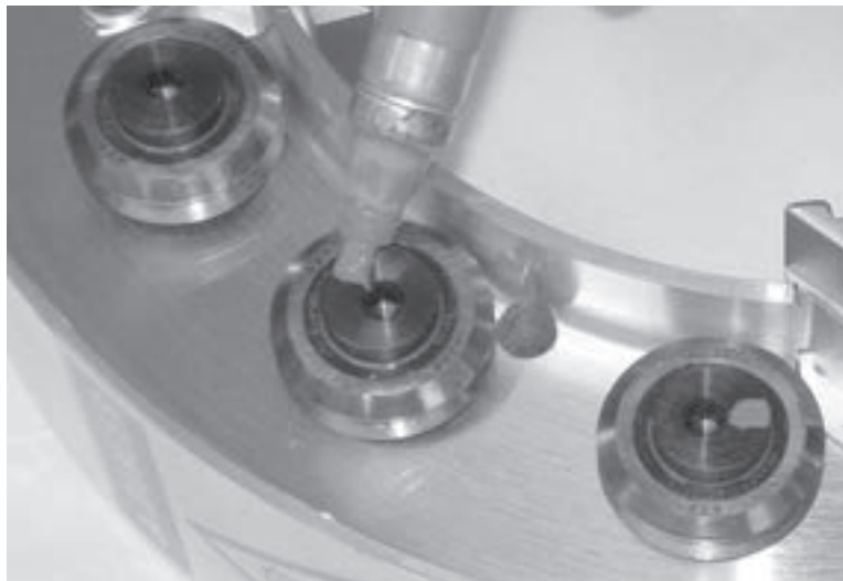
Abbildungen 7-1. Markieren Sie die Kante jedes Lagers.
