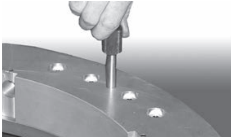
Abbildungen 7-6. Führen Sie Ausrichtungsstifte ein, um eine Drehung des Drehrings zu verhindern.
