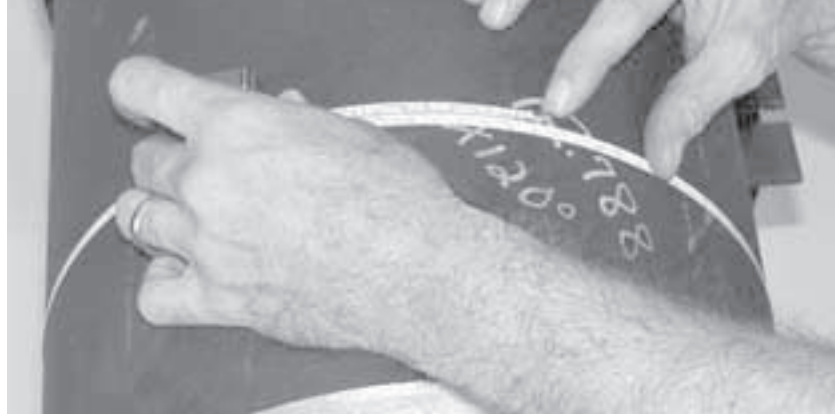
Abbildungen 5-3. Überprüfen Sie den Rohrumfang durch Nachmessen.
