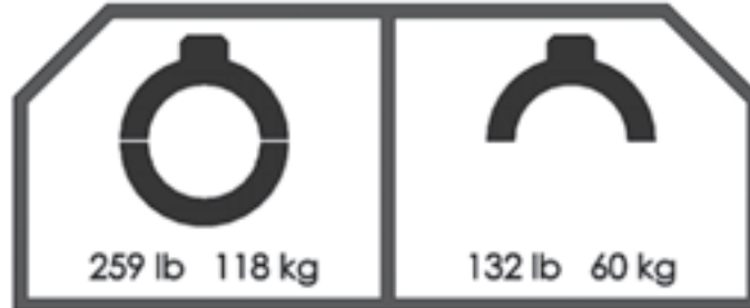
Abbildungen 2-19. Die Gewichtsaufkleber der LCSF sind am Antriebsgehäuse befestigt. Die Gewichte und Artikel-Nr. variieren je nach LCSF-Modell. (Artikelnummer 60-1279-XX.)
