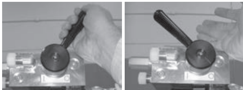
Abbildungen 2-6. Halten Sie den Hydraulikhebel, um die LCSF (links) zu betreiben. Bei Loslassen des Hebels (rechts) schaltet sich der Hydraulikmotor aus.
