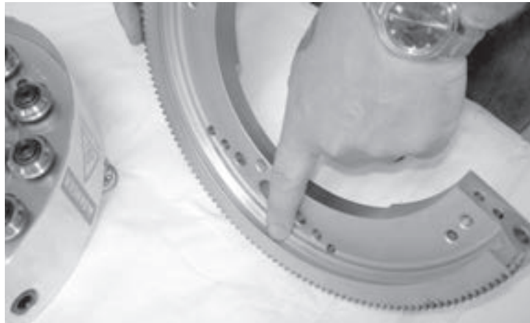
Abbildungen 4-1. Prüfen Sie die Lagerlaufbahnen auf Späne und reinigen Sie diese gegebenenfalls.
