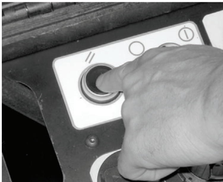
Рис. 5-81. Нажатие кнопки Reset («Сброс») производит возврат ПБУ к исходным параметрам после потери давления в линии или аварийного останова.
