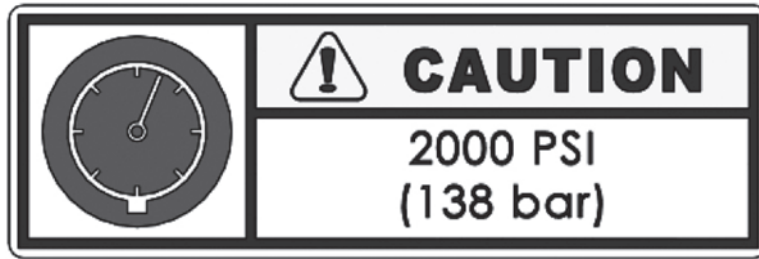
Рис. 2-17. Наклейка с информацией о давлении гидравлической жидкости прикреплена к гидравлическому двигателю соответствующих моделей НППА. Запрещается эксплуатировать оборудование при гидравлическом давлении выше 2000 фунт/дюйм 2 (138 бар). (Артикул 90-402-01).
