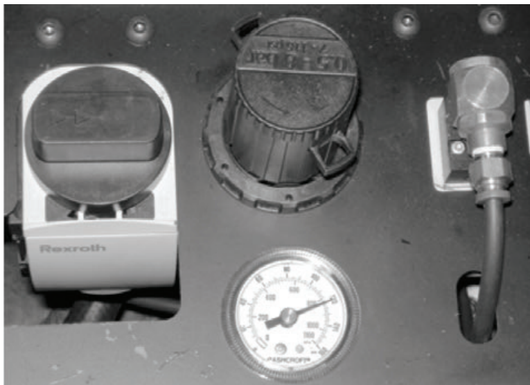
Рис. 5-85. Поворачивание рукоятки регулирования давления без вытягивания вверх открывает стопорные выступы. Вденьте замок сквозь выступы для предотвращения изменения уставки давления.
