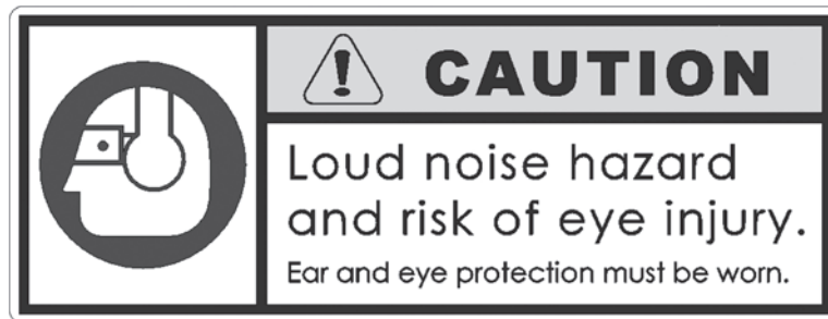
Рис. 2-15. Наклейка с информацией о мерах по защите органов слуха и зрения прикреплена к приводному двигателю НПРА. Во время эксплуатации оборудования следует обязательно использовать средства защиты органов слуха и зрения. (Артикул 90-401-03).
