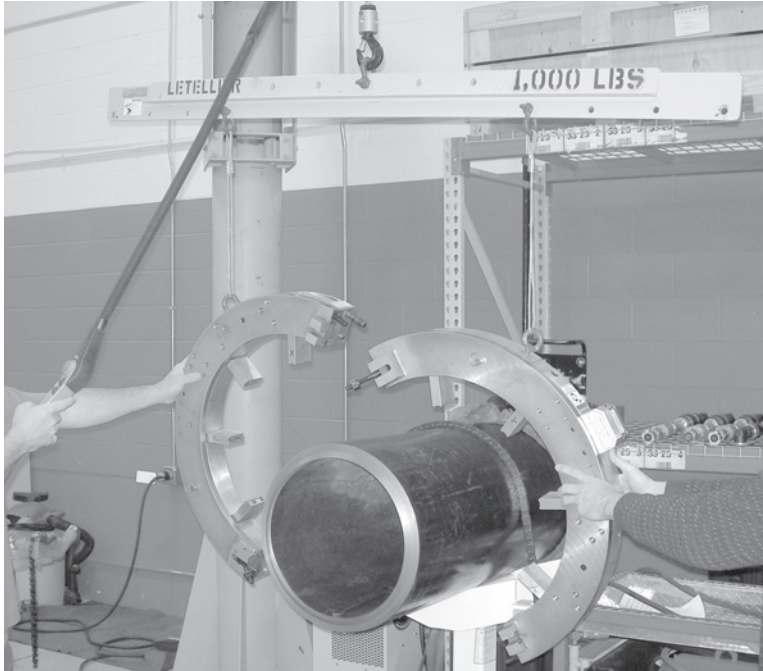
Рис. 5-12. Соберите половины агрегата вокруг трубы, см. изображение.
