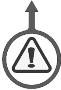
Рис. 2-22. Наклейка с указанием места расположения центрирующего штифта прикреплена для упрощения поиска отверстий для вставки данных штифтов. На агрегате размещены две наклейки, по одной на штифт. (Артикул 60-1275-00).
