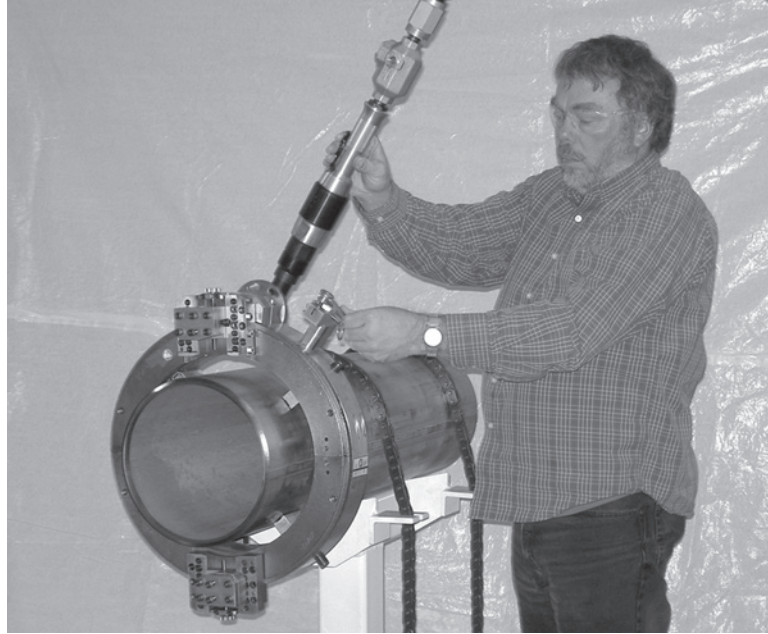
Рис. 2-8. По мере возможности следует располагаться за НПРА для предотвращения непреднамеренного контакта с подвижными частями во время работы агрегата.
