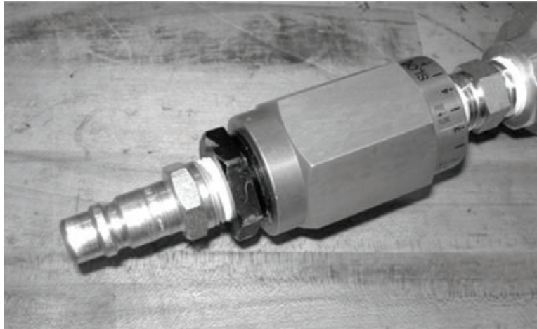
Рис. 5-89. Установите специальный штуцер из комплекта поставки для возможности использования пневматического двигателя с ПБУ.
