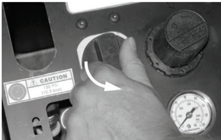
Рис. 5-80. Поверните двухпозиционный клапан против часовой стрелки в положение ON («Вкл.») - показано в положении OFF («Выкл.»).
