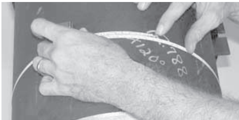
Рис. 5-3. Проверьте окружность трубы измерением.
