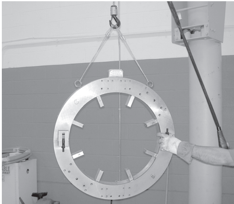
Рис. 5-8. Подъем собранного агрегата производится согласно показанному на изображении.
