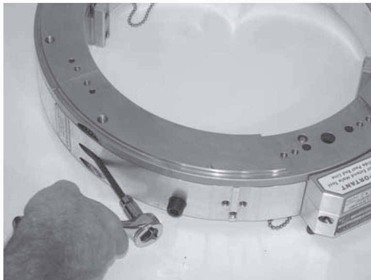
Рис. 5-16. Отверните невыпадающие винты для разъема половин агрегата.
