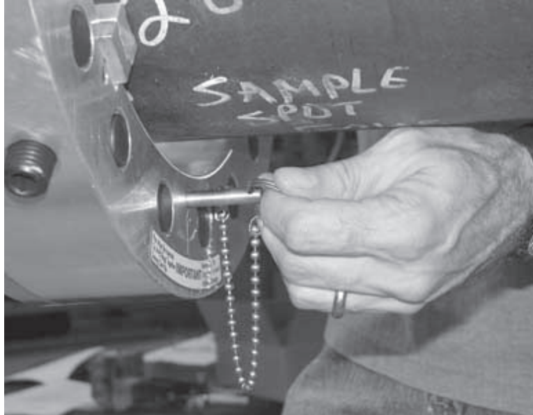
Рис. 5-25. Извлеките фиксирующие станину штифты.
