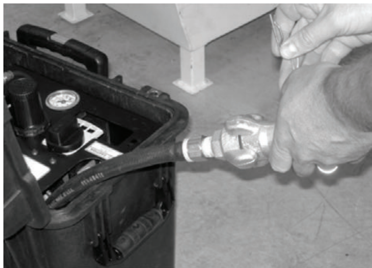
Рис. 5-76. Соедините линию от источника подачи сжатого воздуха к впускному патрубку ПБУ.
