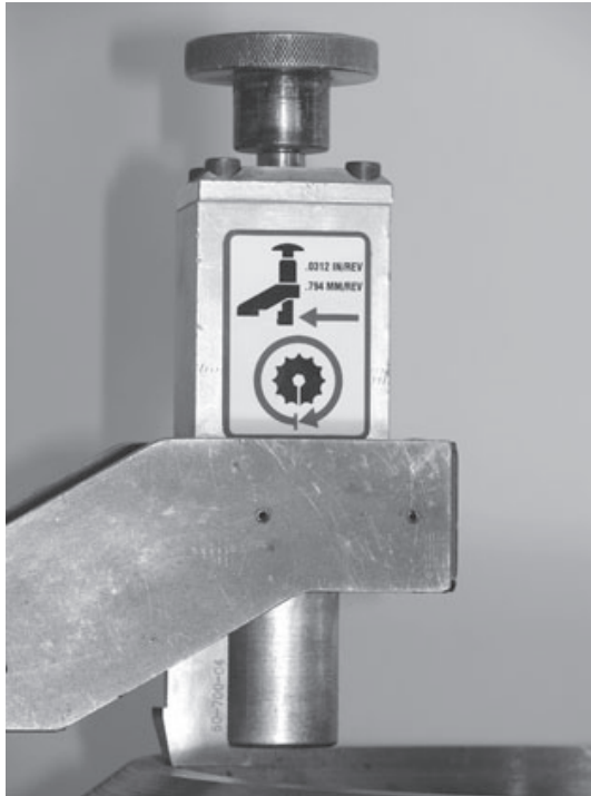
Рис. 5-69. Регулировка осевой ( 0,0312'' / 0,79248 \text{ мм} ) и радиальной ( 0,0784'' / 1,99136 \text{ мм} ) подачи на оборот.
