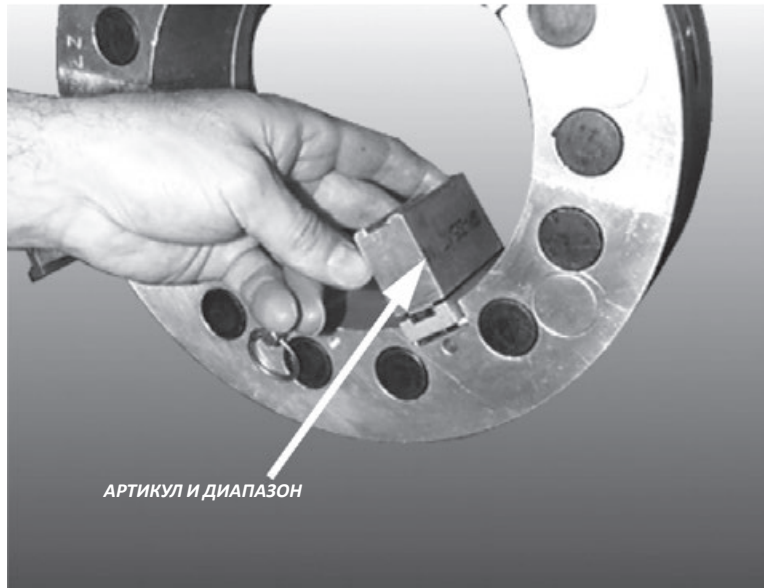
Рис. 5-14. Установите зажимные механизмы в зажимные блоки.
