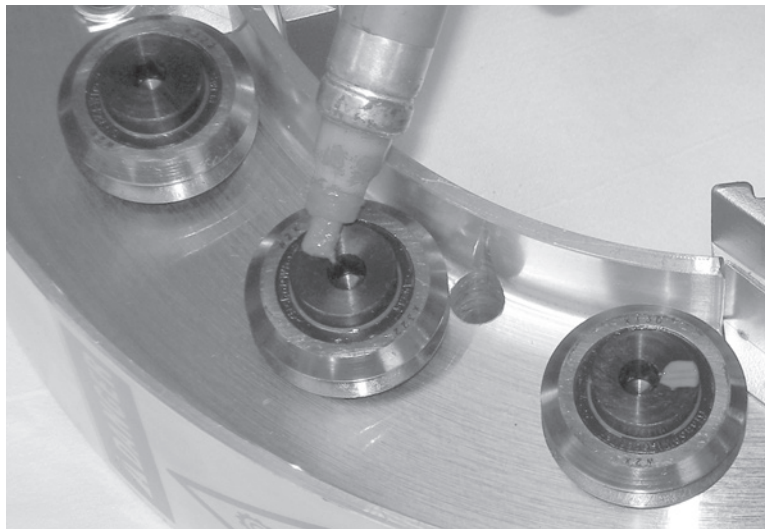
Рис. 7-1. Проставьте отметку на кромках всех подшипников.
