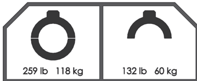
Рис. 2-19. Наклейки с информацией о массе низкопрофильного разъёмного агрегата размещены на корпусе ведущей шестерни. Масса агрегата и артикул отличаются для разных моделей. (Артикул 60-1279-XX).
