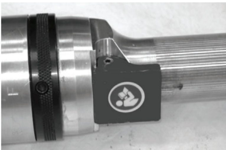
Рис. 5-93. На фотографии показана корректная установка открытой дроссельной заслонки.
