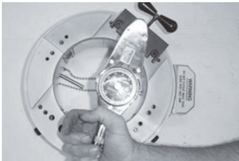
Рис. 7-8. Фиксирующая пластина будет удерживать эксцентриковый вал во время посадки ролика подшипника в V-образной канавке.
