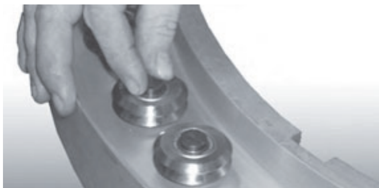
Рис. 7-14. Проверните все эксцентриковые валы для установки верхних точек подшипников по направлению к внутренней части неподвижной платформы.
