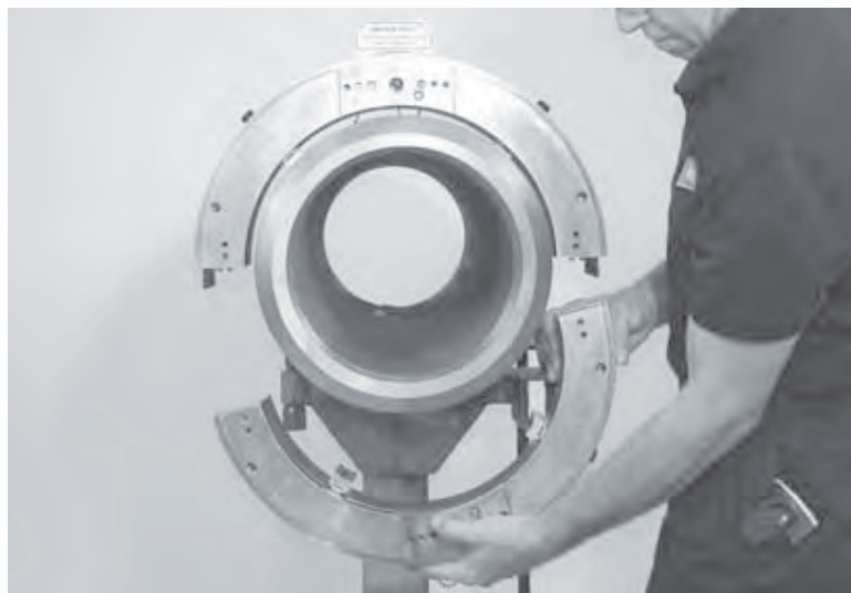
Рис. 5-19. Соберите половины агрегата на трубе.
