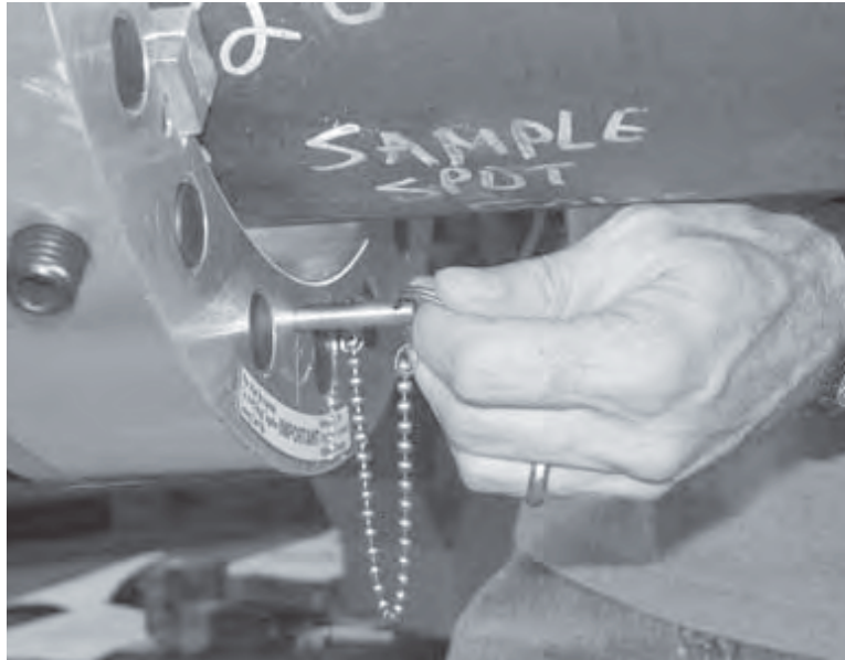
Рис. 5-25. Извлеките фиксирующую станину штифты.
