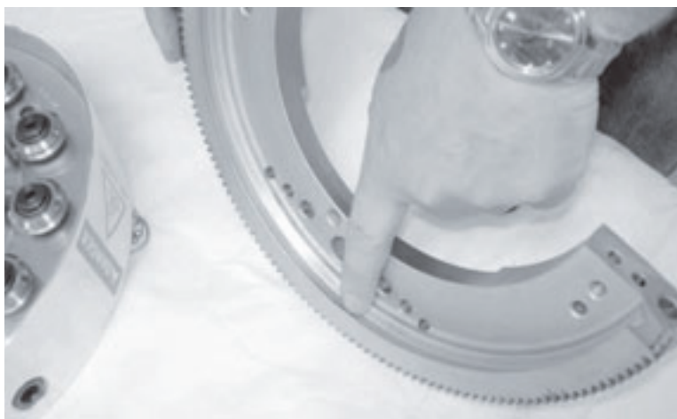
Рис. 4-1. Проверьте желоб подшипника и очистите от металлической стружки, по мере необходимости.
