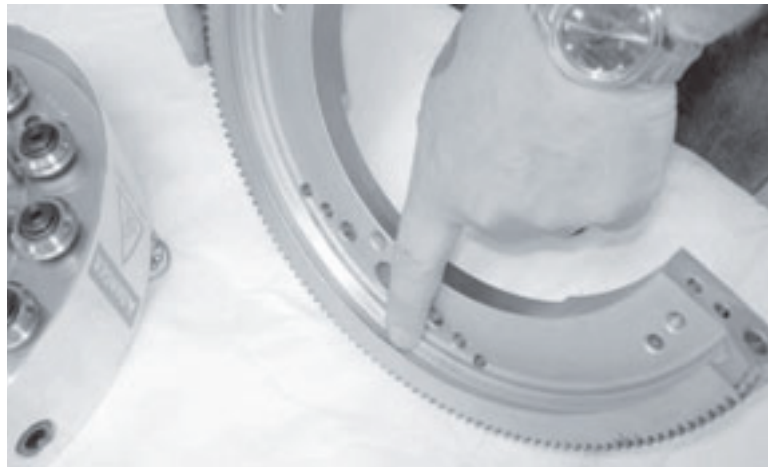
Рис. 7-3. Осмотрите V-образную канавку вращающейся платформы на наличие признаков износа.
