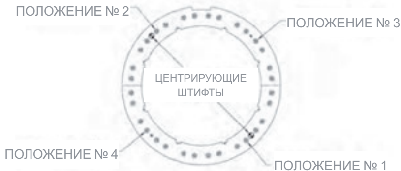
Рис. 7-19. Отрегулируйте подшипники надлежащим образом в указанных точках.
