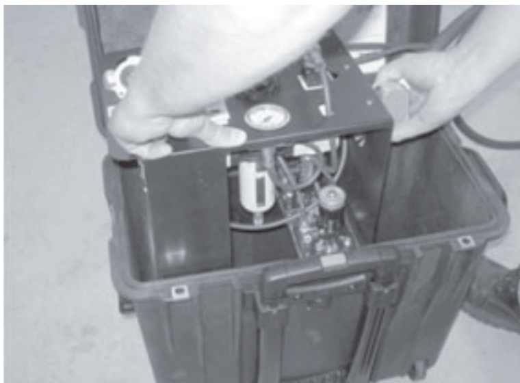
Рис. 6-2. Извлеките панель управления из корпуса для проведения сервисного обслуживания или слива скопившейся воды.
