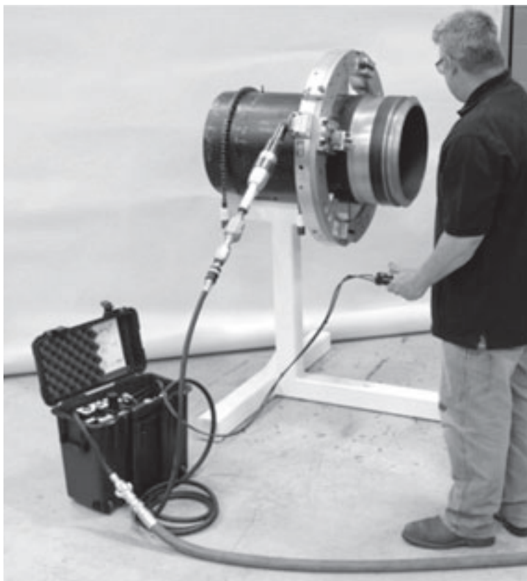
Рис. 5-74. Расположите ПБУ на удобном расстоянии от разъемного агрегата.
