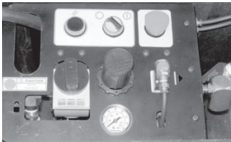
Рис. 5-75. Перед соединением воздушных линий следует установить функции управления ПБУ в предэксплуатационное состояние.
