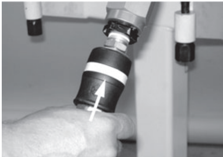
Рис. 5-86. Вдавите муфту в штуцер пневматического двигателя до щелчка и блокировки.
