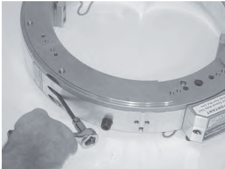
Рис. 5-16. Отверните невыпадающие винты для разъема половин агрегата.
