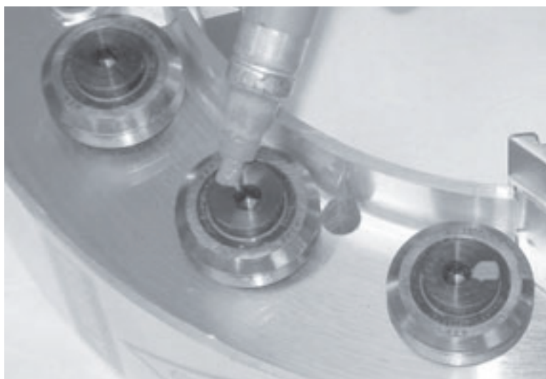
Рис. 7-13. Сделайте отметку маркером на кромках всех подшипников.
