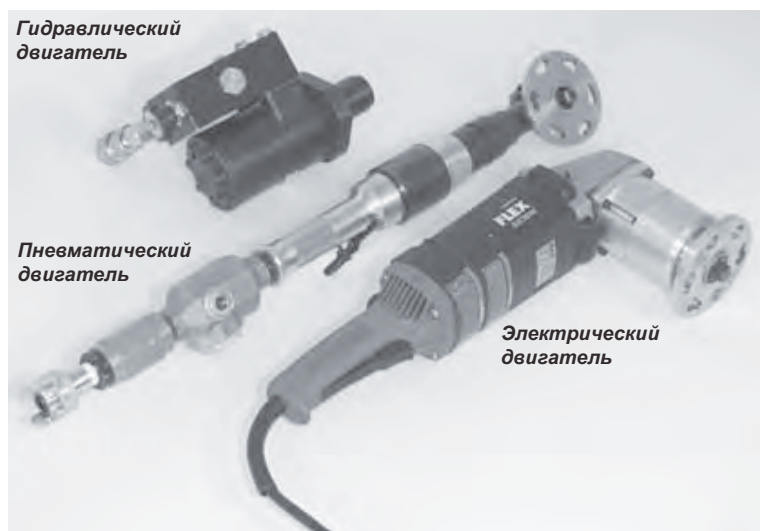
Рис. 3-6. На фотографии показаны варианты приводов для НПРА.
