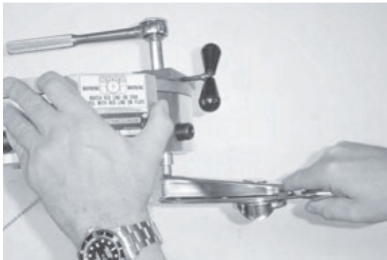
Рис. 7-10. Зафиксируйте эксцентриковый вал.
