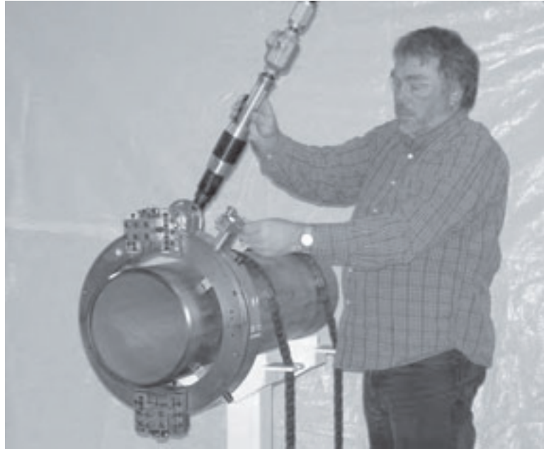
Рис. 2-7. По мере возможности следует располагаться за НПРА для предотвращения непреднамеренного контакта с подвижными частями во время работы агрегата.
