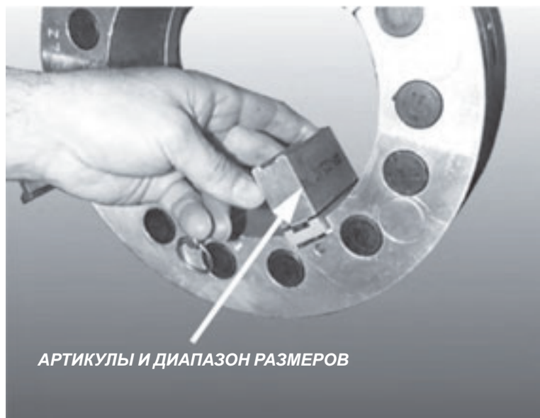
Рис. 5-14. Установите зажимные механизмы в зажимные блоки.
