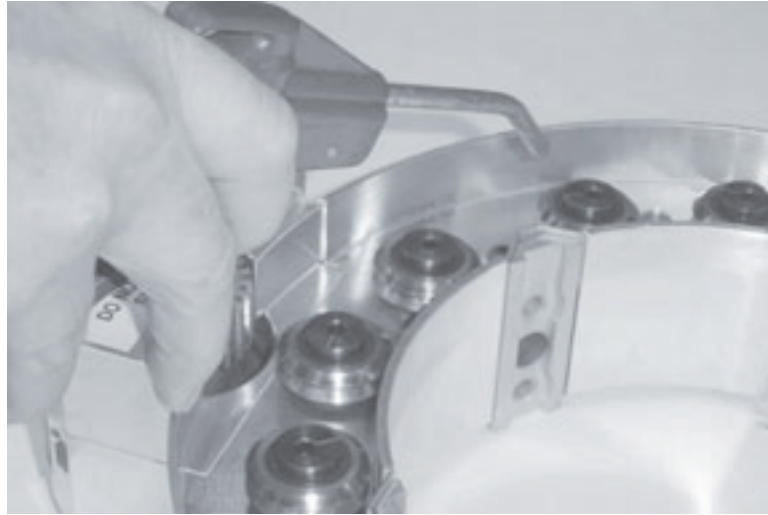
Рис. 7-2. Уберите загрязнения из неподвижной станины.
