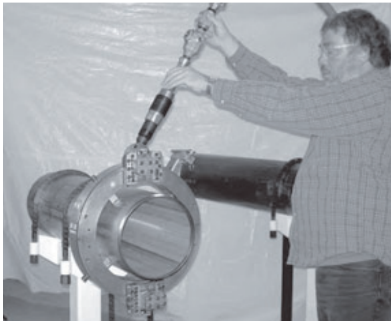
Рис. 2-8. При управлении НПРА с передней стороны необходимо располагаться сбоку агрегата для использования управляющих рычагов без необходимости тянуться через вращающуюся платформу.
