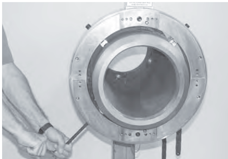
Рис. 5-22. Затягивайте винт до плотной посадки зажимного механизма на трубе.
