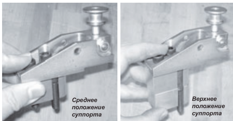
Рис. 5-41. Используйте требуемое для выбранного положения установки суппорта количество удлинительных блоков.
