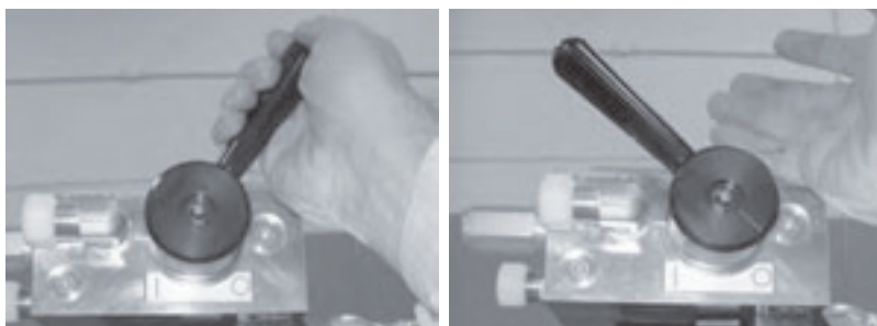
Рис. 2-5. Удерживайте пусковой рычаг гидравлического двигателя для задействования НПРА (слева). При отпускании рычага (справа) происходит останов гидравлического двигателя.
