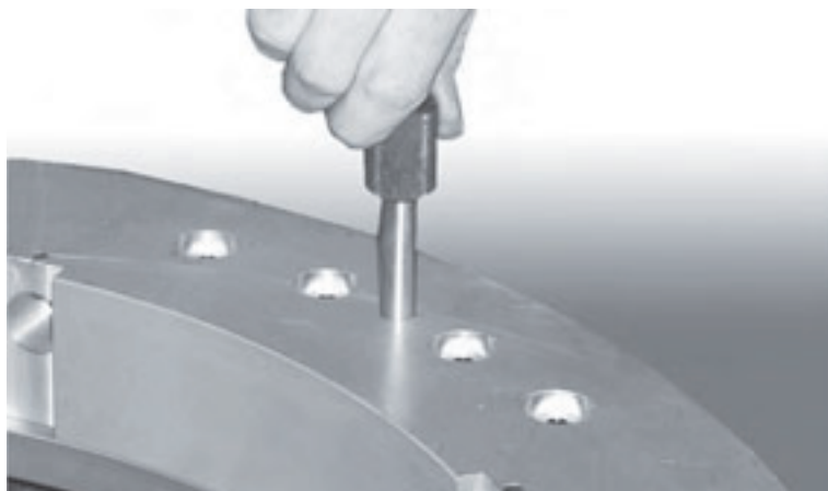
Рис. 7-18. Вставьте центрирующие штифты для предотвращения проворачивания вращающейся платформы.
