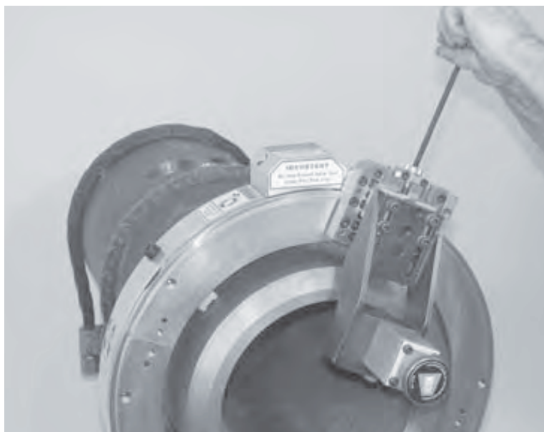
Рис. 5-68. Отрегулируйте суппорт для расточки поворачиванием винта радиальной подачи суппорта по часовой стрелке
