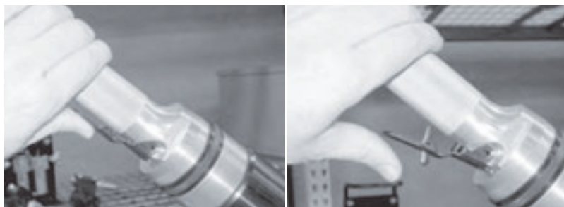
Рис. 2-4. Удерживайте пускатель пневматического двигателя для задействования НПРА (слева). При отпускании пускателя (справа) происходит останов пневматического двигателя.
