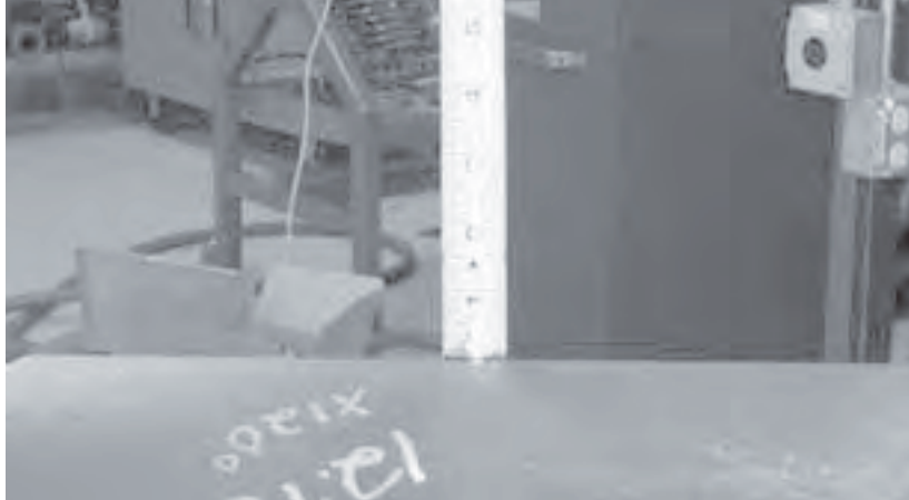
Рис. 5-1. Измерьте радиальный зазор вокруг поверхности трубы.
