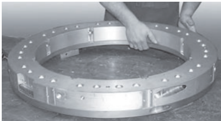
Рис. 7-17. Проверьте на наличие люфта между вращающейся и неподвижной платформами.
