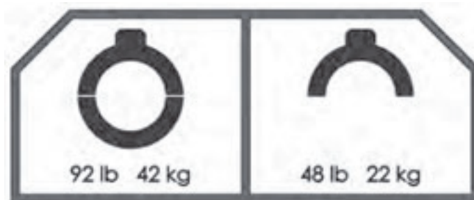
Рис. 2-18. Наклейки с информацией о массе низкопрофильного разъемного агрегата размещены на корпусе ведущей шестерни. Масса агрегата и артикул отличаются для разных моделей. (Артикул 60-1279-XX).
