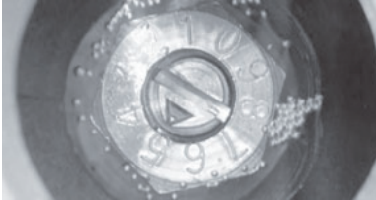
Рис. 6-1. Используйте винт игольчатого вентиля для регулирования скорости подачи смазки в пневматический двигатель.
