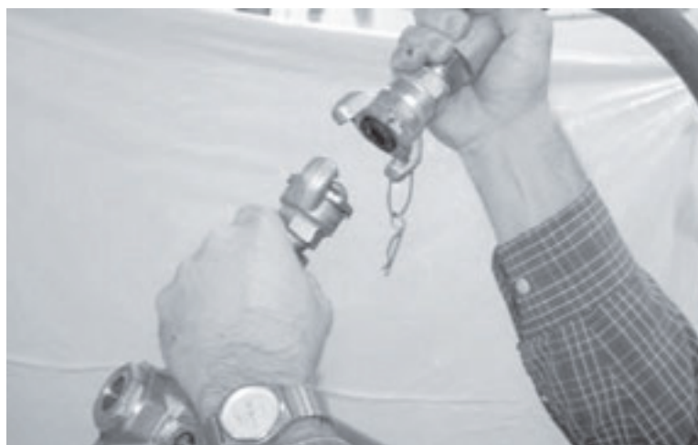
Рис. 2-10. Отсоедините линию подачи сжатого воздуха от пневматического двигателя.
