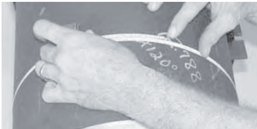
Рис. 5-3. Проверьте окружность трубы измерением.
