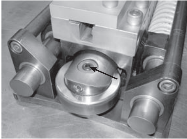
Figura 4-2. Quite el tapón e instale una graser para engrasar la rueda de seguimiento. Después de engrasar la rueda, quite la graser y vuelva a poner el tapón.
