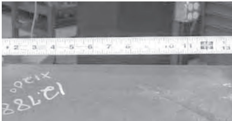
Рис. 5-2. Измерьте осевой зазор вдоль планируемой рабочей зоны трубы.
