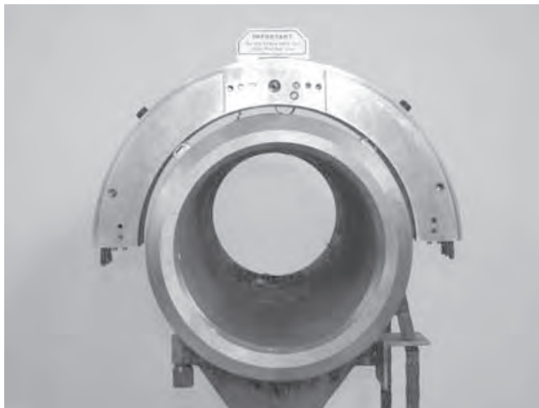
Рис. 5-18. На горизонтальных трубах следует устанавливать агрегат стороной с корпусом ведущей шестерни в верхней части трубы.
