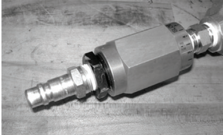
Рис. 5-89. Установите специальный штупер из комплекта поставки для возможности использования пневматического двигателя с ПБУ.
