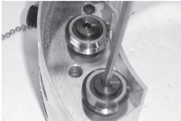
Рис. 7-6. Установите отметки на эксцентриковых валах по направлению к центру вращающейся платформы.
