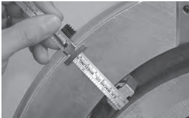
Рис. 5-24. Измерьте зазор у зажимного механизма рядом с положением на 12 часов.
