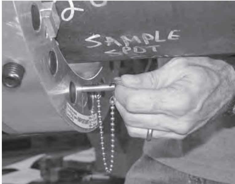
Рис. 5-25. Извлеките фиксирующие станину штифты.
