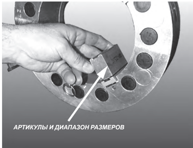
Рис. 5-14. Установите зажимные механизмы в зажимные блоки.
