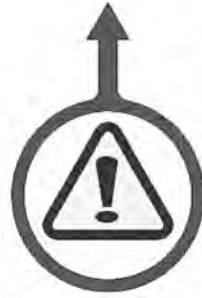
Рис. 2-21. Наклейка с указанием места расположения центрирующего штифта прикреплена для упрощения поиска отверстий для вставки данных штифтов. На агрегате размещены две наклейки, по одной на штифт. (Артикул 60-1275-00).
