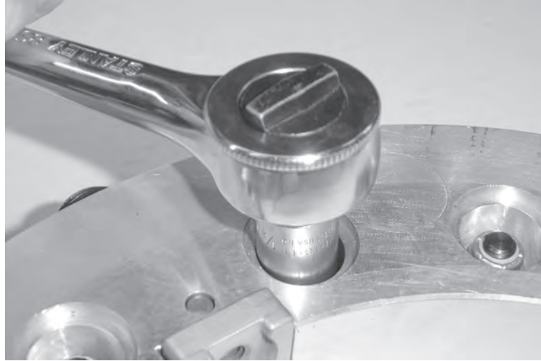
Рис. 7-5. Отверните стопорные гайки.
