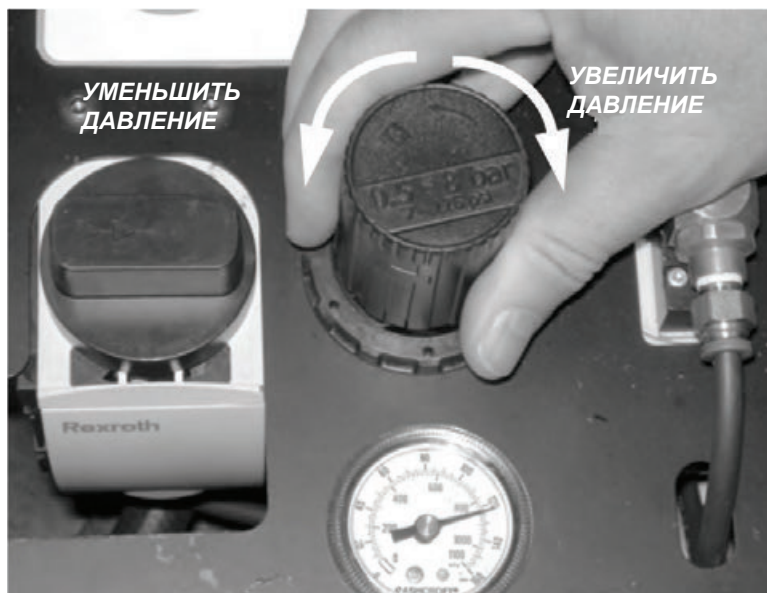
Рис. 5-84. Вытяните рукоятку вверх и поворачивайте для регулирования давления.
