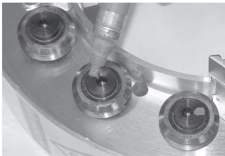
Рис. 7-13. Сделайте отметку маркером на кромках всех подшипников.
