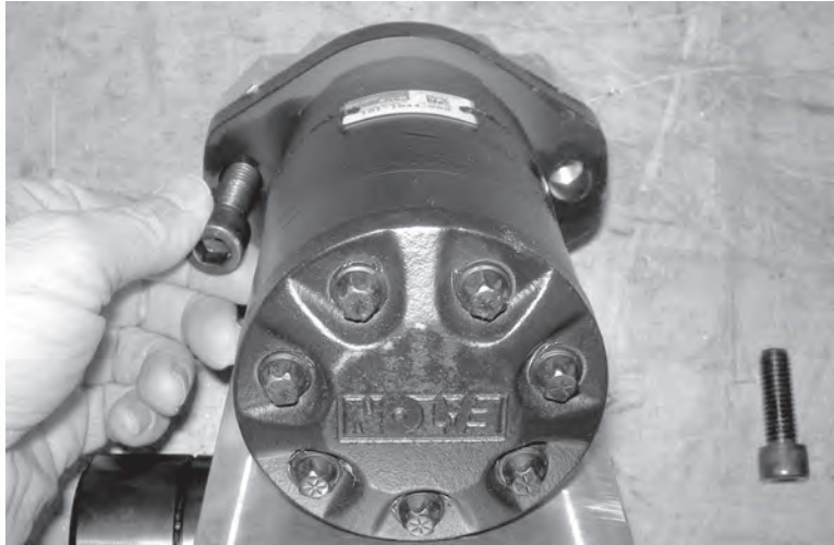
Рис. 5-47. Извлеките винты гидравлического двигателя для отсоединения от переходника.
