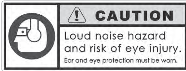
Рис. 2-14. Наклейка с информацией о мерах по защите органов слуха и зрения прикреплена к приводному двигателю НППРА. Во время эксплуатации оборудования следует обязательно использовать средства защиты органов слуха и зрения. (Артикул 90-401-03).
