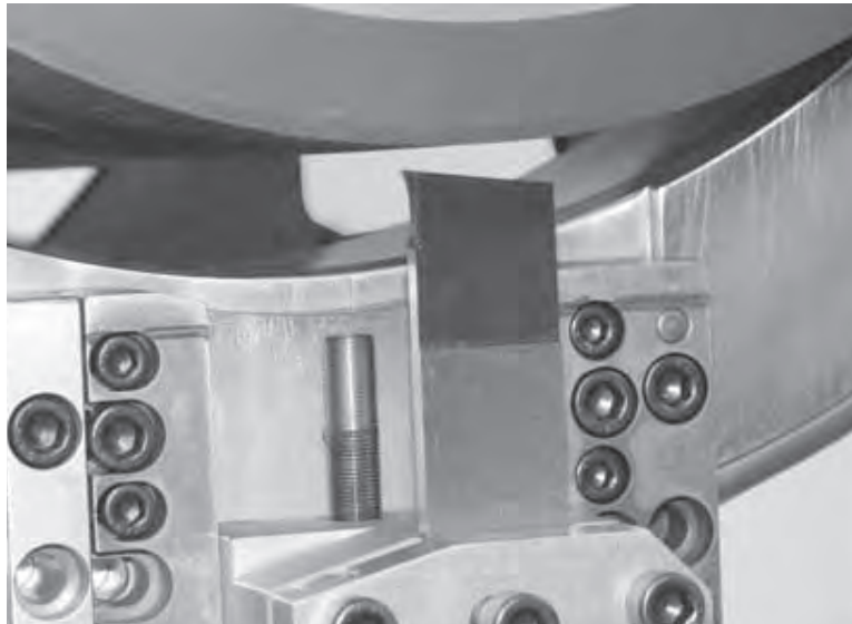
Рис. 5-37. Расположите кончик резца с зазором 1/8" (3 мм) от поверхности трубы.
