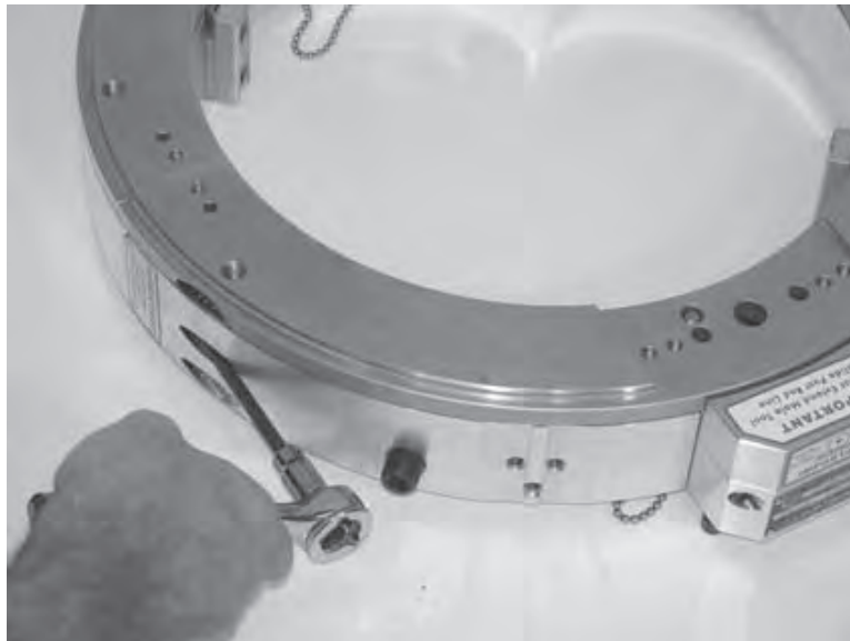
Рис. 5-16. Отверните невыпадающие винты для разъема половин агрегата.
