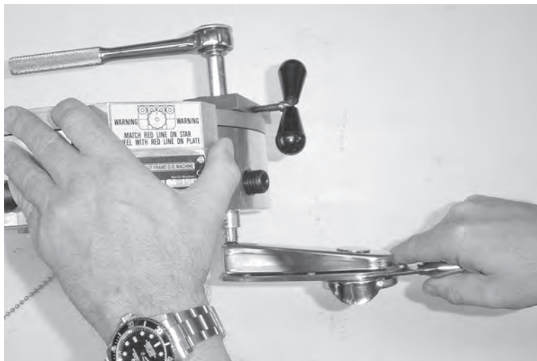
Рис. 7-10. Зафиксируйте эксцентриковый вал.
