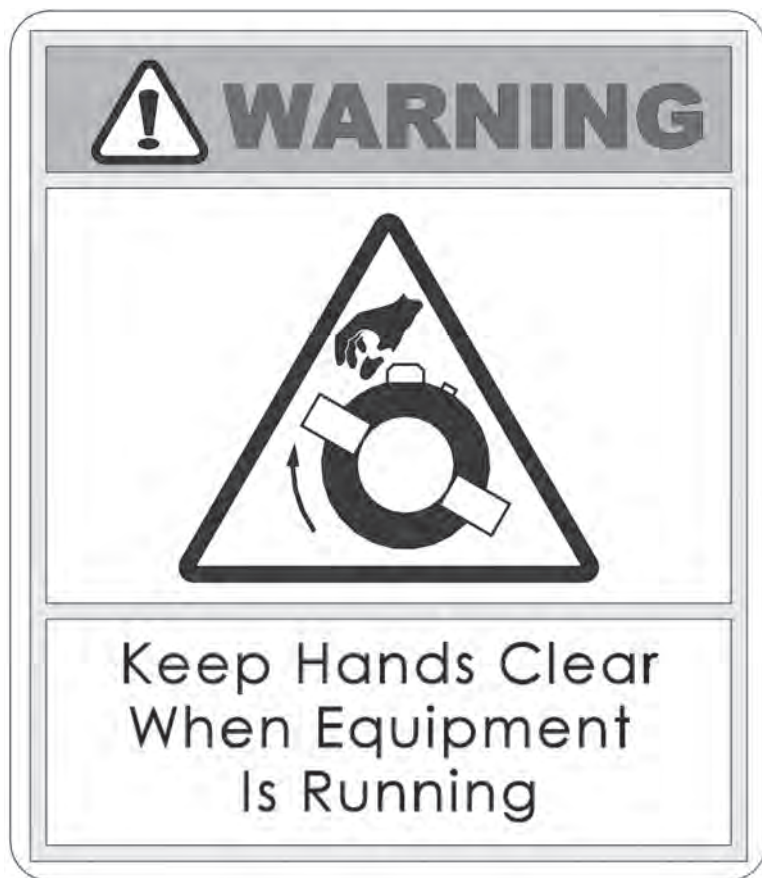
Рис. 2-19. Наклейка «Берегите руки» прикреплена к станине НПРА. Держитесь в стороне от подвижных деталей во время работы агрегата. (Артикул 60-363-00).
