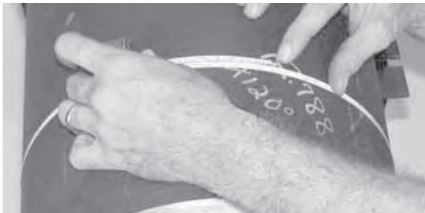
Рис. 5-3. Проверьте окружность трубы измерением.
