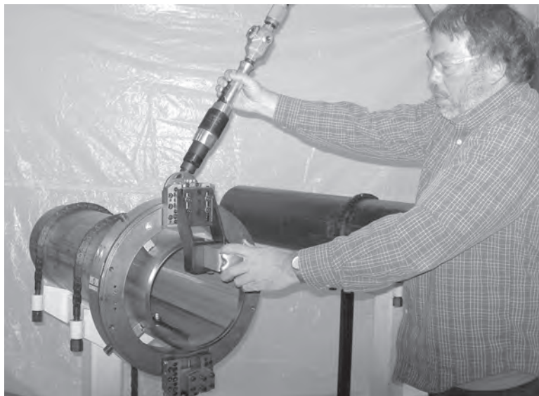
Рис. 2-9. При использовании вспомогательного оборудования с необходимостью контроля органов управления (показано унифицированное расточное устройство) следует располагаться в положении, позволяющем управлять агрегатом без контакта с подвижными частями.
