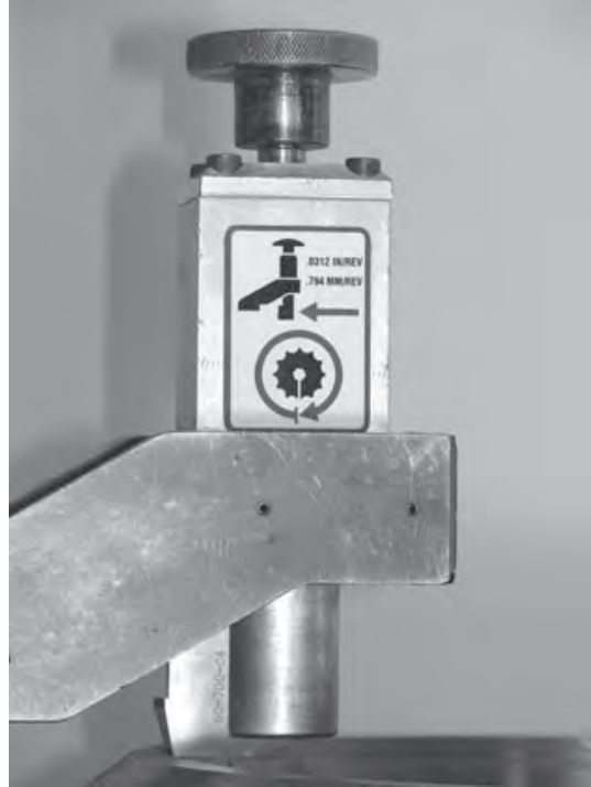
Рис. 5-69. Регулировка осевой (0,0312" / 0,79248 мм) и радиальной (0,0784" / 1,99136 мм) подачи на оборот.
