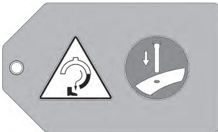
Рис. 2-20. Наклейка с указанием места расположения центрирующего штифта прикреплена к станине. Убедитесь в установке центрирующих штифтов перед разъемом половин станины. (Артикул 60-1274-00).
