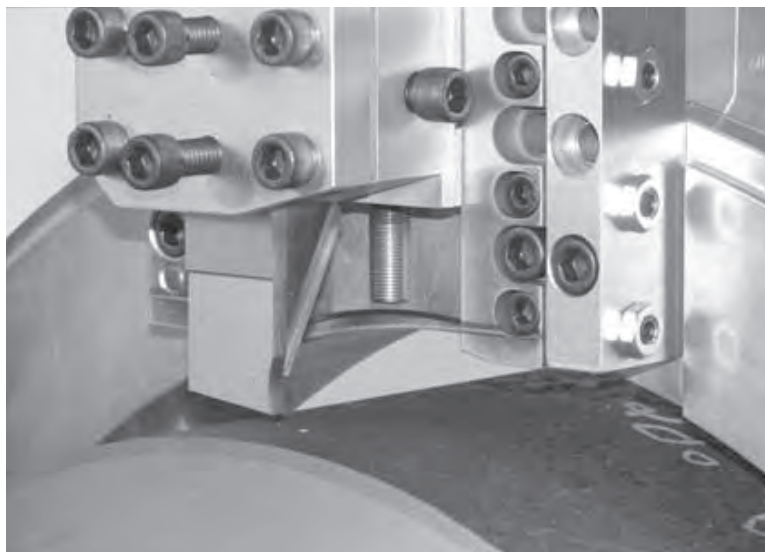
Рис. 5-38. На фотографии показан отрезной резец на расстоянии 1/8" (3 мм) от исходной точки.
