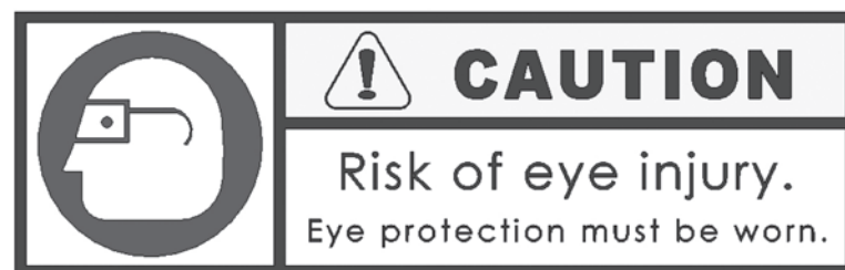
Figura 2-4. Etichetta di sicurezza Pericolo di lesioni agli occhi, fornita con configurazioni con motore idraulico (cod. 90-401-01).
