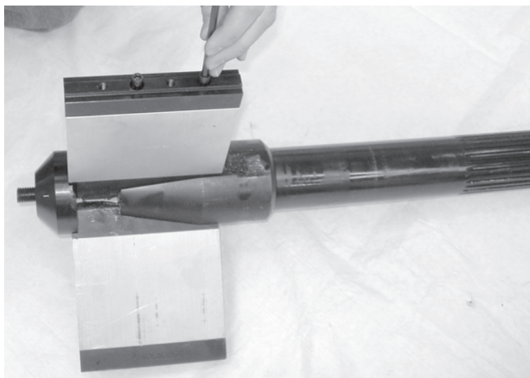
Figura 5-3. Utilizzare le prolunghe in acciaio (N.1 o N.2) nella parte superiore quando si installano più ganasce.
