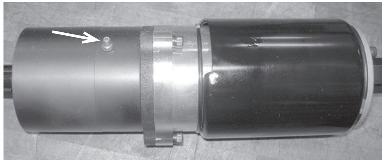
Figura 6-8. Ingrassare il motore ad aria una volta al mese.
