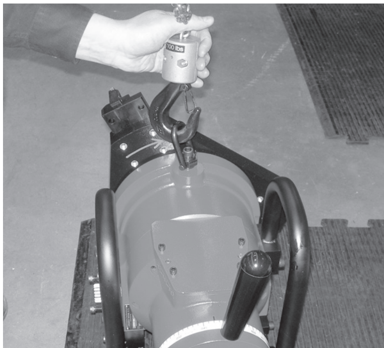
Figura 5-42. Fissare il dispositivo di sollevamento al gancio.
