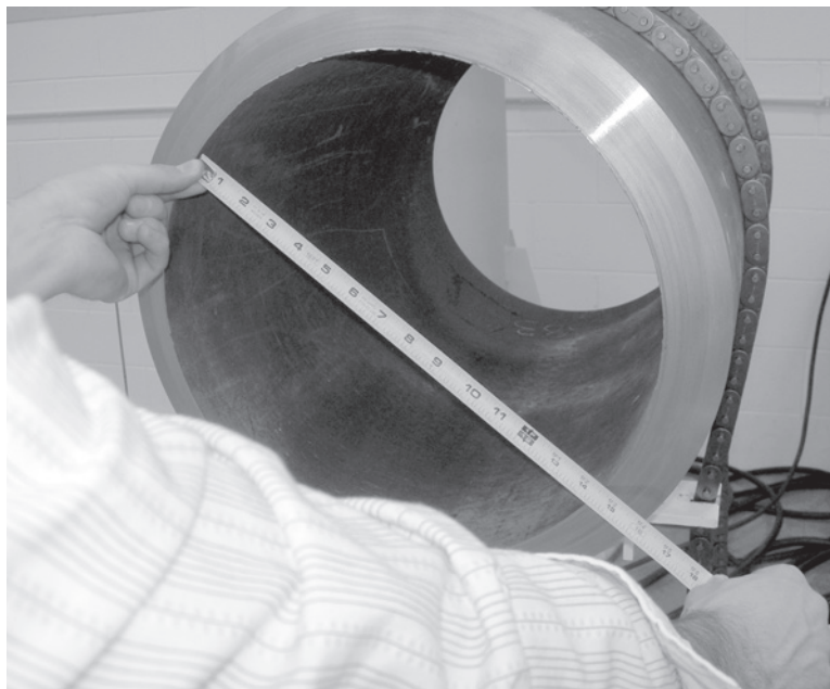
Figura 5-1. Misurare il diametro interno del tubo per determinare quale set di ganasce di fissaggio da utilizzare.
