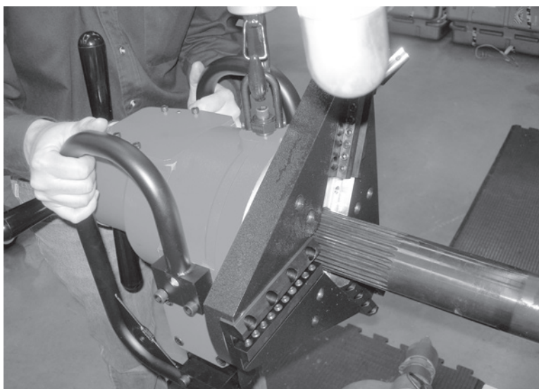
Figura 5-43. Posizionare la macchina per il montaggio sull'albero.
