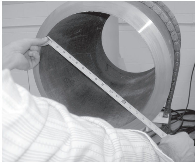
Figura 5-8. Misurare il diametro interno del tubo per determinare quale set di ganasce di fissaggio da utilizzare.
