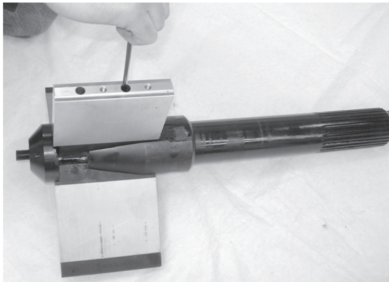
Figura 5-2. Avvitare i prigionieri nel mandrino per fissare le ganasce.
