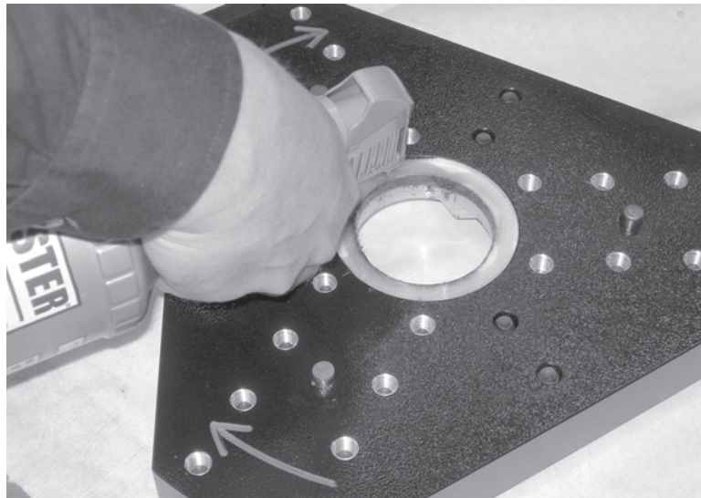
Figura 6-4. Applicare l'olio alla guarnizione in feltro nella testa rotante.
