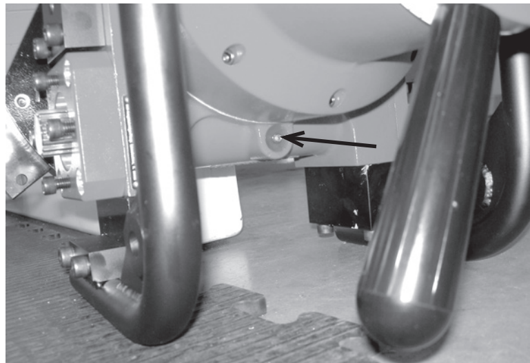
Figura 6-1. L'ingrassatore si trova in fondo all'alloggiamento del gruppo trasmissione principale.
