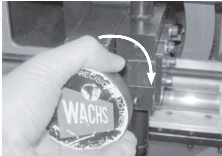
Рис. 3-29. Произведите стягивание вдвигаемого суппорта при помощи рукоятки подачи.
