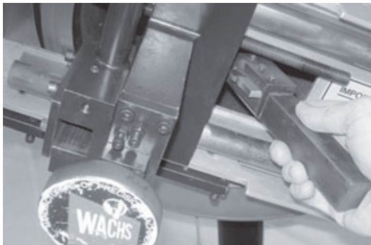
Рис. 3-9. Для установки резцедержателя можно протянуться через суппорт и вставить держатель в переднюю часть резцовой головки.
