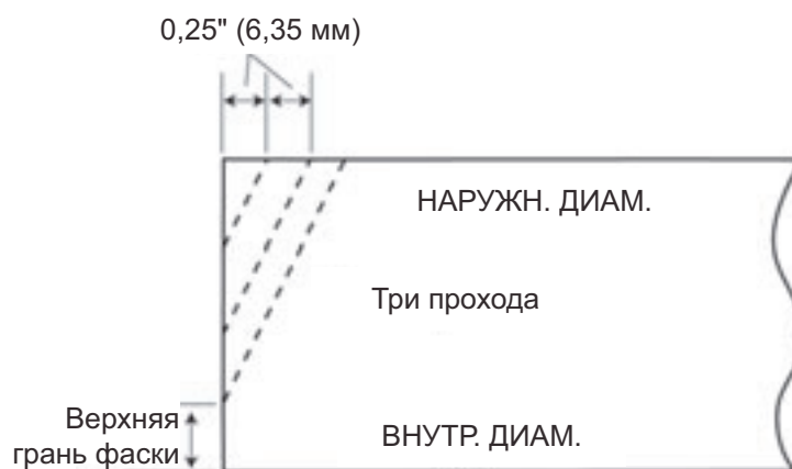
Рис. 3-40. На схеме показан процесс снятия прямой фаски за несколько проходов. Глубина размещения резцедержателя должна быть уменьшена на приблизительно 1/4\" (6,35 мм) вдоль наружного диаметра трубы. для каждого прохода.
