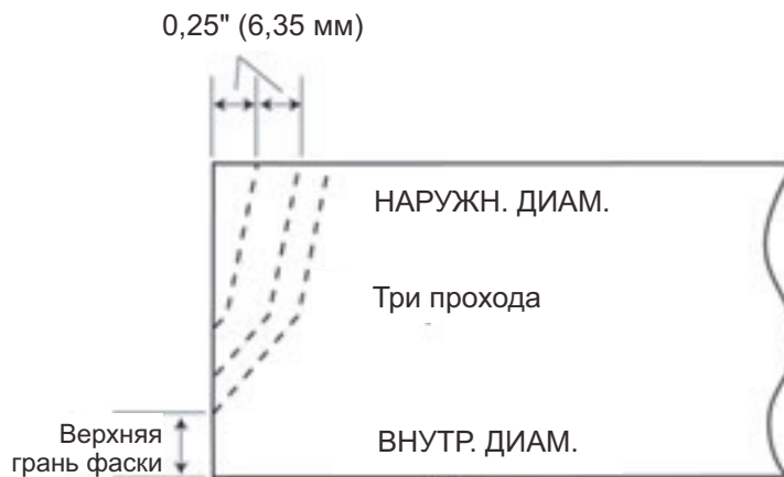
Рис. 3-53. На схеме показан процесс снятия составной фаски за несколько проходов. Глубина размещения резцедержателя должна быть уменьшена на приблизительно 1/4\" (6,35 мм) вдоль наружного диаметра трубы, для каждого прохода.
