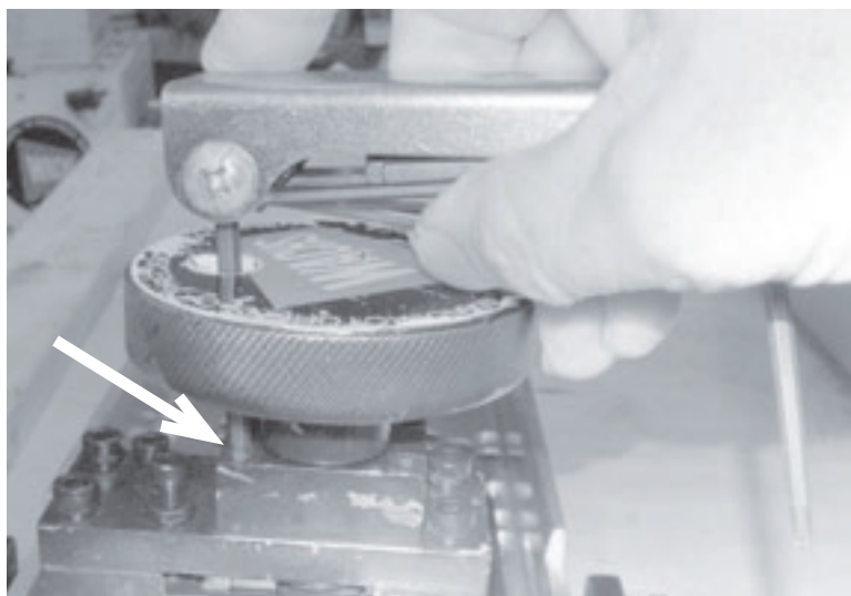
Рис. 4-5. Отверните 4 шт. винтов крепления концевой блока при помощи шестигранного гаечного ключа. Поворачивайте рукоятку для доступа к винтам.
