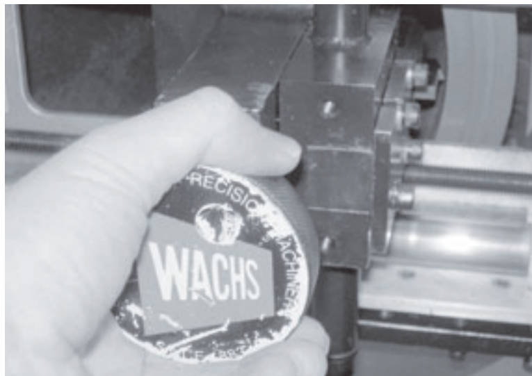
Рис. 3-21. Втягивайте резец из трубы поворачиванием рукоятки подачи по часовой стрелке.
