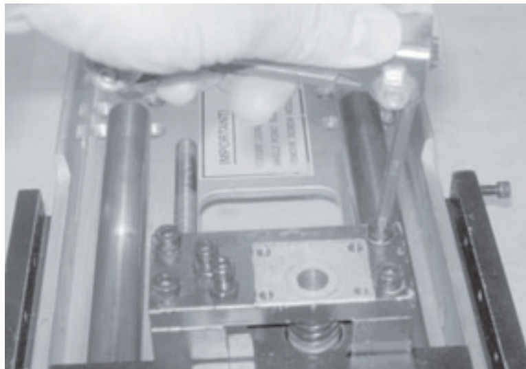
Рис. 4-7. Затяните винты крепления пластины. Отворачивайте все винты по несколько оборотов для равномерного выталкивания пластины пружиной.
