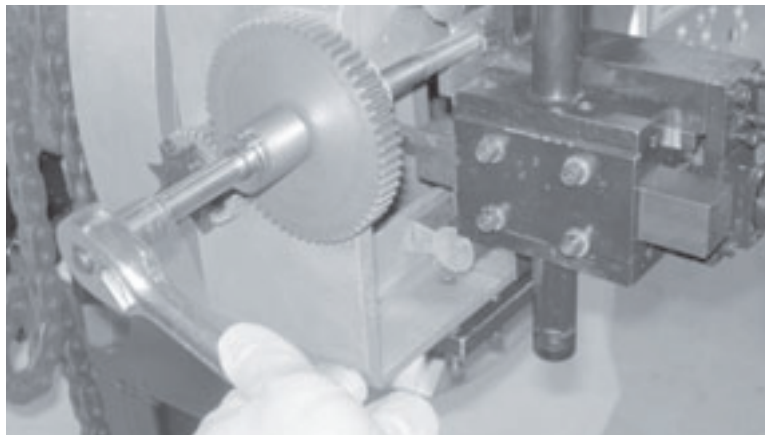
Рис. 3-42. Поверните корончатую гайку для установки наконечника резца у поверхности трубы.
