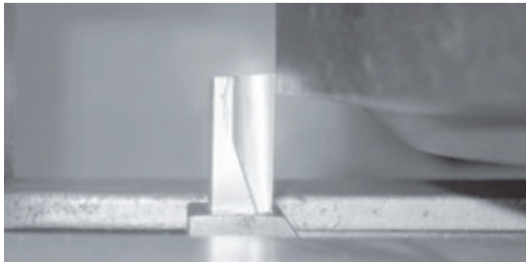
Рис. 3-60. Режущая кромка резца должна касаться наружного диаметра трубы.
