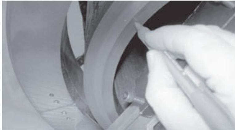
*Figura 3-57. È possibile contrassegnare la posizione del rilievo sul tubo per vedere quando si è prossimi alla passata finale.*
