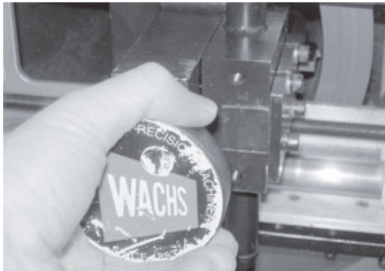
Figura 3-21. Retrarre l'utensile dal tubo ruotando la manopola di avanzamento in senso orario.
