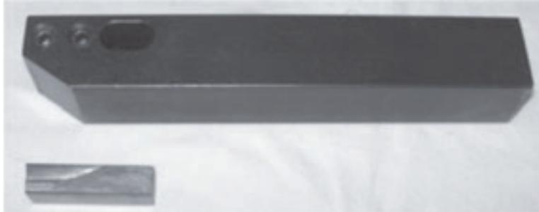
*Figura 1-4. Portautensili per punto singolo (codice 60-707-00) e utensile.*
