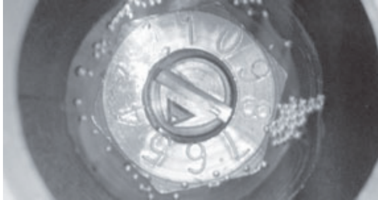
Figure 6-1. Utilisez la vis de la vanne à pointeau pour régler de débit d'écoulement du graisseur du moteur pneumatique.
