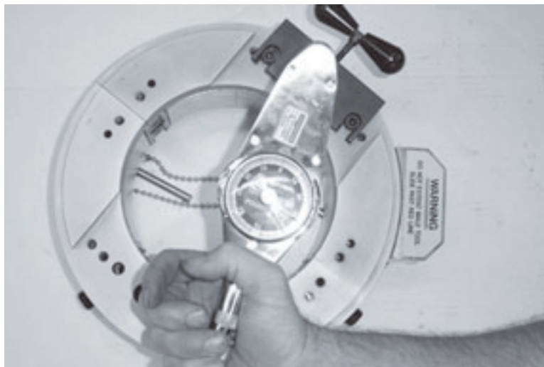
Figure 7-8. La plaque de fixation maintient l'arbre excentrique lorsque vous montez la bague du roulement sur la rainure en V.
