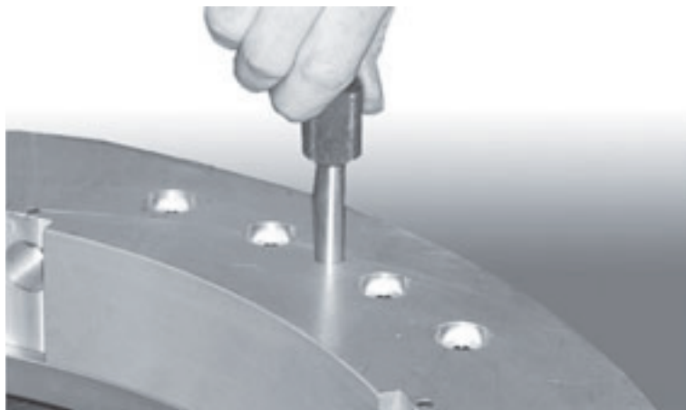
Figure 7-18. Introduisez les pieds de centrage pour empêcher la rotation du rotor.
