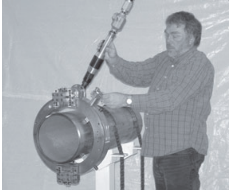
Figure 2-7. Dans la mesure du possible, tenez-vous derrière la machine pour rester hors de portée des pièces mobiles pendant l'utilisation des commandes.
