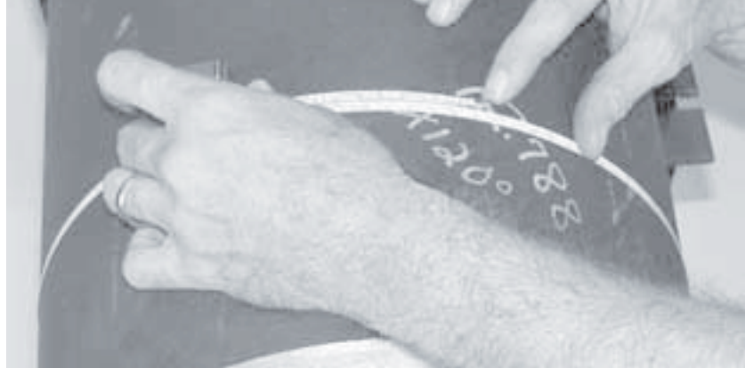
Figure 5-3. Mesurez la circonférence du tuyau.
