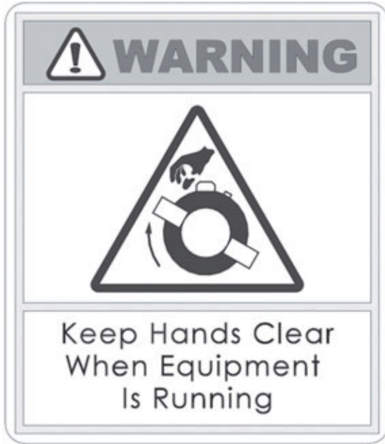
Figure 2-19. L'étiquette "Éloignez les mains" est apposée sur le stator de la machine. Restez éloigné des pièces mobiles pendant le fonctionnement de la machine. (Référence 60-363-00.)
