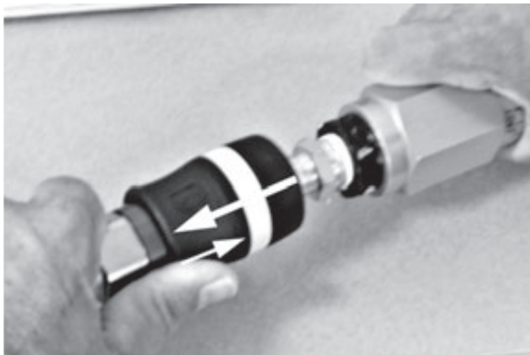
Figure 5-88. Poussez la bague vers l'avant et tirez le raccord rapide pour le démonter du raccord.
