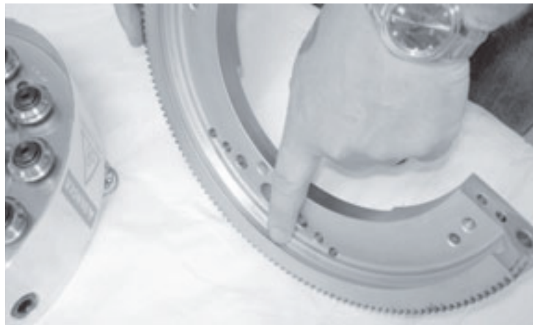
Figure 4-1. Recherchez des copeaux sur les chemins de roulement et évacuez-les le cas échéant.
