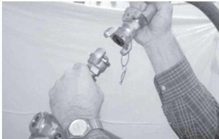
Figure 2-10. Débranchez l'alimentation pneumatique en déposant la canalisation pneumatique de la transmission pneumatique.
