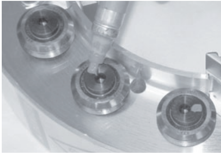
Figure 7-13. Marquez le côté de chaque roulement.
