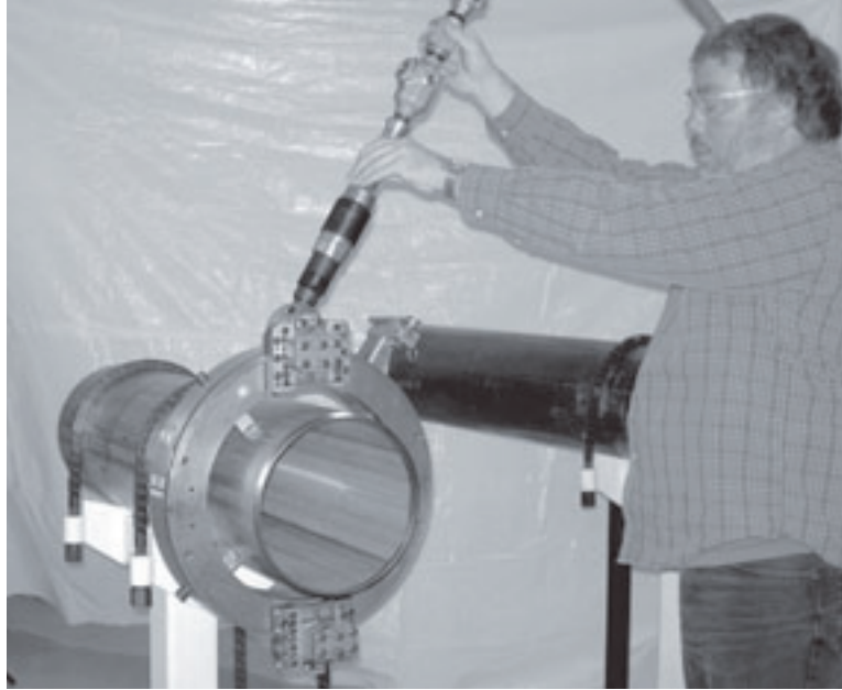
Figure 2-8. Lorsque vous utilisez la machine par l'avant, tenez-vous sur le côté de la machine pour utiliser les commandes sans entrer en contact avec le rotor.
