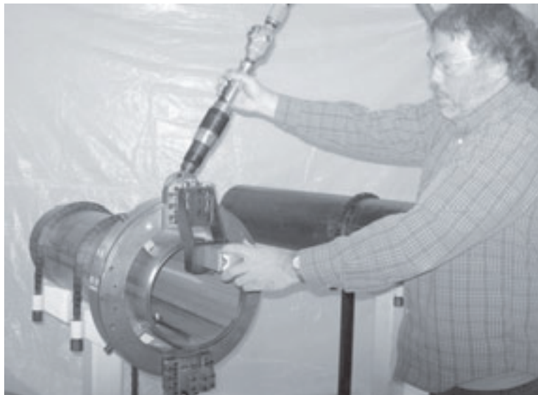
Figure 2-9. Lorsque vous utilisez des accessoires qui nécessitent d'utiliser leurs commandes (traverse de lamage universel représentée), tenez-vous dans une position qui permet d'utiliser la machine sans entrer en contact avec des pièces mobiles.
