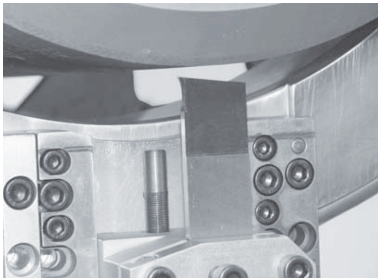
Figure 5-38. La photo représente l'outil à tronçonner à 1/8" (3 mm) au-dessus du repère poinçonné.
