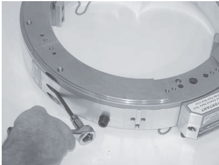
Figure 5-16. Desserrez les vis captives pour séparer les demi-couronnes.
