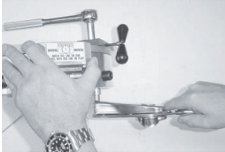
Figure 7-10. Montez l'arbre excentrique.
