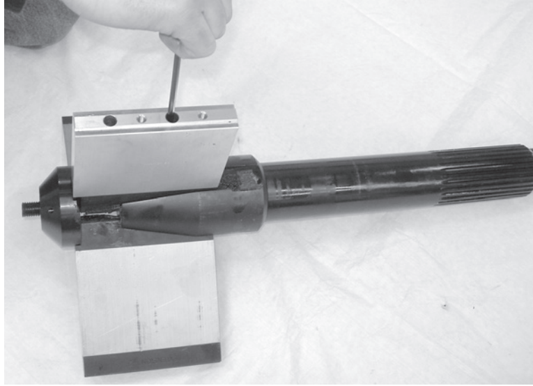
Рис. 5-2. Вверните невыпадающие винты в оправку для фиксации зажимных механизмов.
