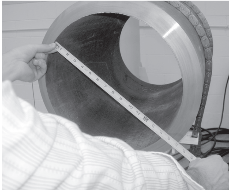
Рис. 5-1. Измерьте внутренний диаметр трубы для определения требуемого комплекта зажимных механизмов.
