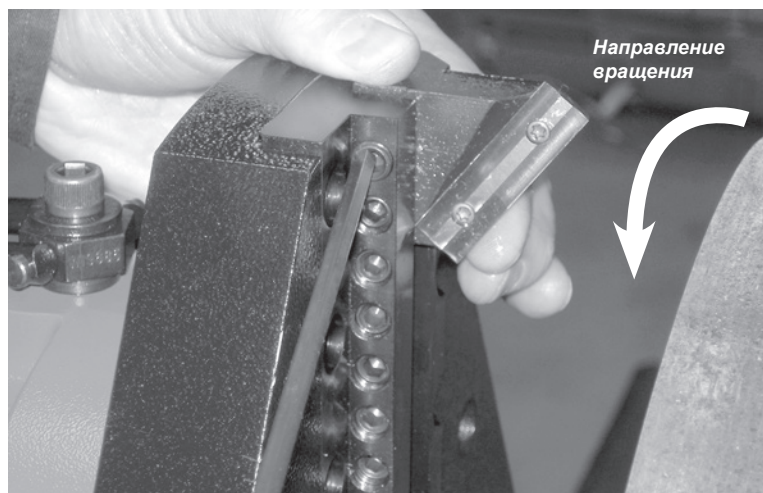
Рис. 5-47. Вставьте резец в резцедержатель и затяните установочные винты. Убедитесь в установке режущей кромки по направлению вращения, см. изображение.
