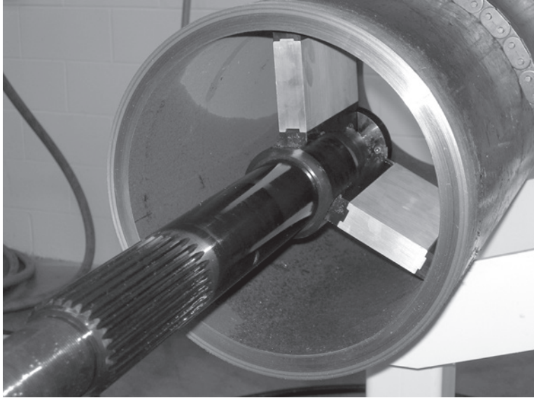
Рис. 5-5. Вставьте зажимные механизмы в трубу.
