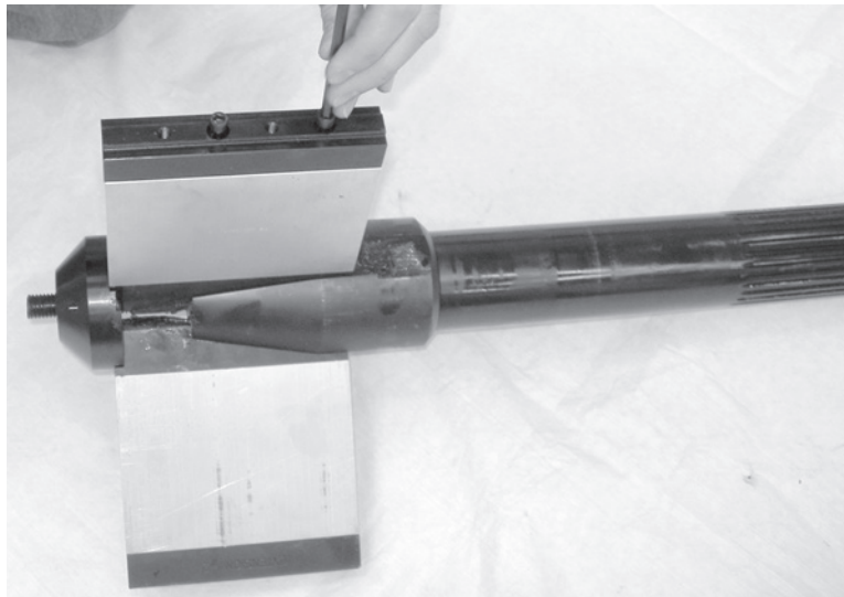
Рис. 5-3. Располагайте стальные удлинительные зажимы (№ 1 и № 2) сверху при использовании нескольких механизмов.
