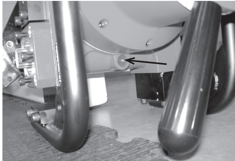
Рис. 6-1. Смазочный фитинг располагается в нижней части корпуса основного привода.
