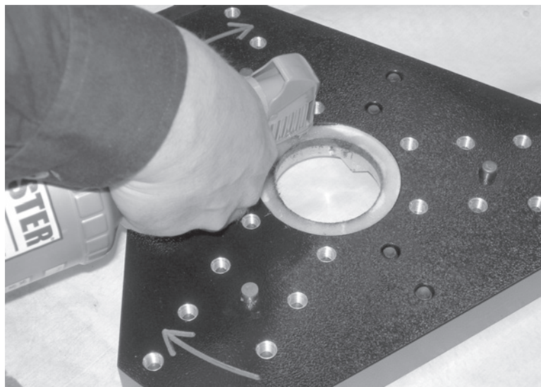
Рис. 6-4. Нанесите смазочное масло на фетровый скребок во вращающейся головке.
