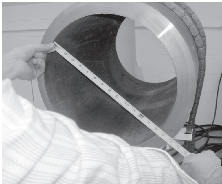
Рис. 5-8. Измерьте внутренний диаметр трубы для определения требуемого комплекта зажимных механизмов.
