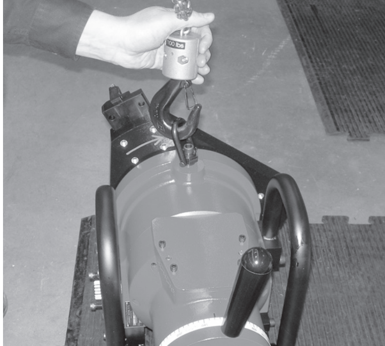
Рис. 5-42. Прикрепите подъемное устройство к крюку на корпусе станка.
