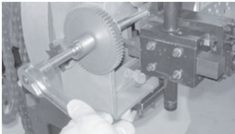
Figura 3-42. Gire la tuerca de seguridad para mover el buril a la posición sobre la cara del tubo.
