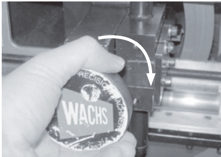
Figura 3-29. Retraiga el portaherramientas macho con la manivela de alimentación.
