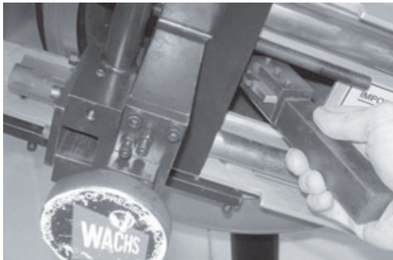
Figura 3-9. Para instalar el portaburil, puede entrar a través del portaherramientas e insertar el portaburil en el lado frontal del bloque de herramientas.
