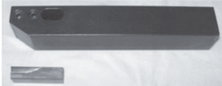
Figura 1-4. Portaburil de un solo punto (núm. de pieza 60-707-00) y herramienta.
