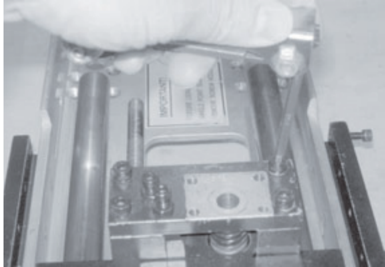
Figura 4-7. Quite los tornillos sosteniendo la placa de resorte. Gire cada tornillo unas cuantas vueltas a la vez de manera que el resorte empuje la placa de manera uniforme.
