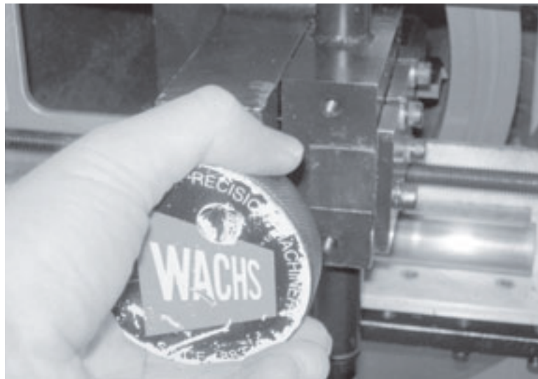
Figura 3-21. Retraiga la herramienta en el tubo girando la manivela de alimentación en el sentido del reloj.
