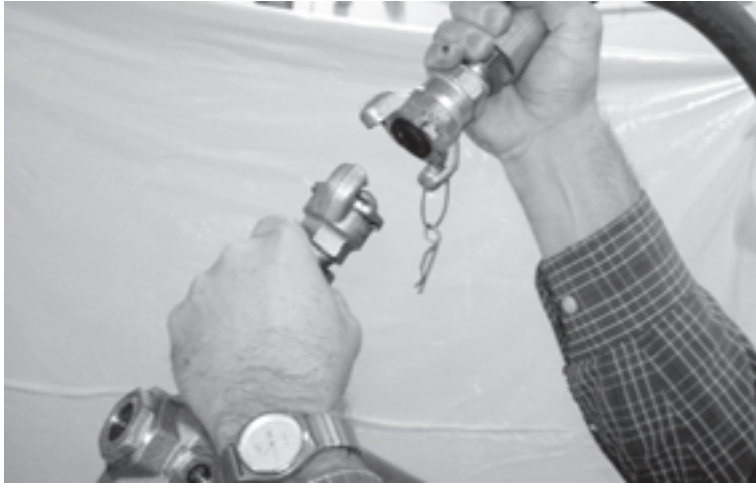
Figura 2-5. Scollegare l'alimentazione pneumatica rimuovendo la linea dell'aria dal motore pneumatico.
