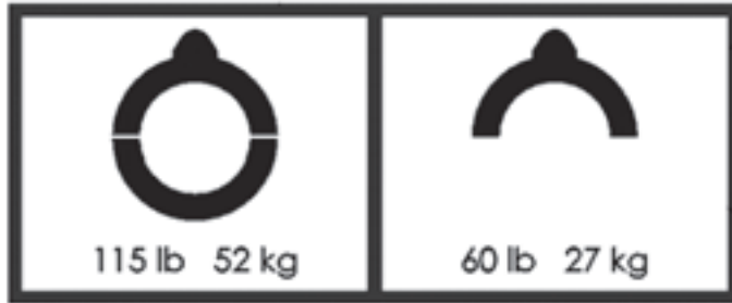
Figura 2-13. Le etichette dei pesi del MDSF sono affisse alla sede pignone. I pesi e i codici dipendono dal modello. (Codice 69-0134-XX)
