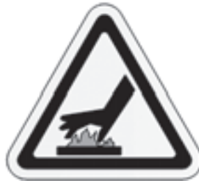
Figura 2-12. L'etichetta di superficie calda è affissa al motore (pneumatico o idraulico). I componenti di trasmissione possono riscaldarsi fino a provocare ustioni. Assicurarsi che non siano caldi prima di toccarli. (Codice 90-403-00)
