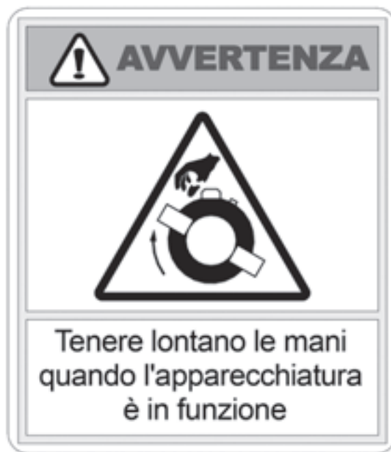
Figura 2-14. L'etichetta "Tenere le mani lontane" è affissa all'anello fisso del MDSF. Tenersi lontani dalle parti in movimento quando la macchina è in funzione. (Codice 60-363-00)
