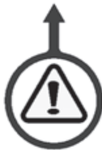
Figura 2-16. L'etichetta di posizione del perno di allineamento indica i fori dei perni di allineamento. Sono due le etichette sul MDSF, una per ogni posizione del perno. (Codice 60-1275-00)
