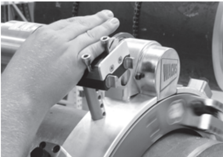
Figura 5-5. Spingere le manopole avanzamento per impegnare gli inneschi
