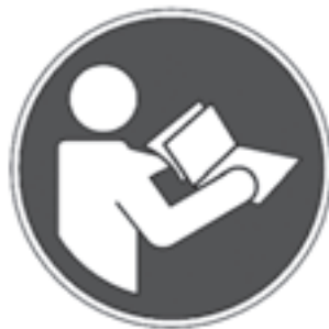
Figura 2-17. L'etichetta "Leggere il manuale" è affissa all'anello fisso del MDSF. Assicurarsi di comprendere tutte le istruzioni per l'uso e la manutenzione prima di utilizzare la macchina. (Codice 90-900-00 su macchine 20" e più grandi; codice 90-900-01 su macchine 18" e più piccole).
