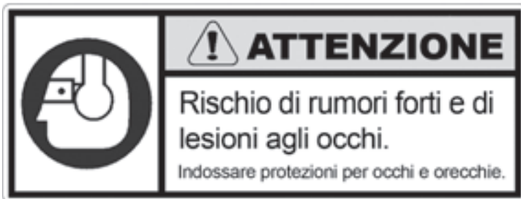
Figura 2-9. L'etichetta di protezione udito e vista è affissa sul motore del DynaPrep MDSF. Indossare sempre una protezione per udito e vista durante il funzionamento dell'apparecchiatura. (Codice 90-401-03)
