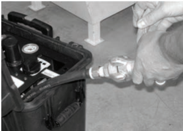
Figura 5-76. Conecte la línea de la alimentación de aire al conector de entrada en el ACM.
