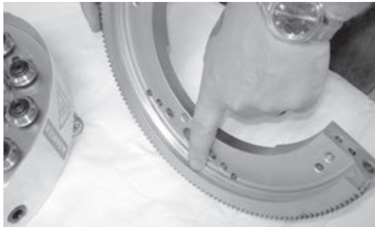
Figura 4-1. Revise la carrera del rodamiento en cuanto a rebabas y limpie como sea necesario.
