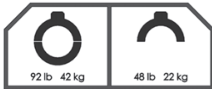
Figura 2-18. Las etiquetas de pesos para la LCSF están adheridas a la caja del piñón. Los pesos y los números de pieza varían conforme al modelo de LCSF. (Núm. de pieza 60-1279-XX).
