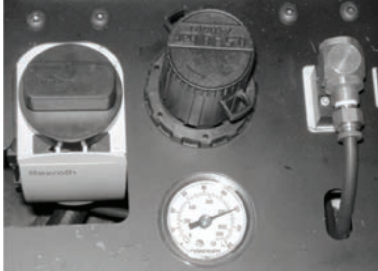
Figura 5-85. Sin jalar la manivela de presión, puede girarla para exponer las pestañas de bloqueo. Ponga un candado a través de la pestaña para prevenir que se ajuste la presión.
