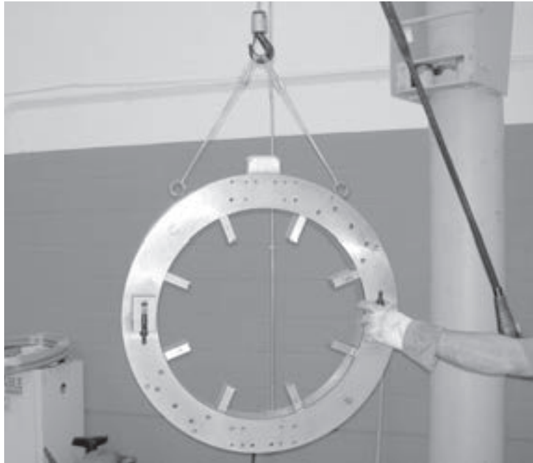
Figura 5-8. Eleve la máquina ensamblada como se muestra.
