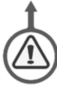
Figura 2-21. La etiqueta de ubicación del pasador de alineación está adherida para indicar los orificios de los pasadores de alineación. Hay dos etiquetas en la LCSF, una para cada ubicación del pasador. (Núm. de pieza 60-1275-00).
