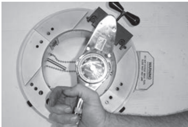
Figura 7-8. La placa de soporte sostendrá el eje excéntrico cuando coloque el rodamiento de engranajes contra la ranura en "V".
