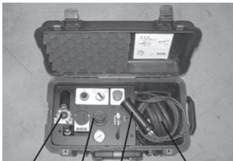
Conector de entrada de aire Panel de control Control de mano Manguera de salida para la cortadora bi-partida
