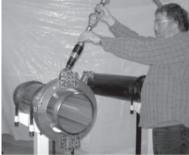
Figura 2-8. Cuando opere la LCSF desde el frente, párese en un lado de la máquina para operar los controles sin entrar al espacio del anillo giratorio.
