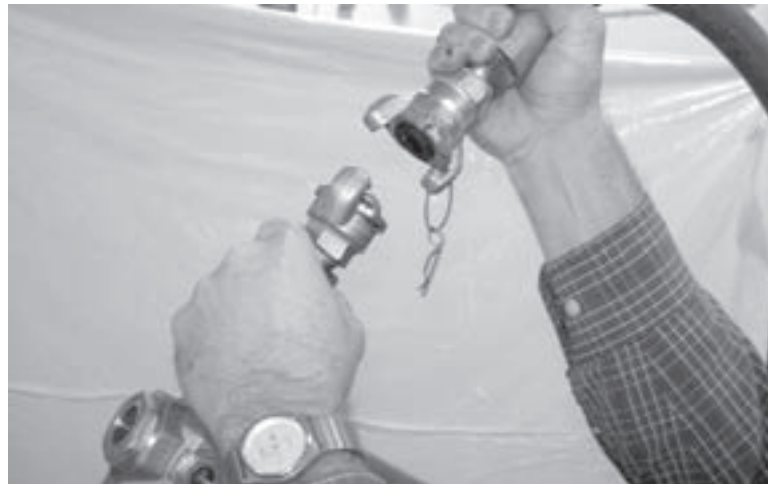
Figura 2-10. Desconecte la alimentación de energía neumática quitando la línea de aire de la unidad de accionamiento neumático.
