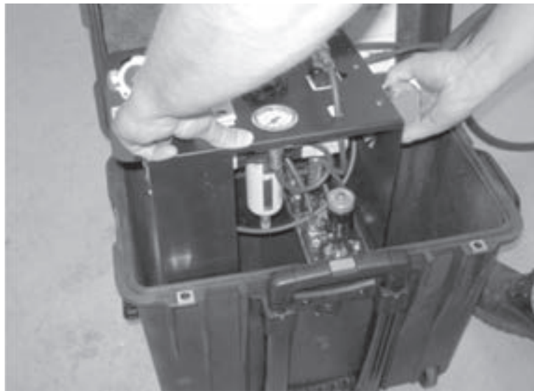
Figura 6-2. Levante y saque el panel de control de la caja para hacer tareas de servicio o para drenar el agua acumulada.
