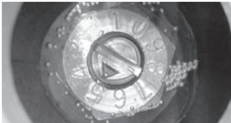
Figura 6-1. Use el tornillo de la válvula de aguja para ajustar la velocidad de goteo de la aceitera del motor neumático.
