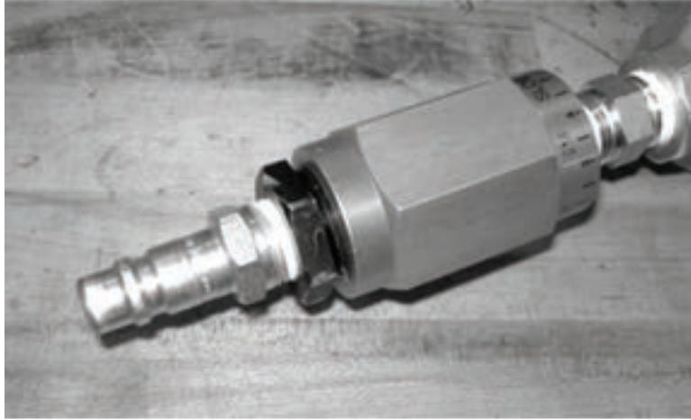
Figura 5-89. Instale el conector suministrado en el motor neumático para usarlo con el ACM.
