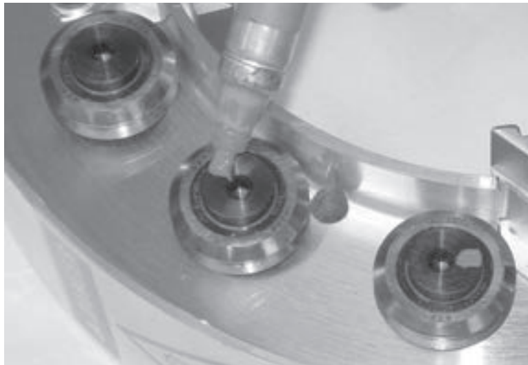
Figura 7-13. Marque el borde de cada rodamiento.
