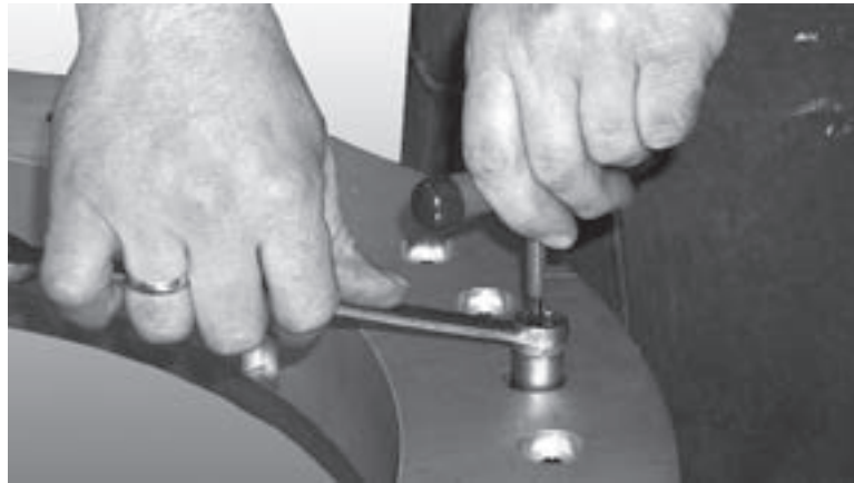
Figura 7-20. Gire el eje de rodamiento en sentido del reloj con la llave hexagonal, luego apriete la tuerca Nylock.
