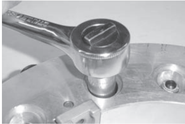
Figura 7-5. Afloje las tuercas de bloqueo.
