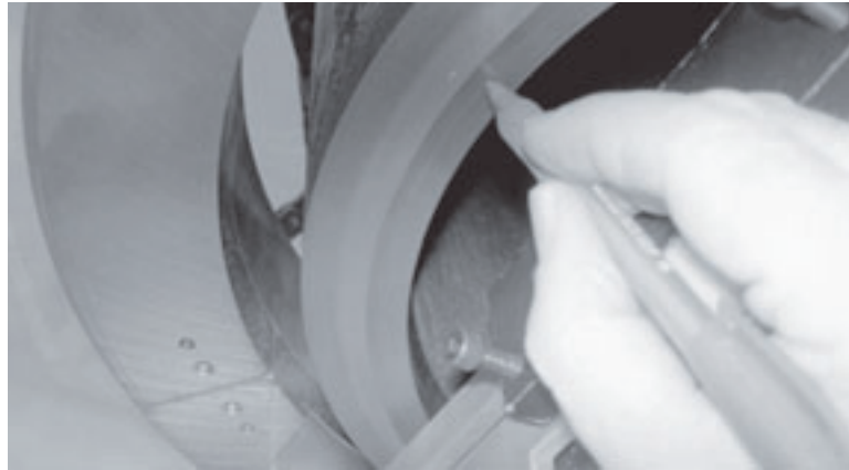
Figure 3-57. Vous pouvez repérer l'emplacement de l'arête finale sur le tuyau pour savoir lorsque vous êtes proche de la passe de finition.
