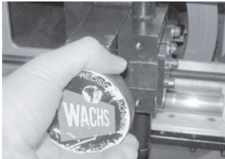
Figure 3-21. Reculez l'outil dans le tuyau en tournant la manette d'avance dans le sens des aiguilles d'une montre.
