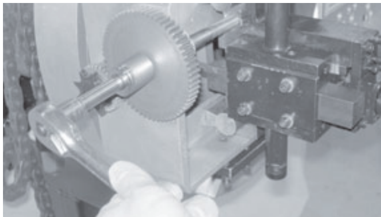
Figure 3-42. Tournez l'écrou crénelé pour positionner l'arête de coupe sur la face du tuyau.
