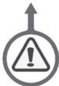
*Figura 2-22. L'etichetta di posizione del perno di allineamento indica i fori dei perni di allineamento. Sono due le etichette sull'LCSF, una per ogni posizione del perno. (Codice 60-1275-00)*
