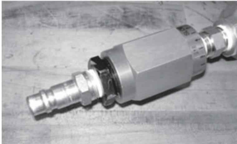
Figura 5-89. Installare il raccordo fornito sul motore pneumatico per l'utilizzo con l'ACM.
