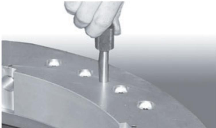
Figura 7-6. Inserire i perni di allineamento per impedire all'anello rotante di girare.
