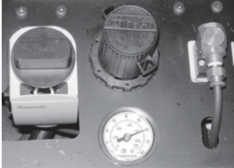
*Figura 5-85. Senza tirare la manopola di pressione, è possibile ruotarla per esporre le linguette di blocco. Inserire un lucchetto nella linguetta per impedire che la pressione possa essere regolata.*
