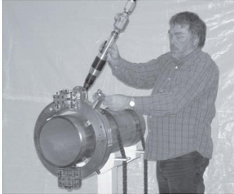
*Figura 2-8. Se possibile, sostare in piedi dietro l'LCSF per tenersi a distanza dalle parti in movimento durante il funzionamento dei comandi.*
