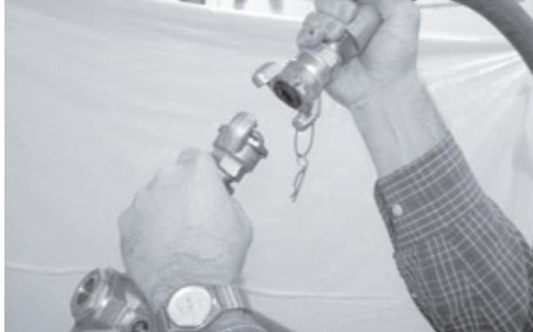
Figura 2-11. Scollegare l'alimentazione pneumatica rimuovendo la linea d'aria dall'azionamento pneumatico.
