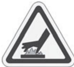
Figura 2-18. L'etichetta di superficie calda è affissa al motore dell'LCSF (pneumatico o idraulico). I componenti di trasmissione possono riscaldarsi fino a provocare ustioni. Assicurarsi che non siano caldi prima di toccarli. (Codice 90-403-00)
