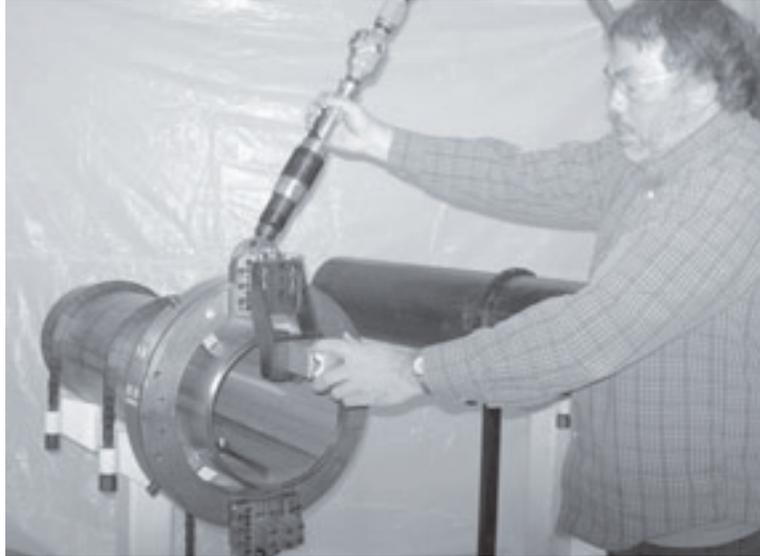
*Figura 2-10. Quando si usano accessori che richiedono l'uso dei comandi (in figura con la slitta da svasatura universale), sostare in una posizione in cui sia possibile azionare la macchina senza entrare in contatto con le parti in movimento.*
