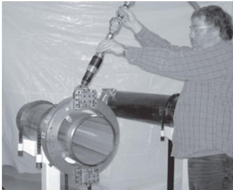
*Figura 2-9. Durante il funzionamento dell'LCSF dalla parte anteriore, sostare a fianco della macchina per azionare i comandi senza estendersi sopra l'anello rotante.*
