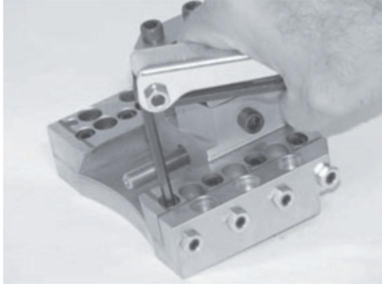
Figura 7-13. Serrare le viti a testa cilindrica con esagono incassato.
