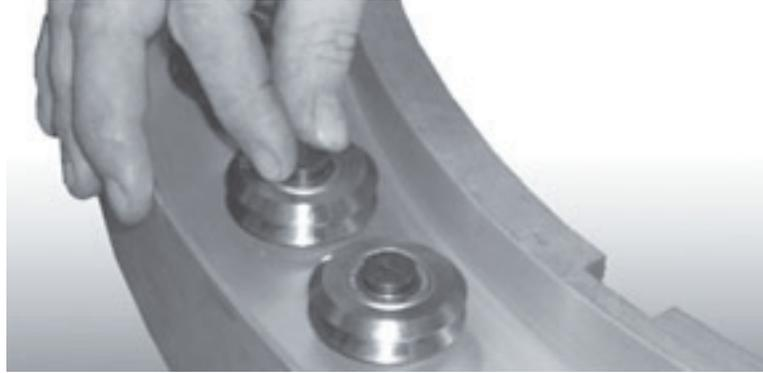
*Figura 7-2. Ruotare gli alberi eccentrici in modo che il punto alto di ogni cuscinetto sia rivolto all'interno dell'anello.*
