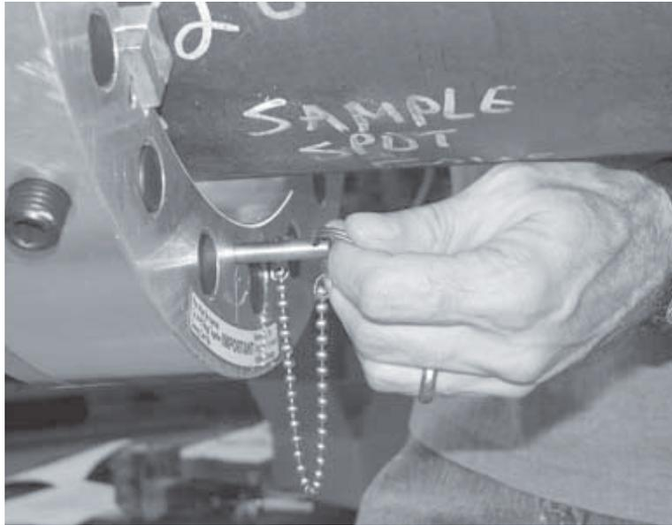
*Figura 5-25. Rimuovere i perni di bloccaggio del telaio.*
