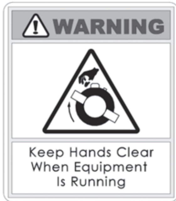
Figure 2-14. L'étiquette « Éloignez les mains » est apposée sur le stator de la machine. Restez éloigné des pièces mobiles pendant le fonctionnement de la machine. (Réf. 60-363-00).
