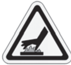
Figure 2-12. L'étiquette de surface chaude est apposée sur le moteur de commande (pneumatique ou hydraulique). Les composants de transmission peuvent être suffisamment chauds pour provoquer des brûlures. Vérifiez qu'ils ne sont pas chauds avant de les toucher. (Réf. 90-403-00).
