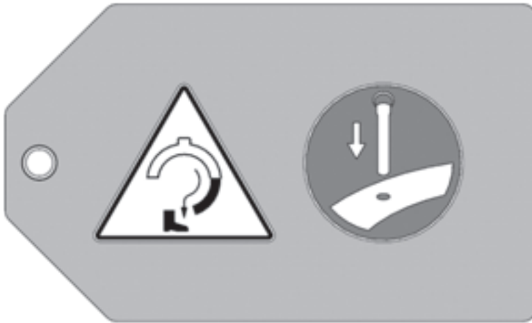
Figure 2-15. L'étiquette du pied de centrage est apposée sur le stator. N'oubliez pas d'introduire ces axes avant de séparer la machine. (Réf. 60-1274-00).
