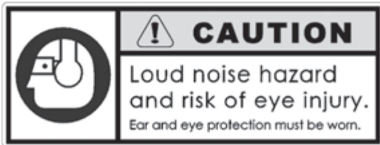
Figure 2-9. L'étiquette de protection oculaire et auditive est apposée sur le moteur de commande de la machine. Portez toujours une protection oculaire et auditive lorsque vous utilisez le matériel. (Réf. 90-401-03).
