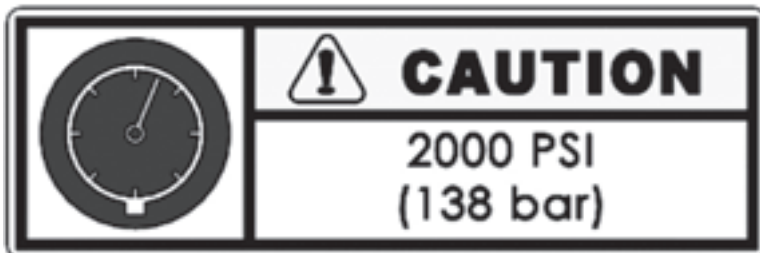
Figure 2-11. L'étiquette de pression hydraulique est apposée sur la transmission hydraulique de la machine. Ne mettez pas le matériel en service avec une pression hydraulique supérieure à 138 bars. (Réf. 90-402-01).
