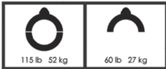
Figure 2-13. Les étiquettes de poids de la DynaPrep MDSF sont apposées sur le carter de transmission. Le poids et la référence varient en fonction du modèle. (Référence. 69-0134-XX).
