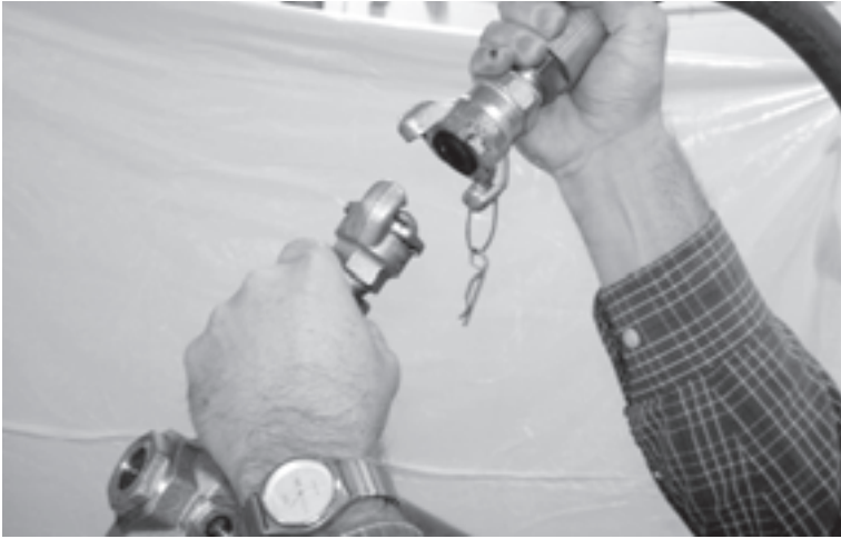
Figure 2-5. Débranchez l'alimentation pneumatique en déposant la canalisation pneumatique de la transmission pneumatique.
