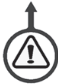
Figure 2-16. L'étiquette de l'emplacement des pieds de centrage est apposée pour indiquer les trous d'alignement. La DynaPrep MDSF comporte deux étiquettes, une pour chaque emplacement. (Réf. 60-1275-00).
