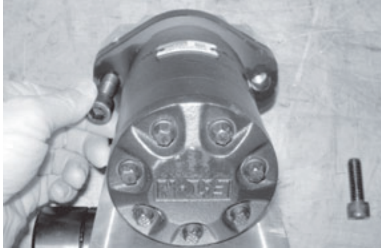
Figura 5-47. Quite los tornillos de la unidad de accionamiento hidráulico para quitar el motor de accionamiento del adaptador:
