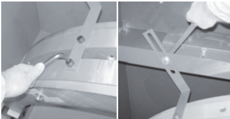
Figura 4-3. Para sacar la LCSF de la caja, quite los tornillos que sujetan los soportes a la máquina (izquierda), y luego quite los soportes quitando los tornillos que los fijan a la caja (derecha).
