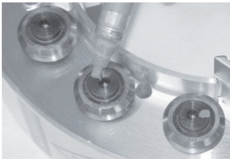
Figura 7-1. Marque el borde de cada rodamiento.
