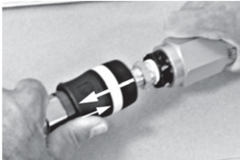
Figura 5-88. Empuje el collarín hacia adelante y jale la desconexión para quitarla del conector.
