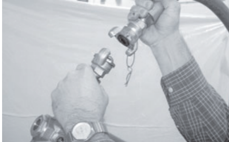
Figura 2-11. Desconecte la alimentación de energía neumática quitando la línea de aire de la unidad de accionamiento neumático.
