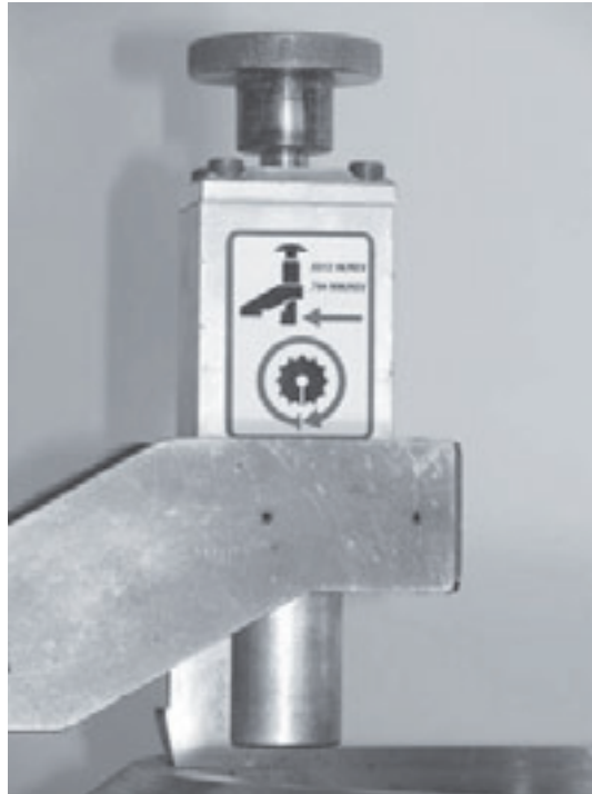
Figura 5-69. Ajuste axial (0,0312) y radial (0,0784) por revolución.
