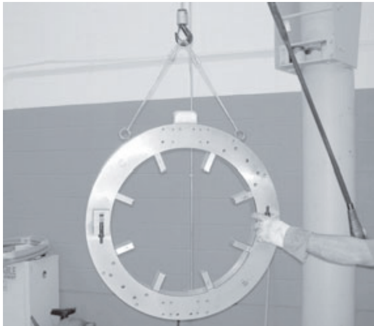
Figura 5-8. Eleve la máquina ensamblada como se muestra.
