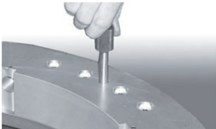
Figura 7-6. Inserte los pasadores de alineación para prevenir que gire el anillo giratorio.
