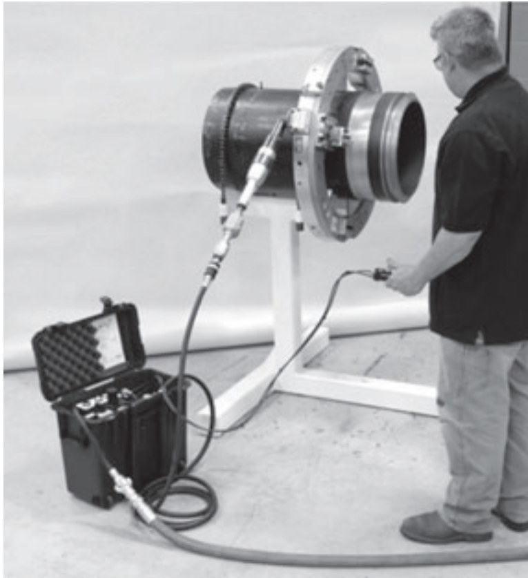
Figura 5-74. Coloque el ACM a una distancia conveniente de la máquina cortadora bi-partida.
