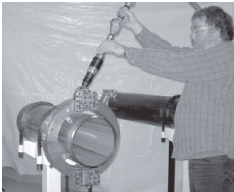
Figura 2-9. Cuando opere la LCSF desde el frente, párese en un lado de la máquina para operar los controles sin entrar al espacio del anillo giratorio.
