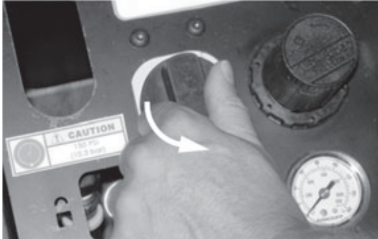
Figura 5-80. Gire la válvula de "ON/OFF" (encendido/apagado) en sentido contrarreloj a la posición "ON" (encendido). (Se muestra en posición "OFF" (apagado)).
