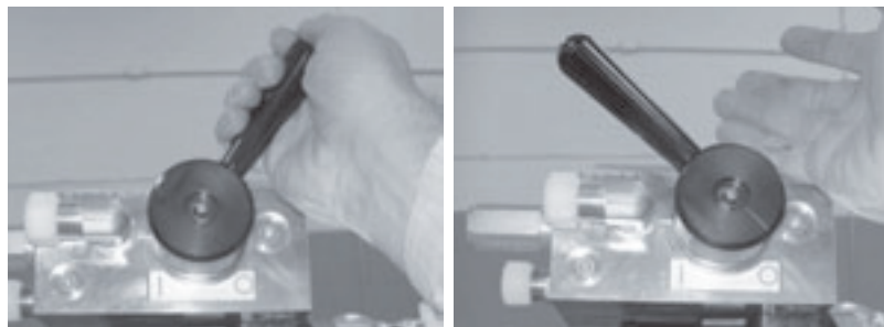
Figura 2-6. Sostenga la palanca hidráulica para operar la LCSF (izquierda). Cuando suelte la palanca (derecha), el motor hidráulico se apaga.
