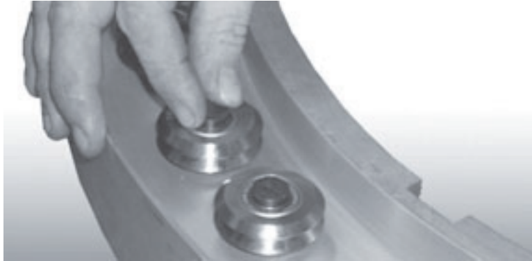
Figura 7-2. Gire los ejes excéntricos de modo que el punto alto de cada rodamiento esté de frente hacia el interior del anillo.
