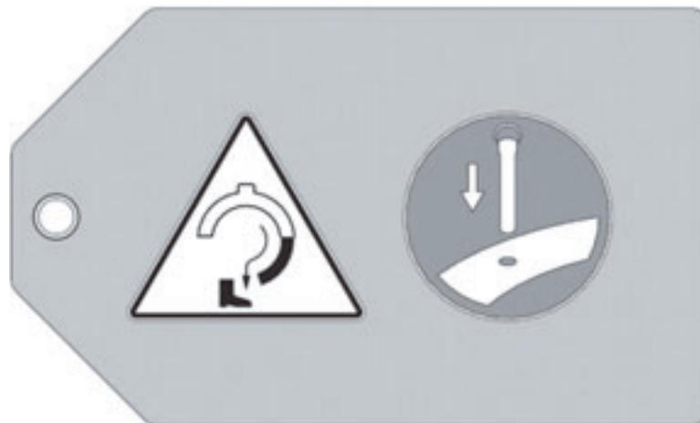
Figura 2-21. La etiqueta del pasador de alineación está adherida al anillo en el pasador de alineación. Asegúrese de insertar los pasadores antes de dividir la máquina. (Núm. de pieza 60-1274-00).
