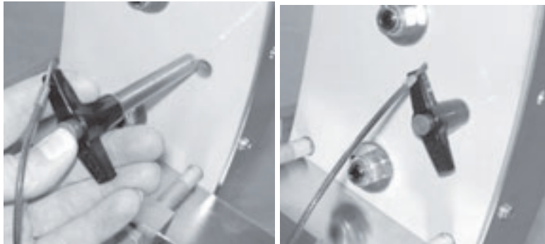
Рис. 5-2. Вставьте оба стопорных штифта сквозь вращающуюся платформу и неподвижную станину. При вставке или извлечении нажимайте кнопку на рукоятке штифта.
