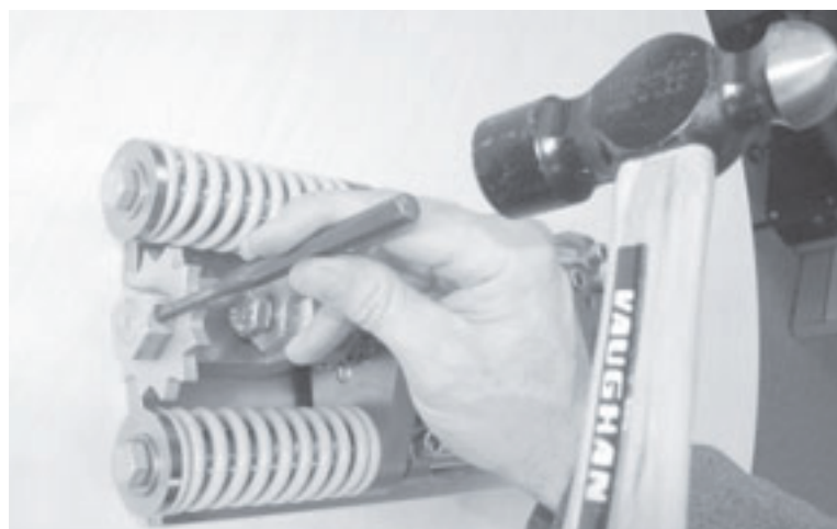
Рис. 7-17. Используйте пробойник для выбивания штифта ролика, удерживающего звездочку, с последующим вытягиванием подающего вала.
