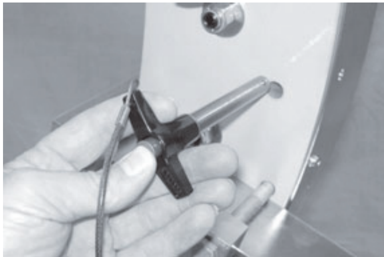
Рис. 7-2. Вставьте фиксирующие штифты для сцепления вращающейся платформы и неподвижной станины.
