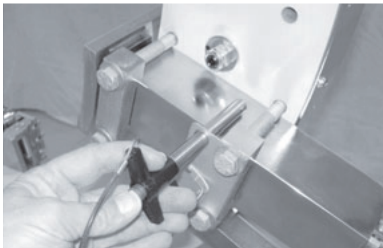
Рис. 5-23. Извлеките и разместите фиксирующие станину штифты в отверстия для хранения, см. изображение.
