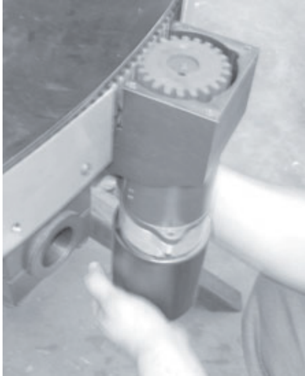
Рис. 5-19. Установите пневматический двигатель на раме и затяните два крепежных болта (снизу).
