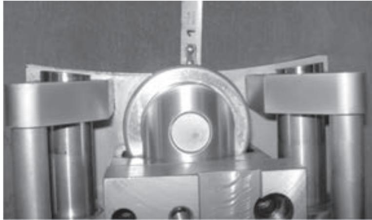
*Figure 3-4. Vérifiez que la roue suiveuse dépasse au moins de 1/8 po. (3,1 mm) de la base du plateau.*
