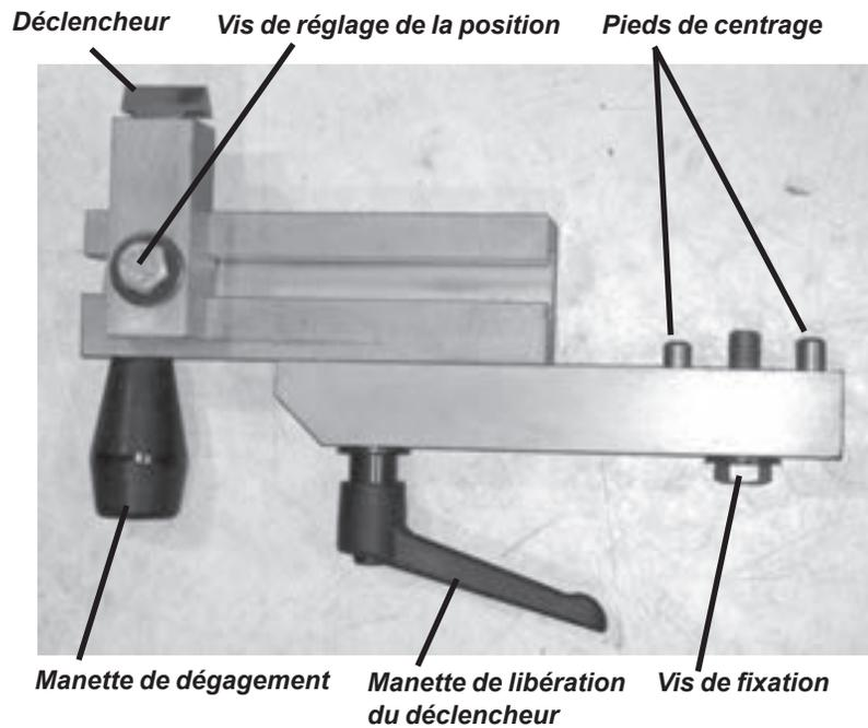
Figure 1-2. La photo représente les composants du déclencheur réglable utilisé avec les suiveurs de profil.
