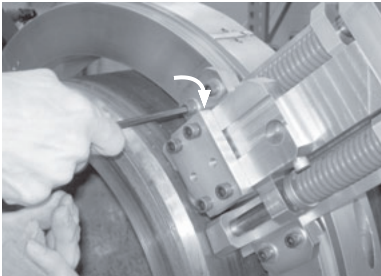
Figura 3-12. Una volta impostate le posizioni della slitta, serrare le viti delle ganasce di fissaggio.
