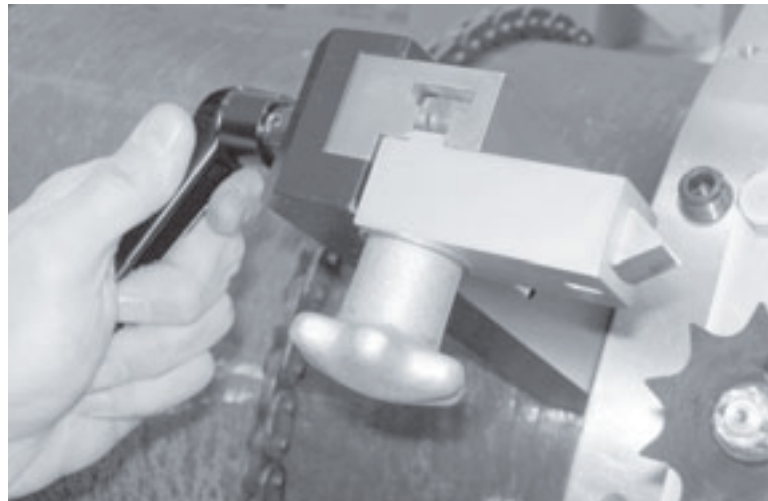
Figura 3-14. Impegnare l'innesco allentando la leva di blocco e spingendo la barra verso l'LCSF.
