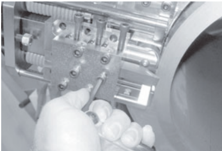
Figura 3-19. Serrare le viti di fissaggio superiori per trattenere in posizione l'utensile da smusso.
