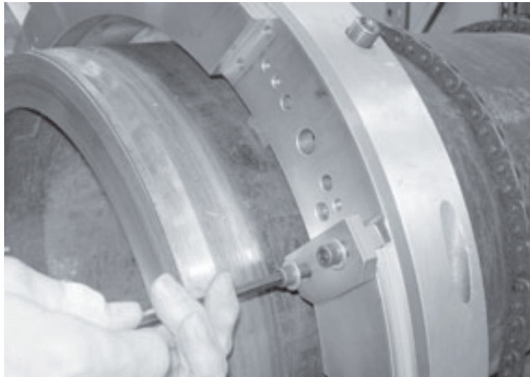
Figura 3-5. Installare le ganasce di fissaggio sull'anello rotante dell'LCSF nelle posizioni di montaggio della slitta.
